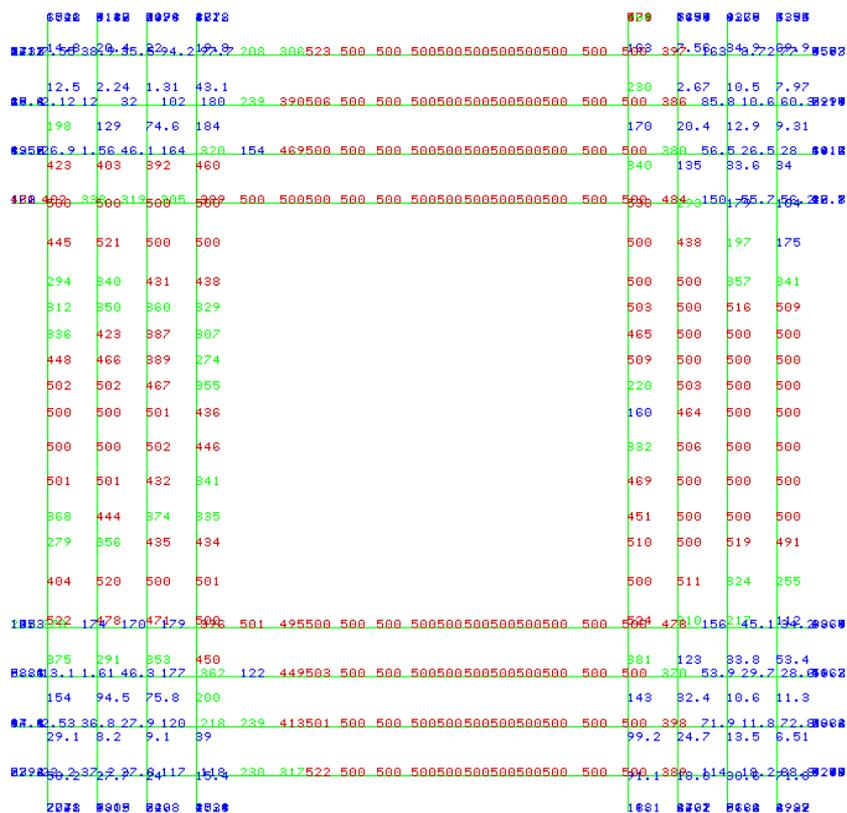
Figura 4.51 – Tensões nas barras da armadura principal do modelo IR-E48-HS30-NMM
