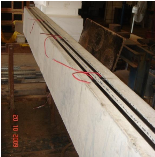
a) posicionamento do laminado ao lado do entalhe para marcação do comprimento de ancoragem
