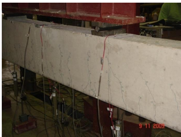
a) aspecto da distribuição das fissuras na viga do grupo B
