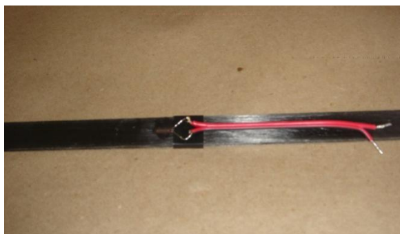
a) extensômetro fixado no laminado
