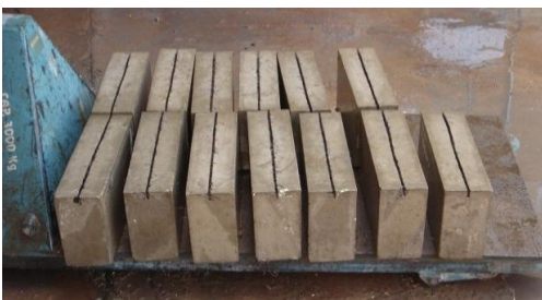
b) blocos entalhados e lavados
