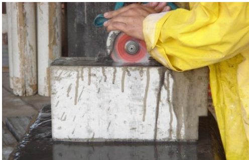
a) execução dos entalhes com discos de corte e via úmida
