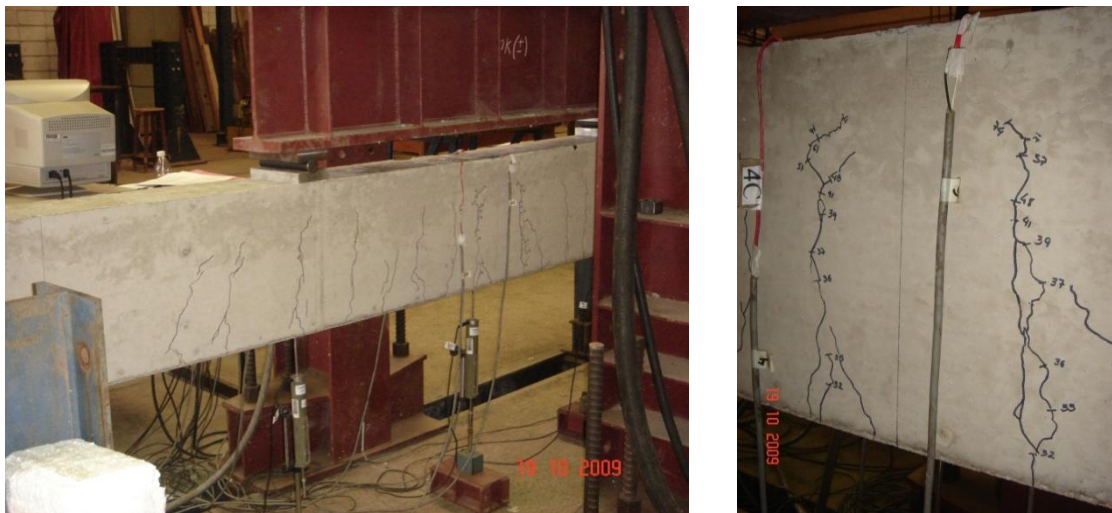
a) aspecto da distribuição das fissuras
