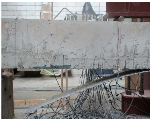
Figura 1.6 – Detalhe de ruína de viga reforçada com aderência externa de manta (Adaptado de FERRRI, 2007, p.245)
