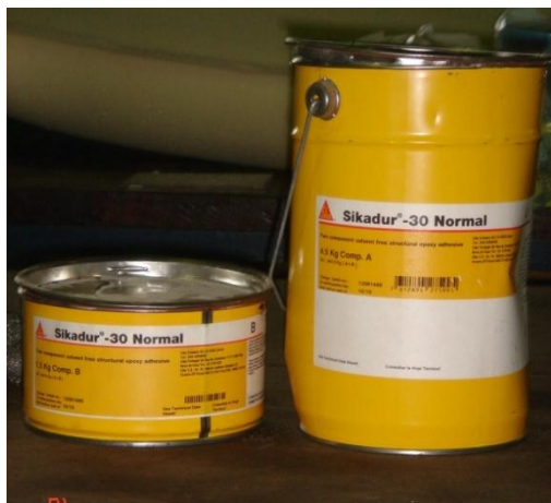
a) componentes A e B da resina
