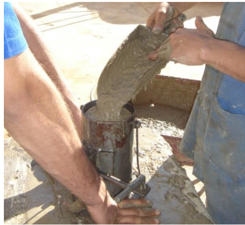
d) moldagem dos corpos de prova cilíndricos
