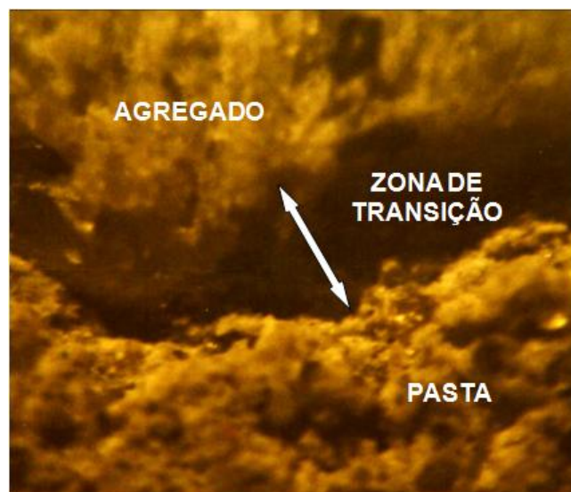
Figura 2.10- Visão microscópica do concreto (Adaptado de GRIGOLI; HELENE, 2001, p.11)
