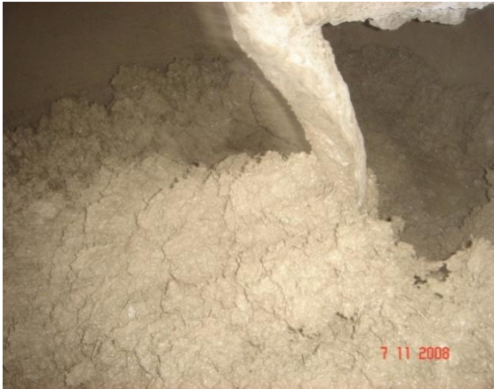
a) aspecto do concreto antes do uso de superplastificante
