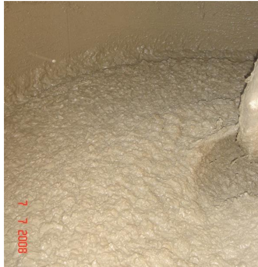
b) aspecto do concreto após a adição de superplastificante
