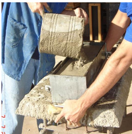
e) moldagem das vigas
