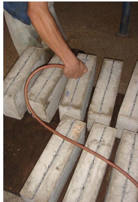
c) limpeza dos blocos com jato de ar comprimido
