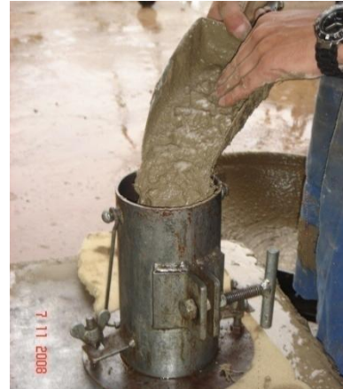
d) moldagem dos corpos de prova
