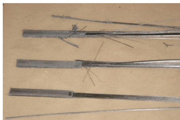
c) detalhe das abas íntegras após ensaios
