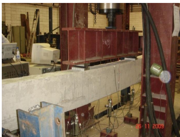
e) aspecto da distribuição das fissuras na viga do grupo D
