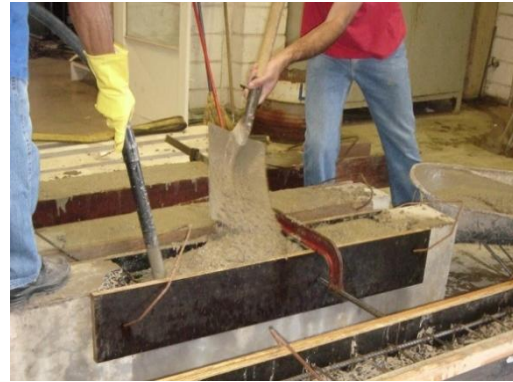
b) processo de reconstituição e vibração
