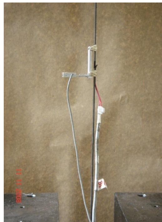
c) esquema do ensaio com extensômetro removível
