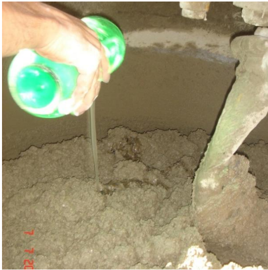
a) aspecto do concreto antes da adição de superplastificante
