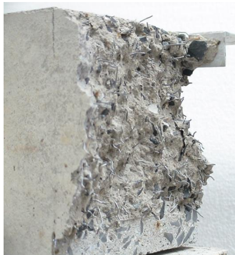
Figura 3.10 - Aspecto da distribuição aleatória das fibras
