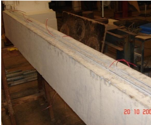
c) aspecto final da viga reforçada
