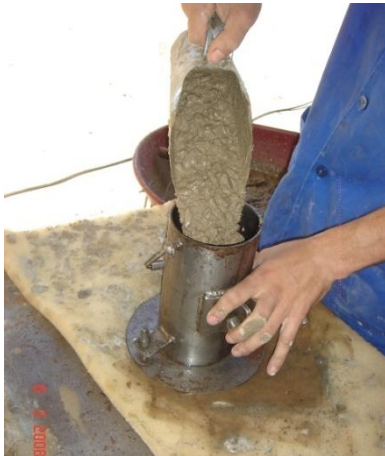
c) moldagem dos corpos de prova
