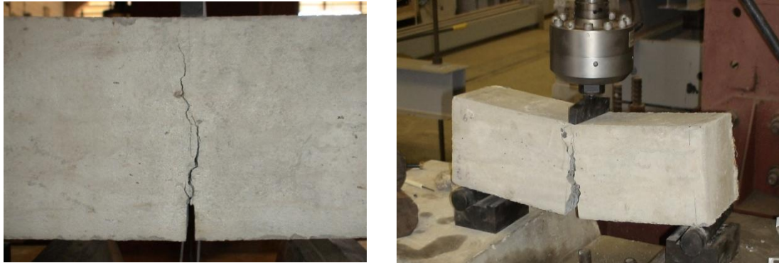
a) detalhe da abertura da fissura
