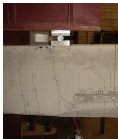
f) detalhe das fissuras do grupo D
