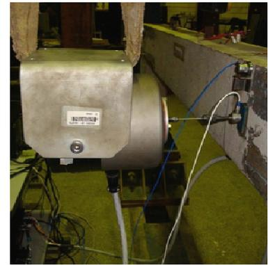
Figura 98 – Ensaios de vibração forçada – dir. z.
