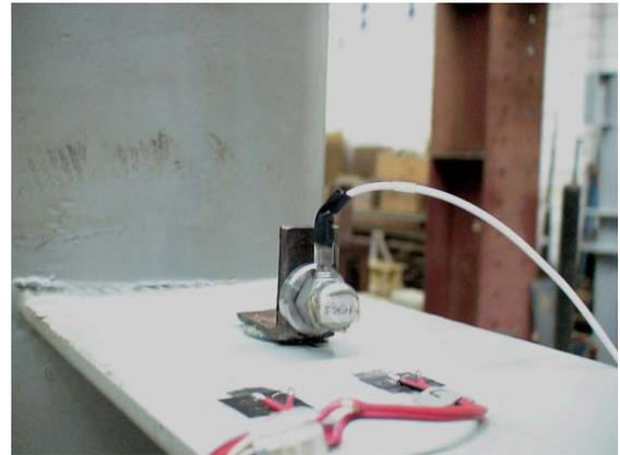
Figura 67 – Ensaio dinâmico – modelo soldado – Acelerômetro sobre a viga.
