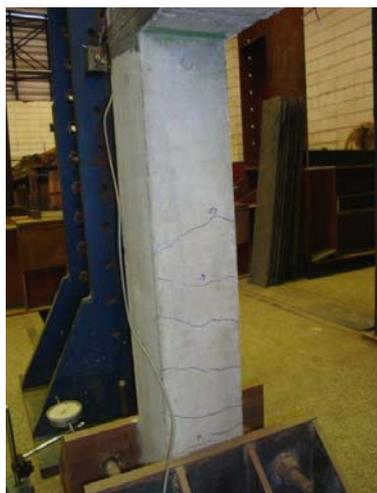
Figura 162 – Ensaio estático – 3ª etapa – Fissuração na base dos pilares – lado A.
