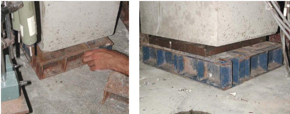
Figura 29 – Colocação de calços sob o pilar – Transição entre ensaio estático e dinâmico.
