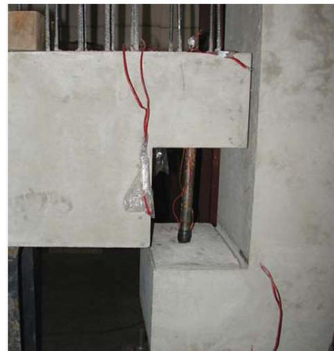
Figura 10 – Ligação viga-pilar estudada por Miotto (2002).
