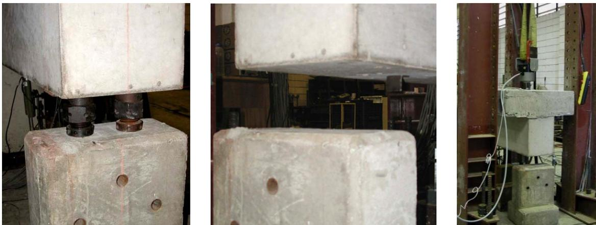
Figura 30 – Retirada dos apoios sob as vigas – Transição entre ensaio estático e dinâmico.
