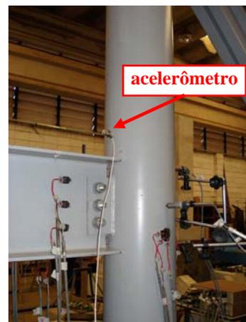
Figura 69 – Ensaio dinâmico – modelo parafusado – Acelerômetros.
