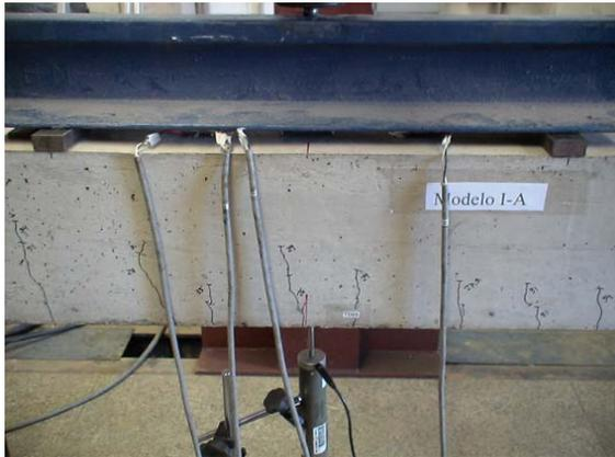
Figura 150 – Ensaio estático – 1ª etapa, sem reforço – Fissuração.
