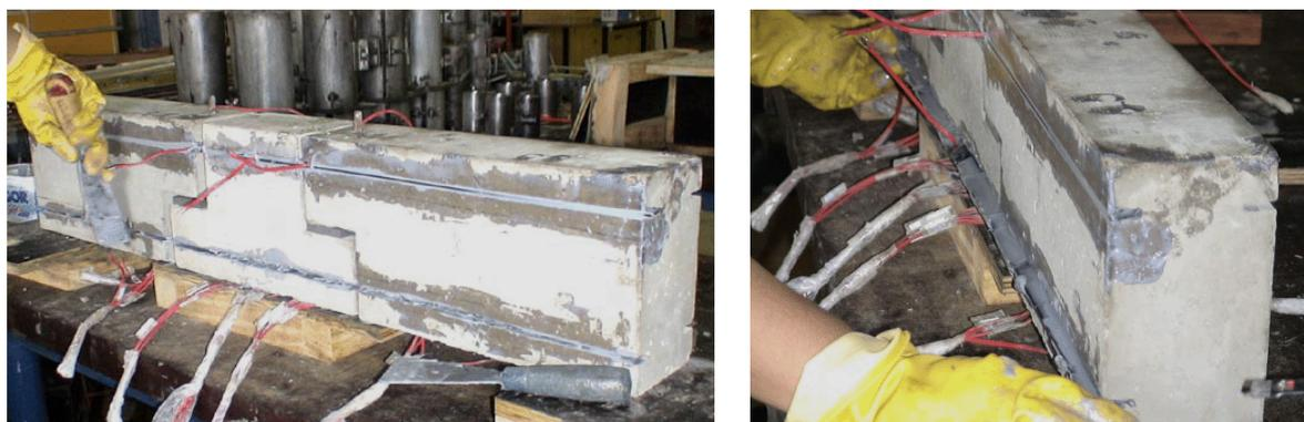
Figura 42 – Preparo da superfície, colocação da resina e inserção do laminado.
