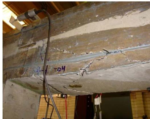
Figura 161 – Ensaio estático – 3ª etapa – Ruptura na região do reforço – lado B.
