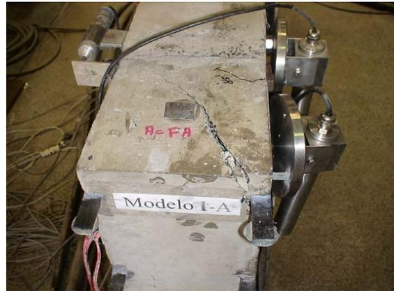
Figura 159 – Ensaio estático – 2ª etapa – Ruptura do pilar na região do reforço – lado A.
