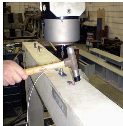
Figura 95 – Ensaio dinâmico de vibração forçada – direção vertical: a) *shaker*; b) acelerômetro e célula de força.
