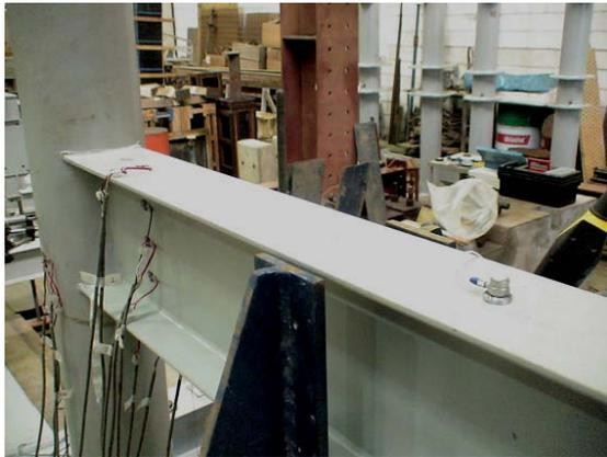
Figura 66 – Ensaio dinâmico – modelo soldado.
