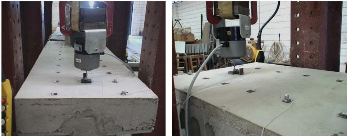
Figura 34 – Tentativa de obter os modos de vibração – Ensaio dinâmico.
