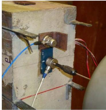
Figura 97 – Ensaios dinâmicos de vibração forçada- direção horizontal (x): a) shaker; b) acelerômetro e célula de força.
