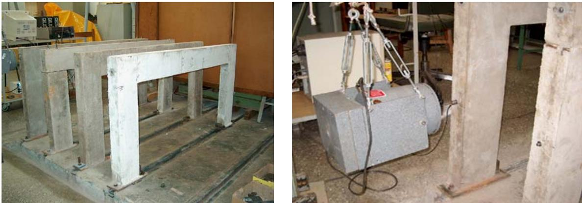
Figura 13 – Ensaio dinâmico experimental de pórticos de concreto (NÓBREGA, 2004): a) Diferentes pórticos na laje de reação; b) Pórtico submetido à ação de um excitador eletromagnético.
