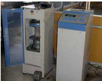
Figura 74 – Máquina de ensaio *ELE* utilizada para caracterização do concreto.
