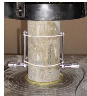
Figura 76 – Ensaio do módulo na máquina *Instron*.
