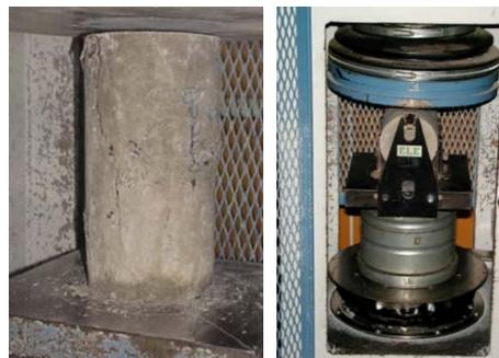
Figura 75 – Ensaio de resistência à compressão e à tração, realizados na máquina *ELE*.
