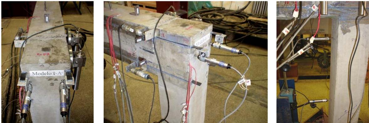
Figura 89 – Instrumentação utilizada – Transdutores de deslocamento: a e b) utilizados para medir os deslocamentos dos laminados em relação aos pilares; c) utilizados para medir a rotação do pórtico.
