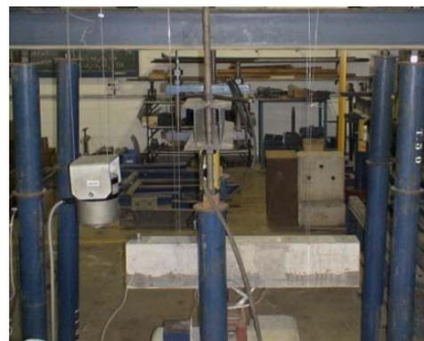
Figura 44 – Ensaios dinâmicos de vibração livre – condição de contorno livre-livre com modelo suspenso por fios de nylon.
