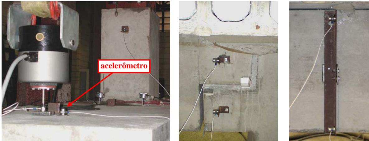
Figura 33 – Posicionamento dos acelerômetros no ensaio dinâmico: a) Acelerômetro fixado na laje; b) Acelerômetros posicionados no dente da viga e no consolo do pilar; c) Acelerômetros posicionados na viga.
