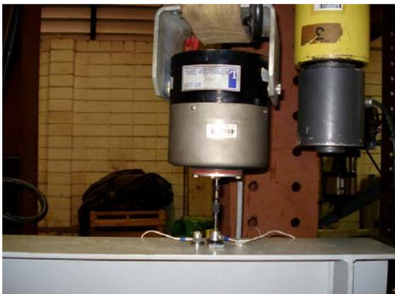
Figura 68 – Ensaio dinâmico – modelo soldado – Excitador e célula de força.
