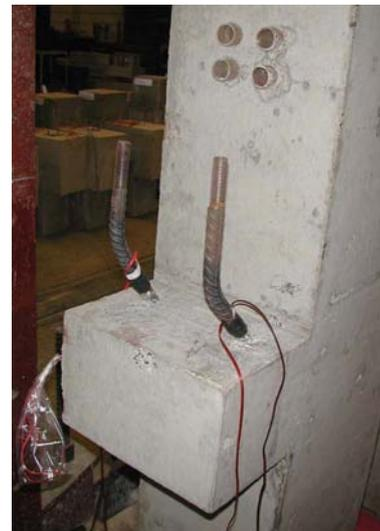
Figura 12 – Fotos da ligação viga-pilar estudada por Baldissera (2006).
