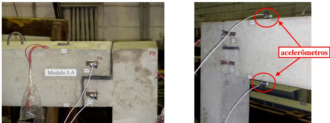
Figura 99 – Acelerômetros posicionados: a) no dente da viga e no consolo do pilar; b) na parte superior e na inferior da viga.
