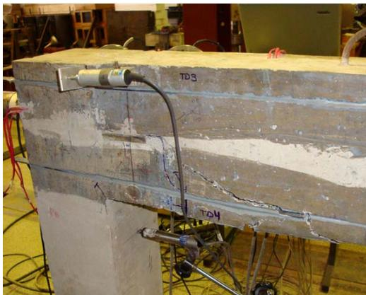
Figura 160 – Ensaio estático – 3ª etapa – Ruptura na região do reforço – lado B.
