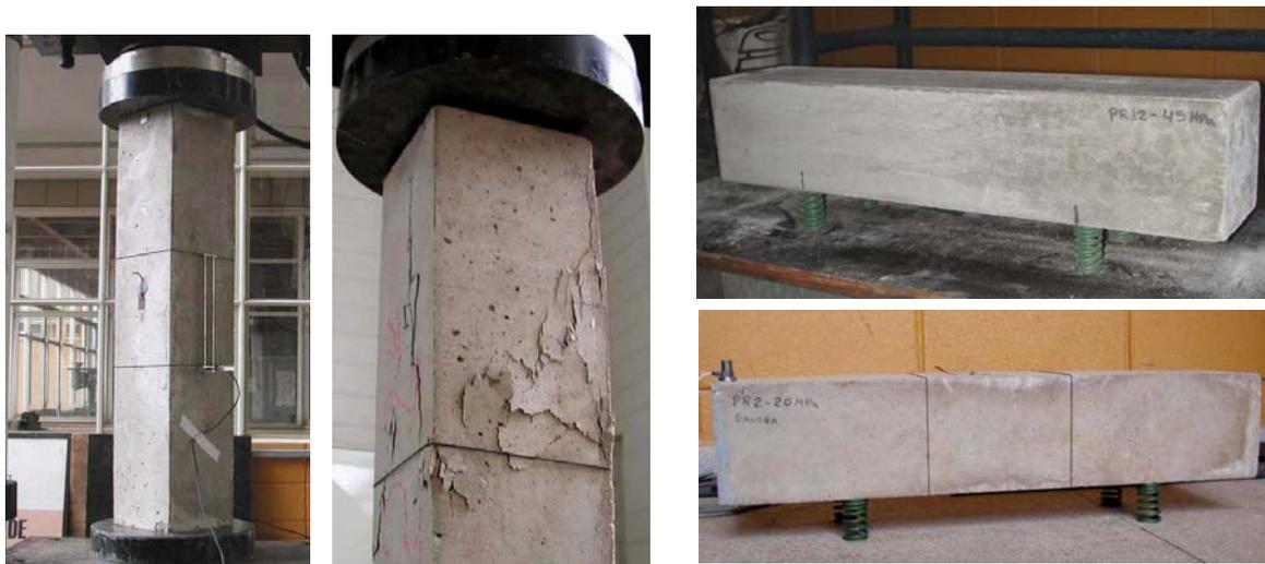
Figura 17 – Ensaios estáticos e dinâmicos em prismas de concreto simples (ALMEIDA, 2005): a) Aplicação do carregamento estático – fissuração; b) Ensaio dinâmico com prismas sobre molas – condição livre-livre.
