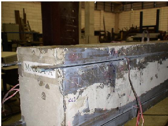
Figura 158 – Ensaio estático – 2ª etapa – Ruptura do pilar na região do reforço – lado A.
