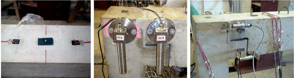
Figura 88 – Instrumentação utilizada: a) extensômetros elétricos no concreto da face superior da viga; b) clinômetros e c) transdutores de deslocamento.
