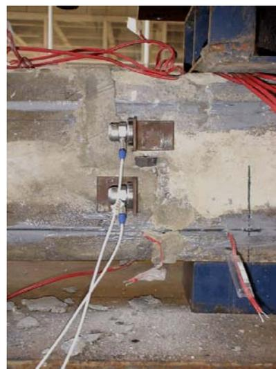
Figura 49 – Acelerômetros posicionados
