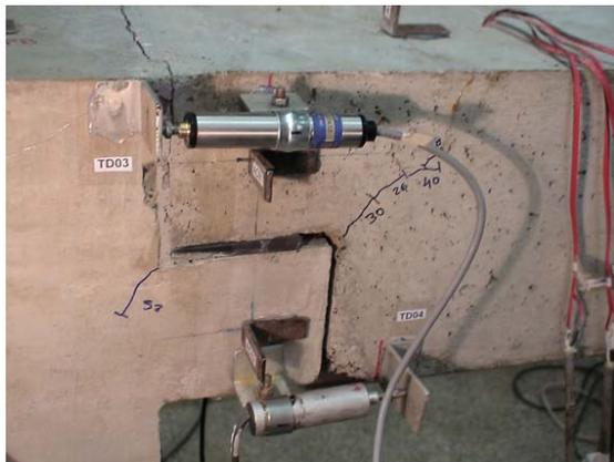
Figura 152 – Ensaio estático – 1ª etapa, sem reforço – Fissuração – lado B.
