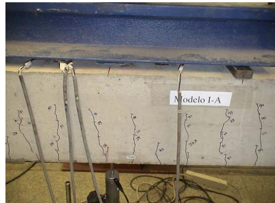
Figura 153 – Ensaio estático – 1ª etapa, sem reforço – Fissuração.
