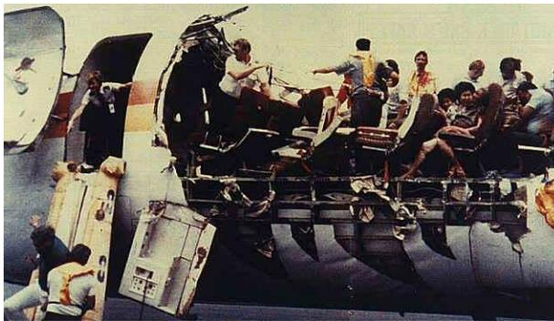
Figura 2.5: Boeing 737 com ruptura na fuselagem
