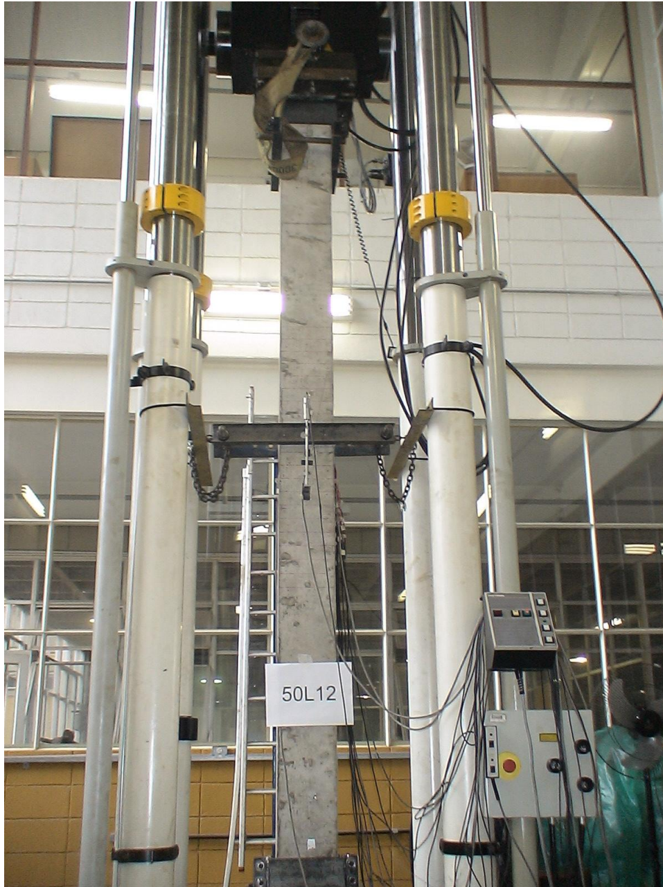
Fig. 5.20 – Detalhe do pilar esbelto antes do ensaio.
