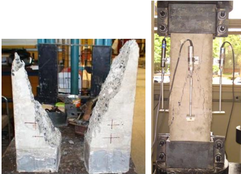
Fig. 6.8 – Forma da ruptura dos prismas de CAR e de concreto convencional, sem armadura.
