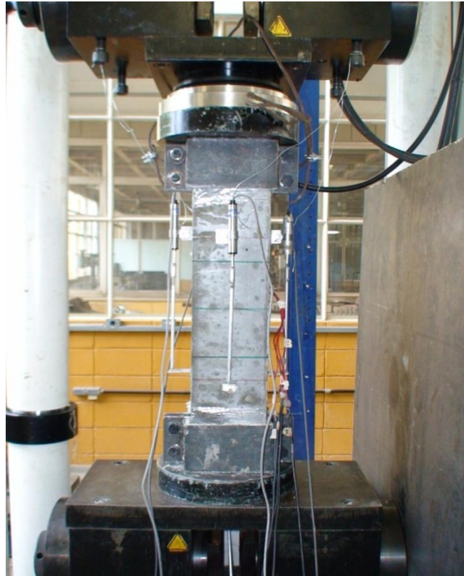
Fig. 5.15 – Detalhe do pilar curto antes do ensaio.
