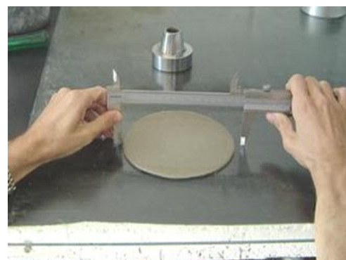
(d) medição dos diâmetros após espalhamento para cálculo da área de espalhamento
