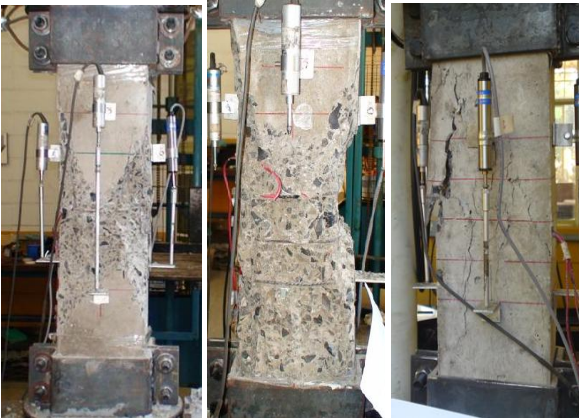
Fig. 6.9 – Pilares curtos 100M, 50H e 50L após o ensaio.
