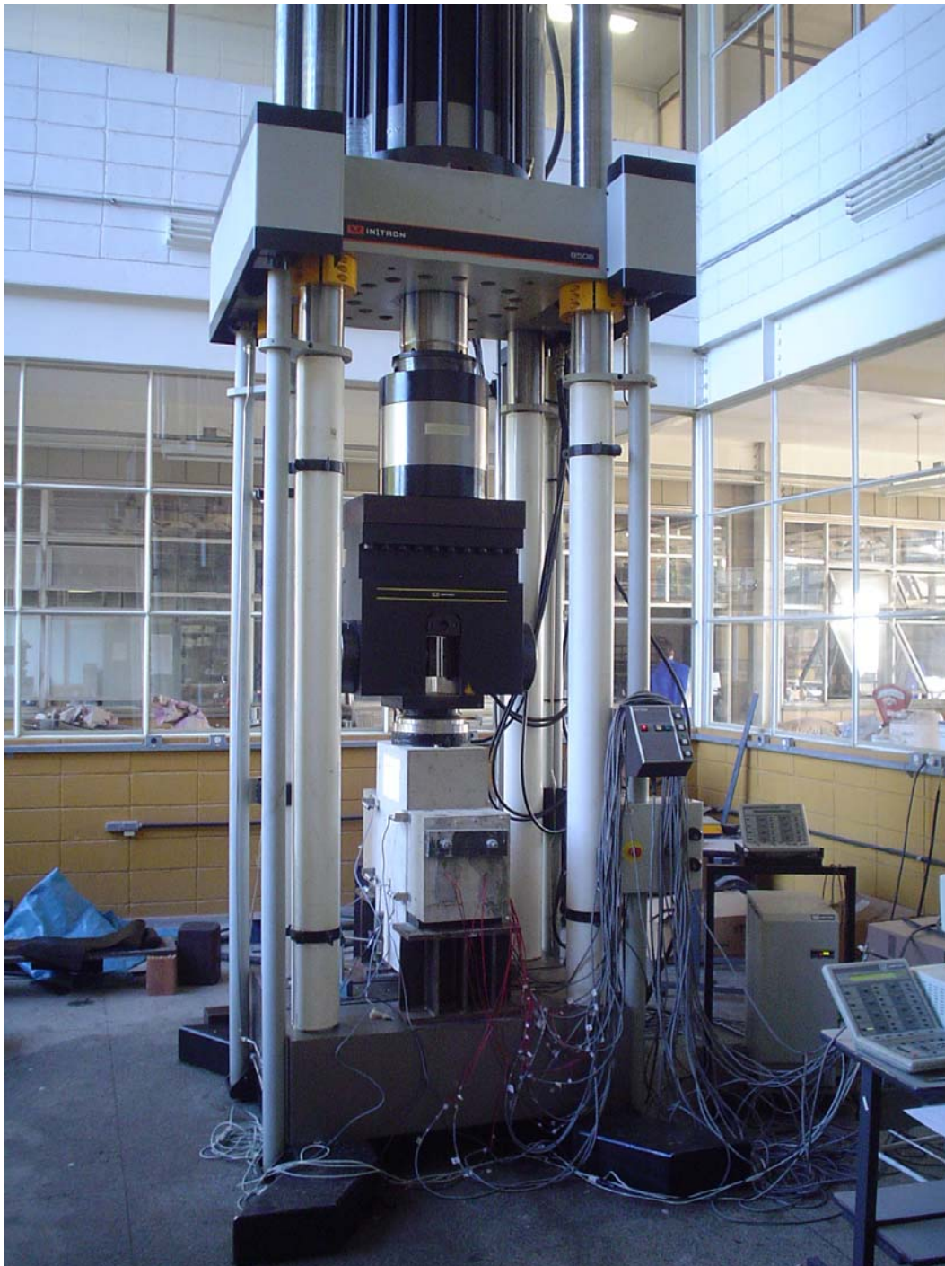
Figura 3.34: esquema de ensaio na máquina INSTRON 8506
