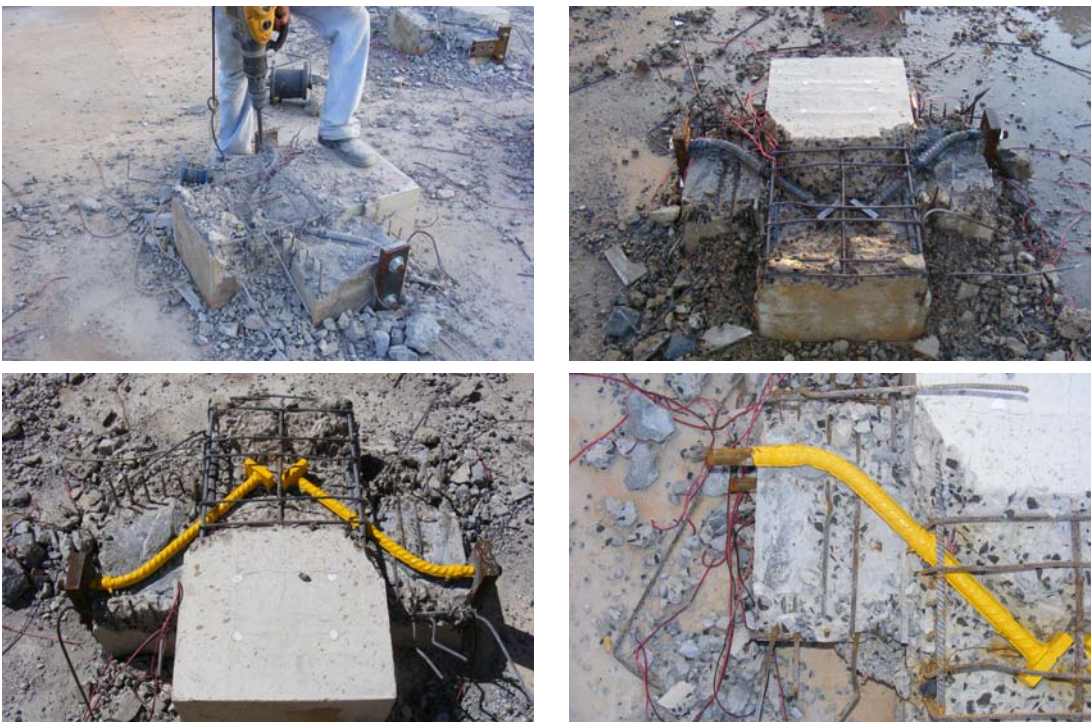
Figura 4.22: Visualização do chumbador do modelo 06 após a ruptura.
