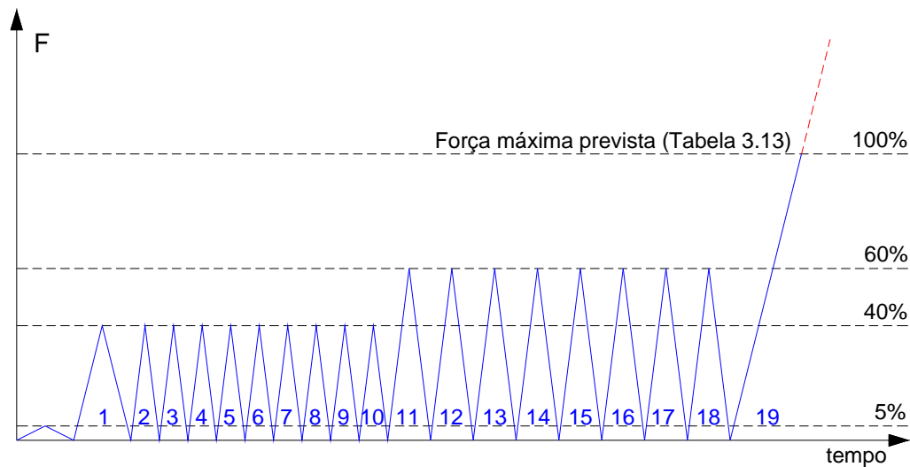
Figura 3.38: Ciclos de carregamento e descarregamento aplicados nos modelos.
