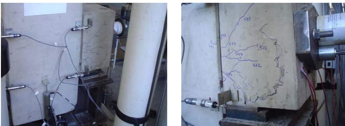
Figura 4.25: Aspecto da fissuração do bloco externo do modelo 07
