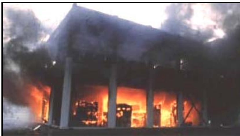
Figura 2.17 - Teste de resistência ao fogo executado pela BHP na Austrália. Fonte: http://members.fortunecity.com/911/fire/SCI.htm
