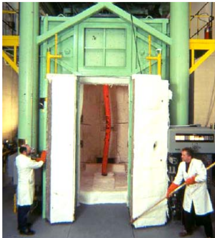
Figura 2.19 - Deformação no pilar misto preenchido logo após o ensaio em um forno.
