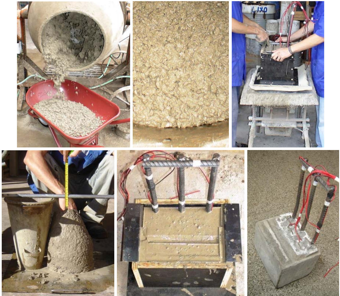
Figura 3.35 - Detalhes da concretagem dos consolos.
