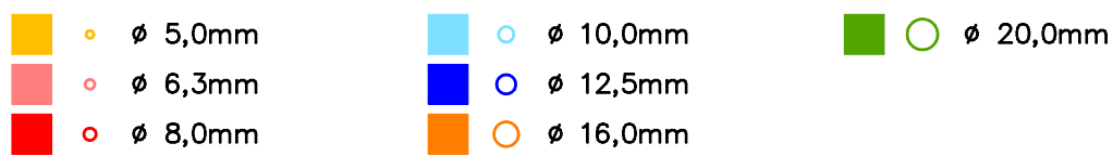
Figura 3.3 - Código de cores das bitolas das armaduras.
