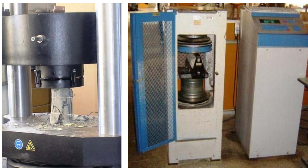
Figura 3.41 - Ensaio dos corpos-de-prova cilíndricos de concreto.
