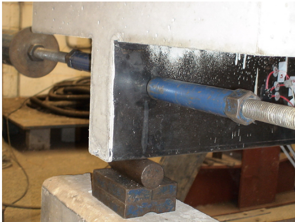
a) Apoio e contenção lateral.
