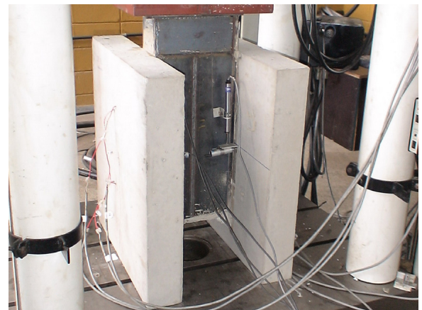
Figura 23: Esquema geral de ensaio Push-out.
