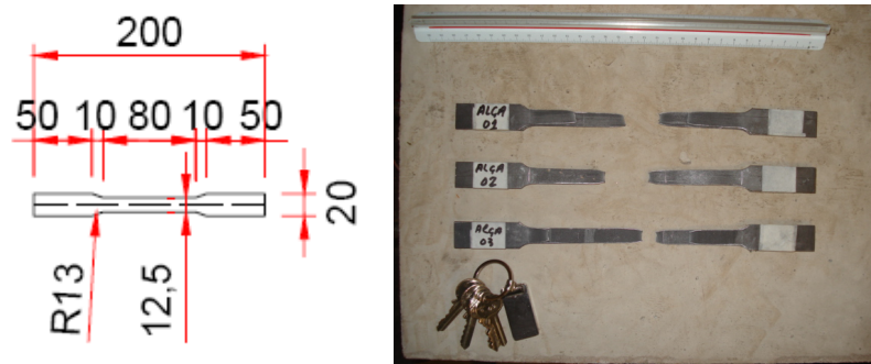
Figura 32: Corpos-de-prova extraídos para caracterização.
