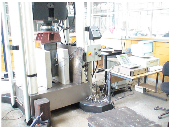
Figura 23: Esquema geral de ensaio Push-out.
