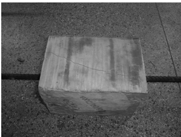
Ruptura por fendilhamento
