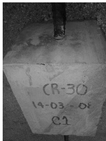
Ruptura por deslizamento da barra Vista superior
