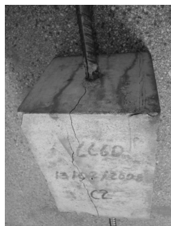
Vista de frente de ruptura
