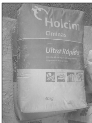
Figura 3.6 Cimento Portland de Alta Resistência Inicial (Címinas CP V ARI FÁCIL)
