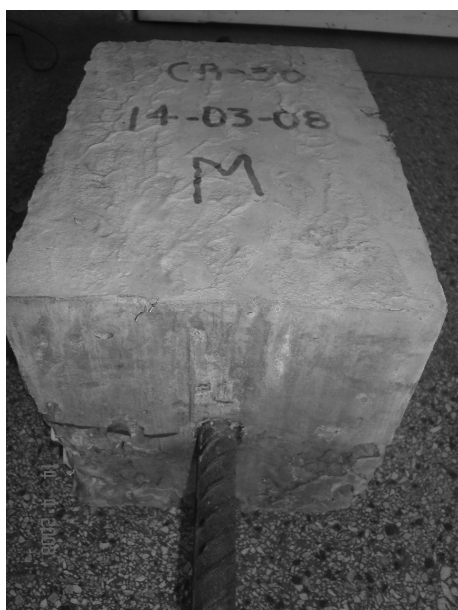
Ruptura por fendilhamento Vista inferior
