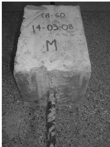
Ruptura por deslizamento da barra Vista inferior
