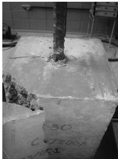
Ruptura por deslizamento da barra
