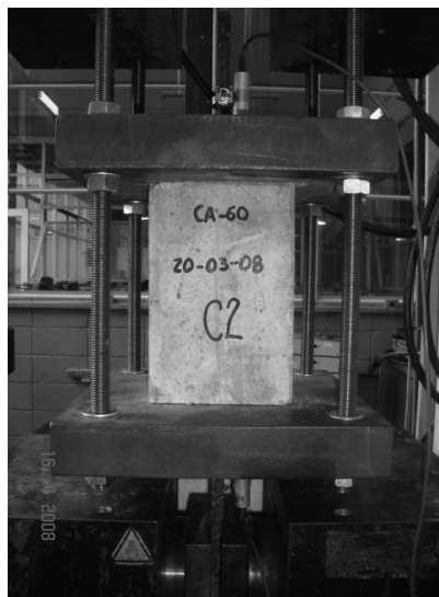
Ruptura por deslizamento da barra
