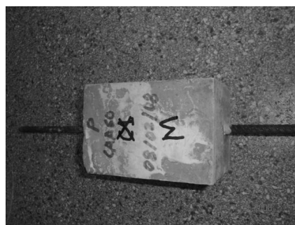
Ruptura por deslizamento da barra
