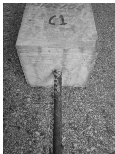
Ruptura por fendilhamento Vista inferior
