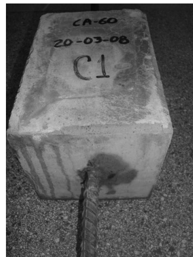
Ruptura por arrancamento por deslizamento da barra
