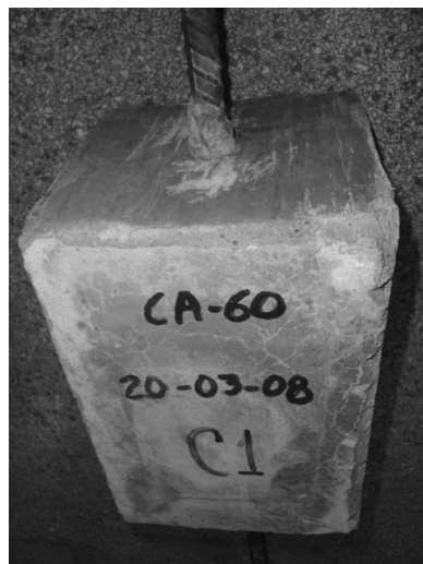
Ruptura por arrancamento por deslizamento da barra
