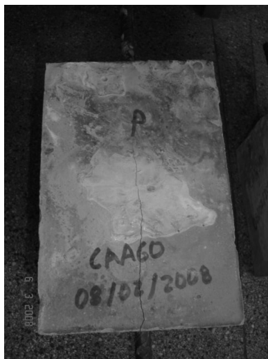
Ruptura por fendilhamento
