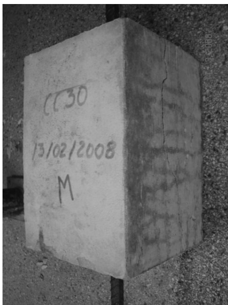
Ruptura por deslizamento da barra
