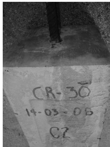
Ruptura por deslizamento da barra Vista superior
