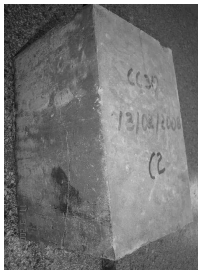
Ruptura por fendilhamento
