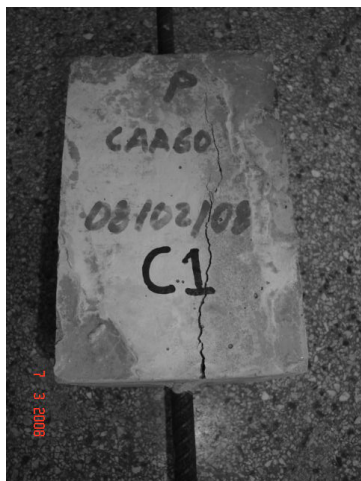
Ruptura do concreto por flambagem da barra
