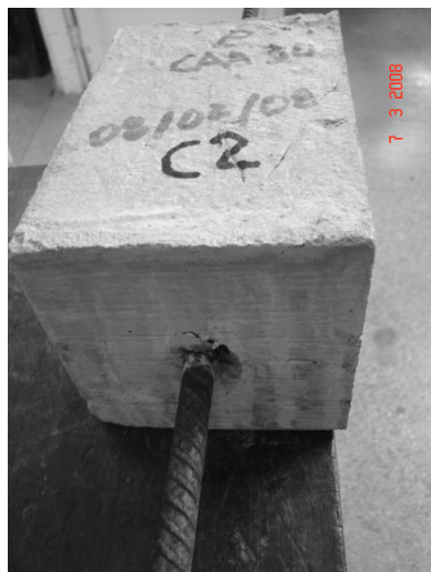
Ruptura por deslizamento da barra
