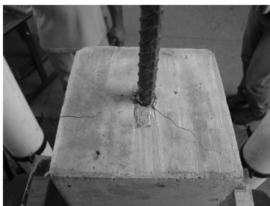
Ruptura por fendilhamento
