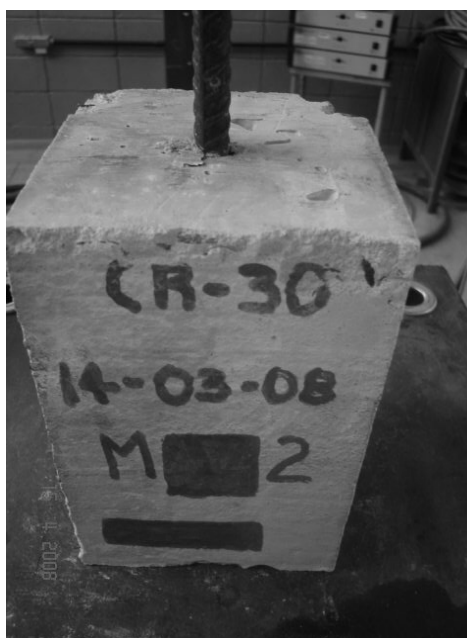
Ruptura por deslizamento da barra
