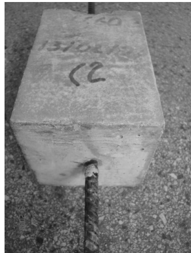
Ruptura por fendilhamento Vista inferior
