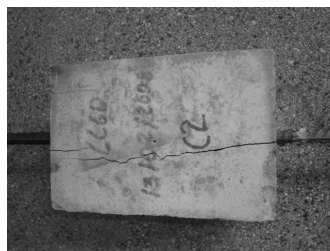
Ruptura por fendilhamento
