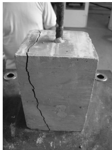
Ruptura a do concreto por flambagem da barra
