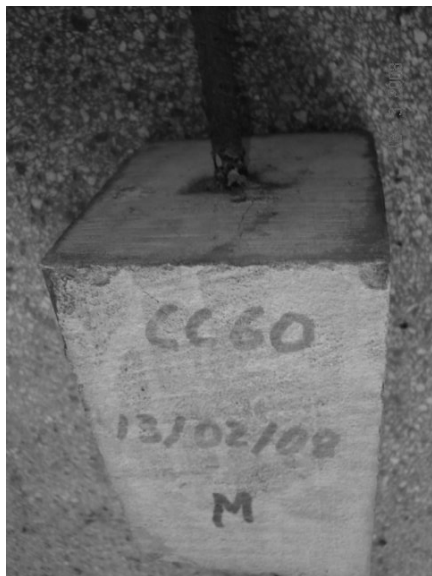
Ruptura por fendilhamento Vista superior
