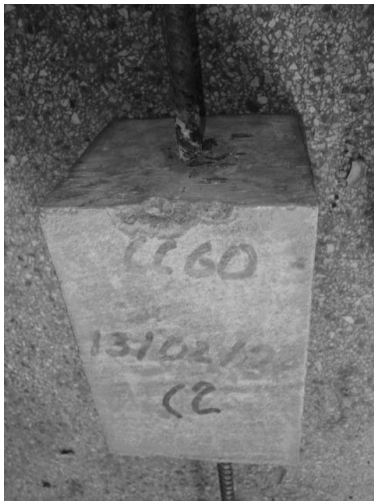
Ruptura por fendilhamento Vista superior
