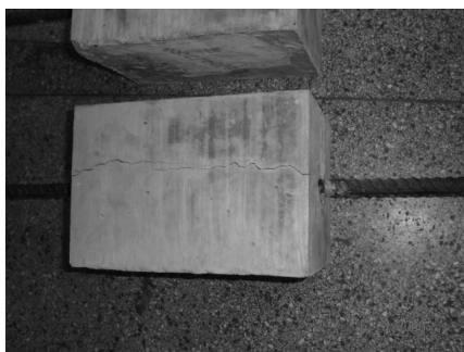
Ruptura por fendilhamento
