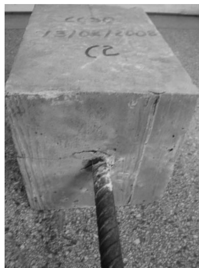
Ruptura por deslizamento da barra
