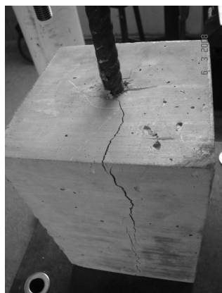
Vista superior de ruptura
