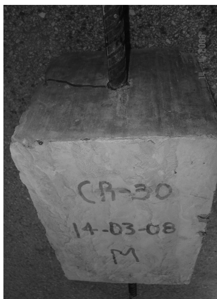
Ruptura por fendilhamento Vista superior
