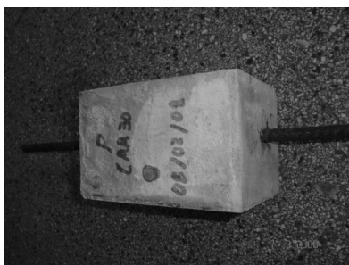
Ruptura por deslizamento da barra
