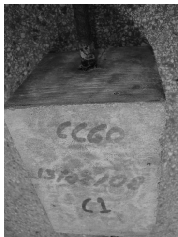
Ruptura por fendilhamento Vista superior
