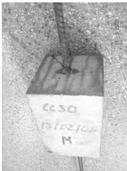
Ruptura do concreto por fendilhamento na barra Vista superior
