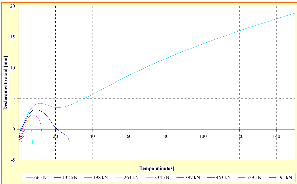
Figura 7.78: Deslocamento axial do pilar submetido a um campo térmico e imperfeição geométrica no sentido z-negativo para os nove níveis de força aplicados.
