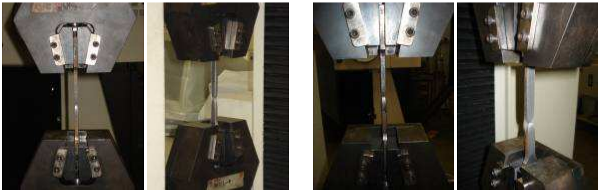
(b) Escoamento da seção transversal.
