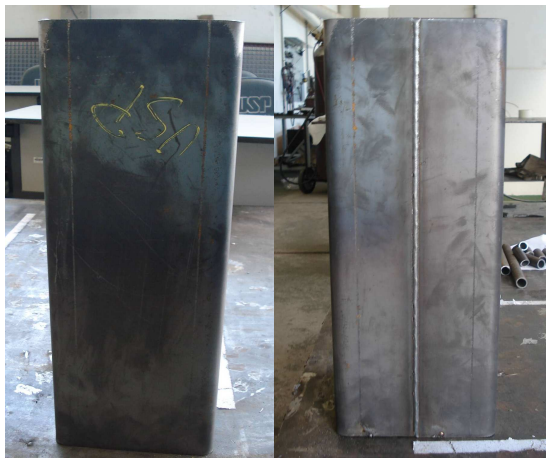
(a) Vista do pilar metálico. Região sem e com solda .
