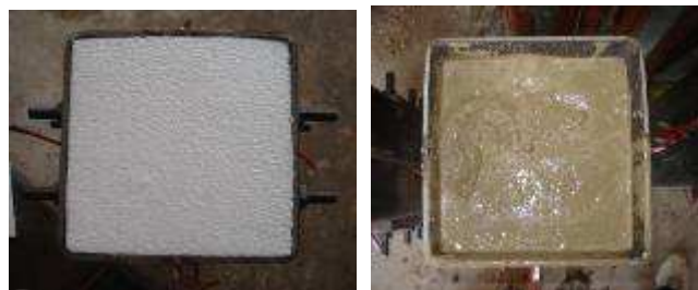
Figura 3.38. Folga nas extremidades do pilar preenchido.
