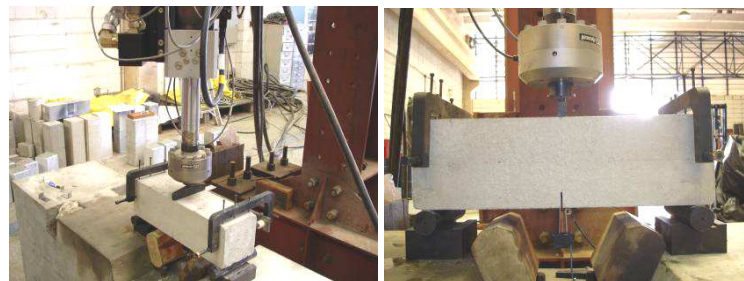
Figura 3.20. Ensaio de energia de fraturamento
