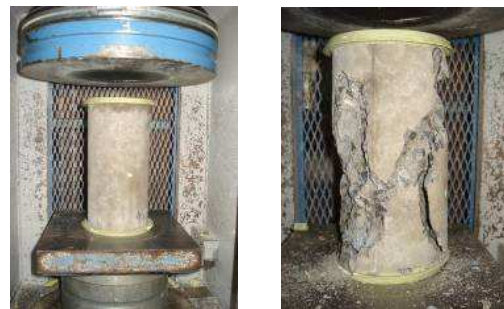
Figura 3.17. Ensaio de resistência à compressão axial.
