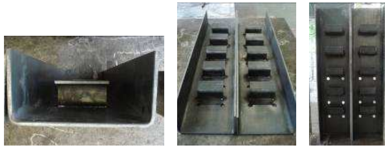
Figura 3.29. Confeção dos perfis com conector de cisalhamento tipo cantoneira.
