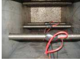
Figura 3.10. Instrumentação das barras rosqueadas.
