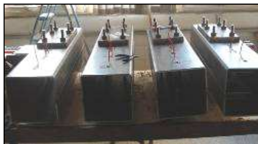
Figura 3.33. Confeccção da instrumentação do perfil de aço.
