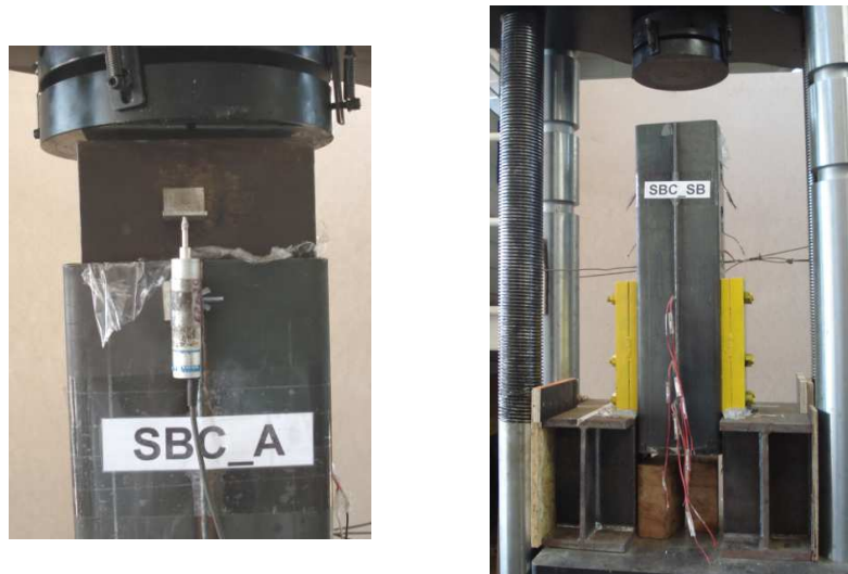
Figura 3.42. Aplicação do carregamento no núcleo de concreto.
