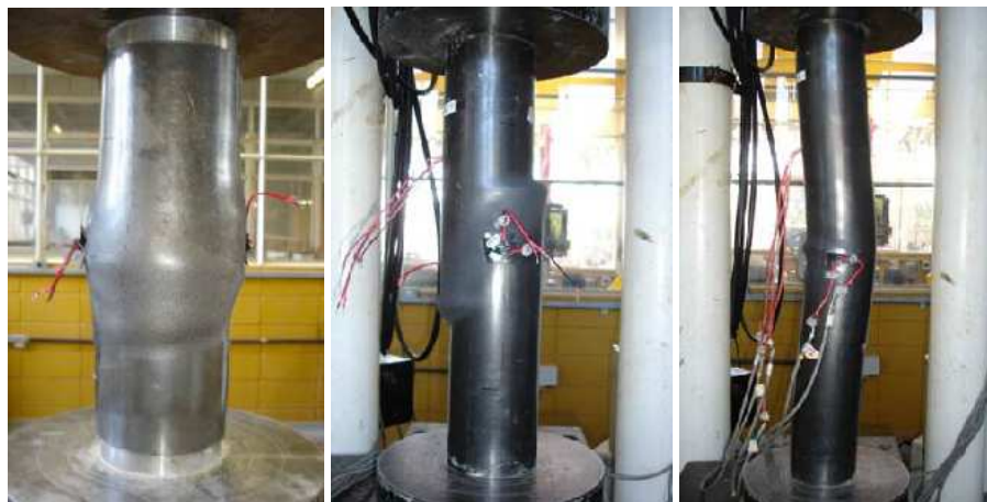
Figura 2.13. Modos de ruptura nos pilares mistos preenchidos estudados por Oliveira (2008).
