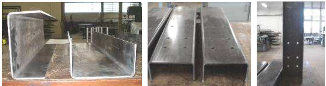
Figura 3.28. Perfis de aço "U" antes e depois da confecção dos furos.
