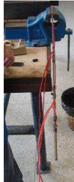
(d) Instrumentação da barra de aço concluída.
