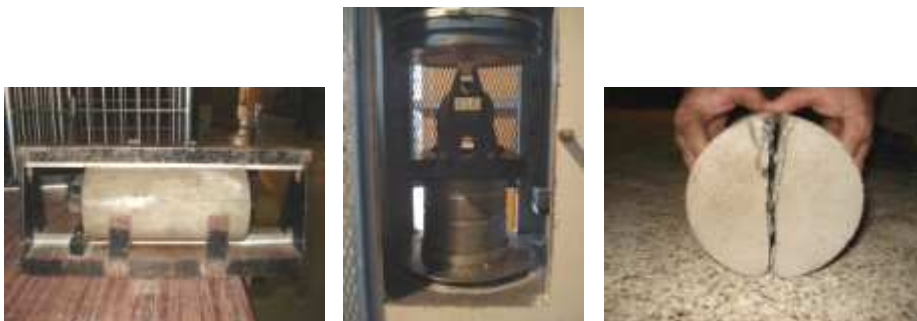
Figura 3.18. Ensaio de resistência à tração por compressão diametral.
