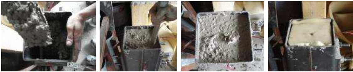
Figura 3.37. Concretagem, adensamento e cura.
