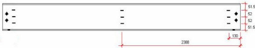
Figura 3.28 – Posicionamento dos extensômetros na alma ao longo das vigas principais
