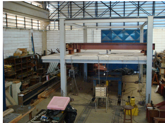
Figura 3.23– Pontos de passagem da cordoalha pela laje e pontos de aplicação do carregamento concentrado a um quarto e no centro do maior vão da laje.
