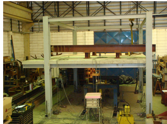
Figura 3.19 – Esquema e vista dos pontos de passagem da cordoalha pela laje e pontos de aplicação do carregamento concentrado posicionados na direção dos quartos das vigas principais.
