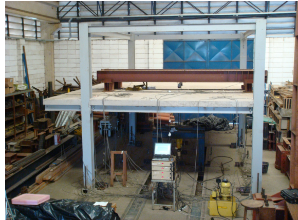
Figura 3.24– Pontos de passagem da cordoalha pela laje e pontos de aplicação do carregamento concentrado próximos ao centro do maior vão da laje.
