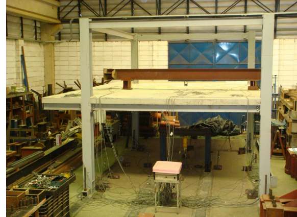
Figura 3.18 – Esquema e vista dos pontos de passagem da cordoalha pela laje e dos pontos de aplicação do carregamento concentrado no centro das vigas principais.
