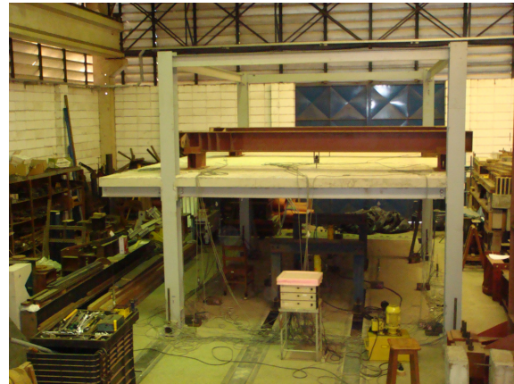
Figura 3.22 – Pontos de passagem da cordoalha pela laje e pontos de aplicação do carregamento concentrado a um quarto e três quartos do maior vão da laje.
