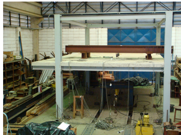
Figura 3.25– Pontos de passagem da cordoalha pela laje e pontos de aplicação do carregamento concentrado próximos ao centro do maior vão da laje a 50 cm da linha de centro das vigas principais.
