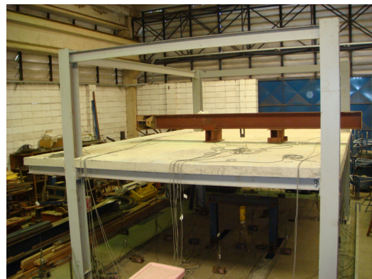
Figura 3.17 – Esquema e vista dos pontos de passagem da cordoalha pela laje e dos pontos de aplicação do carregamento concentrado nos terços do menor vão.
