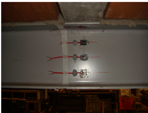
Figura 3.32 – Vista da instrumentação das vigas e armaduras
