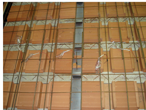
Figura 3.32 – Vista da instrumentação das vigas e armaduras
