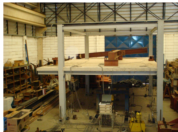
Figura 3.20 – Pontos de passagem da cordoalha pela laje e pontos de aplicação do carregamento concentrado na direção do centro das vigas secundárias.
