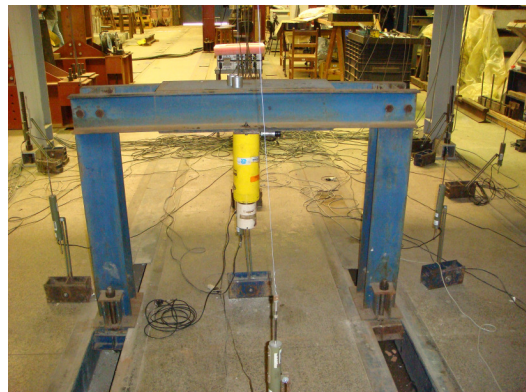
Figura 3.26 – Esquema e vista do pórtico de reação
