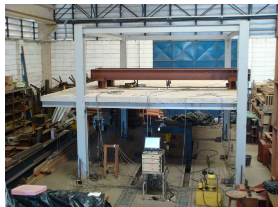
Figura 4.52 – Esquema de carregamento e vista da estrutura - 8ª etapa de carregamento concentrado
