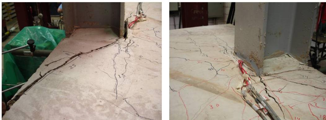
Figura 5.5: Fissuração da laje ao término do ensaio.
