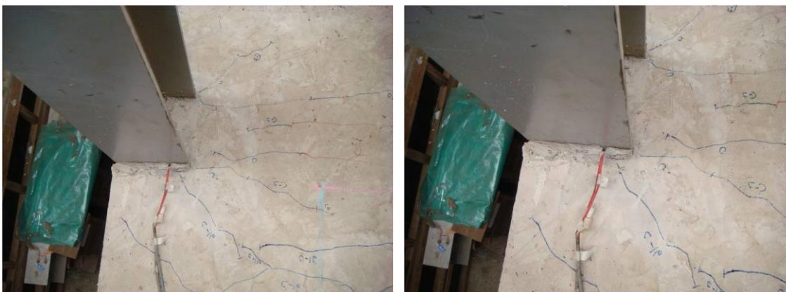
Figura 5.46: Fissuração da laje de concreto na ligação [4] após o ensaio.
