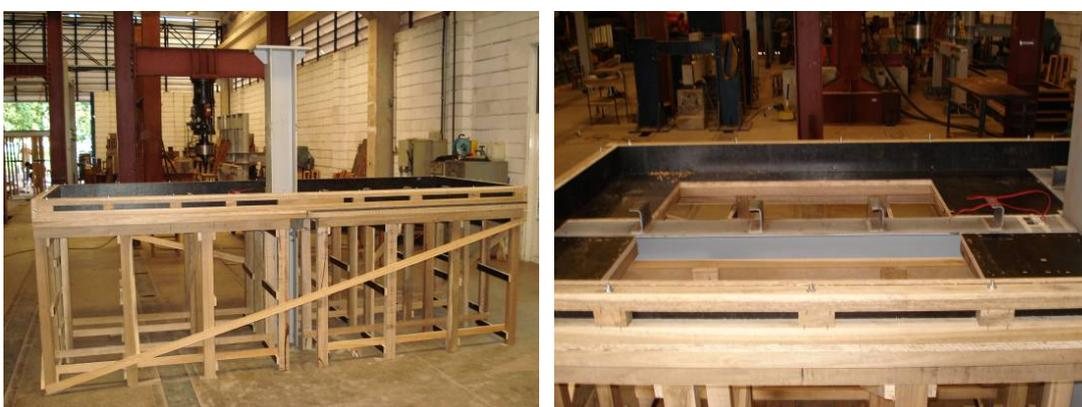
Figura 4.8: Montagem das formas no modelo cruciforme.
