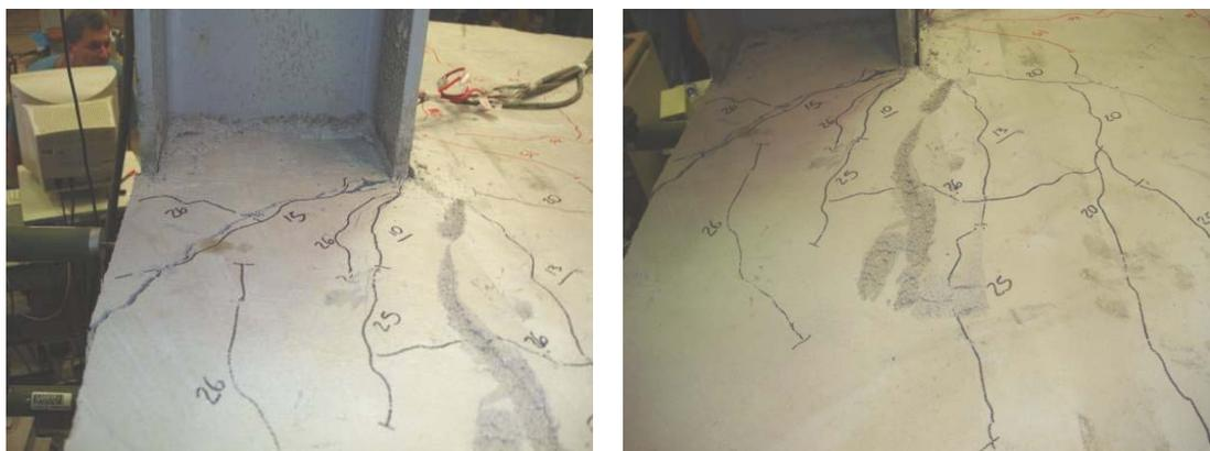
Figura 5.10: Fissuração da laje ao final do ensaio.
