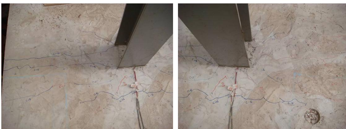
Figura 5.41: Fissuração da laje de concreto na Lig. [3] após o ensaio.
