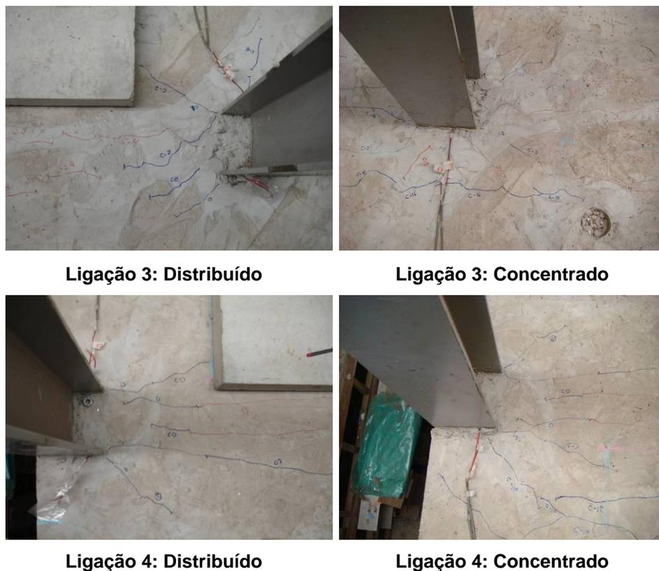
Figura 7.24: Fissuração da laje nas ligações do pavimento tipo ao término das etapas de carregamento distribuído e concentrado.
