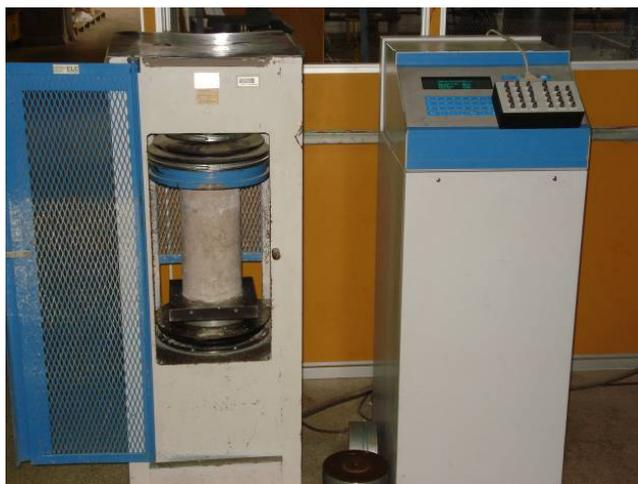
Figura 4.41: Ensaio de caracterização dos corpos de prova de concreto.
