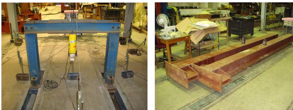
Figura 4.32: Pórtico de reação sob a laje do pavimento tipo e perfis de elevada rigidez para aplicação do carregamento concentrado.
