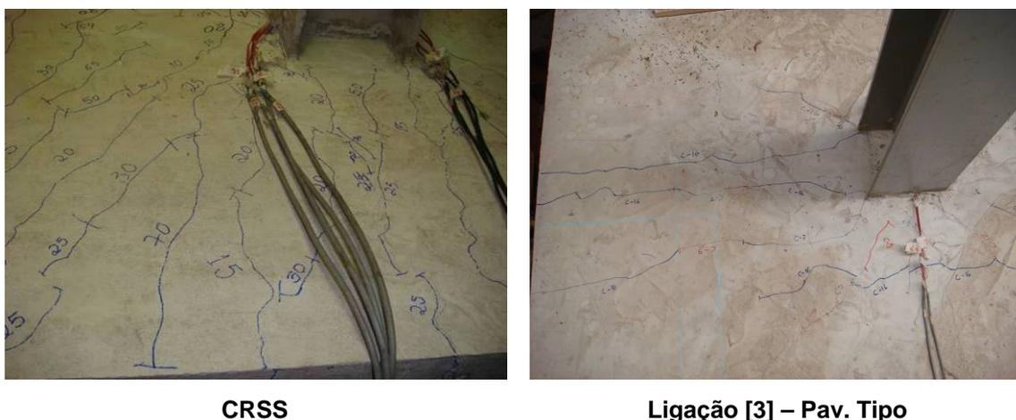
Figura 7.12: Fissuração na laje ao término do ensaio para o protótipo isolado CRSS e na Ligação [3] do pavimento tipo.
