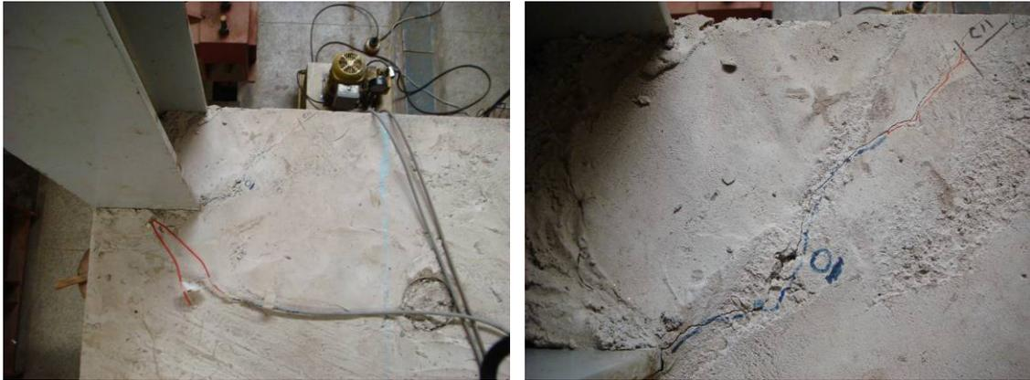
Figura 5.36: Fissuração da laje de concreto na Lig [2] após o ensaio.
