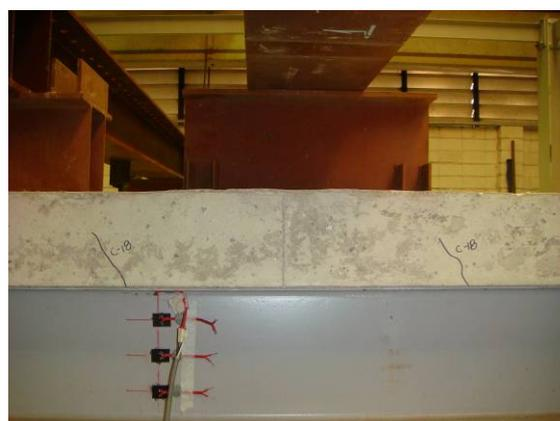
Fissuração na espessura da laje
