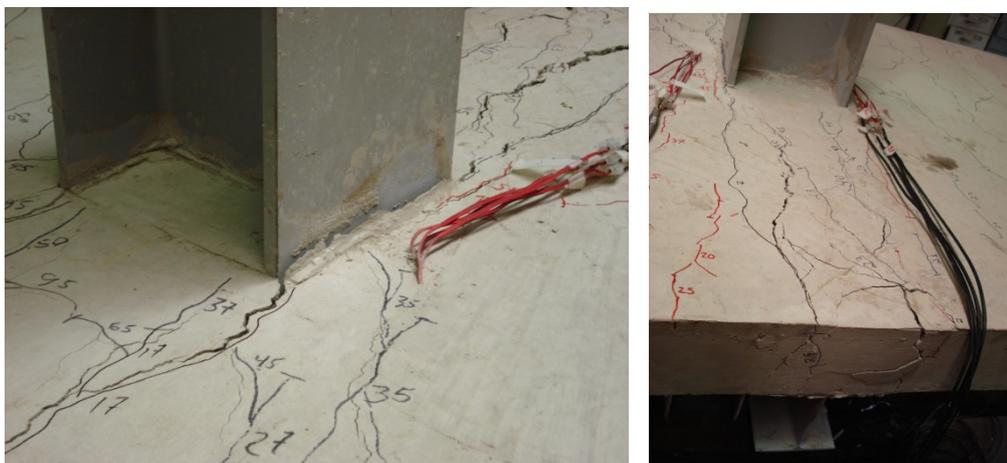
Figura 5.17: Fissuração da laje ao término do ensaio do protótipo CNRSS.
