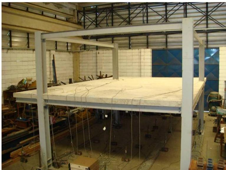
Figura 4.40: Transdutores posicionados sob a laje o pavimento tipo antes da primeira etapa de carregamento distribuído.
