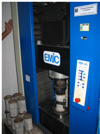
Figura 5.22 – Ensaio de determinação do módulo de elasticidade
