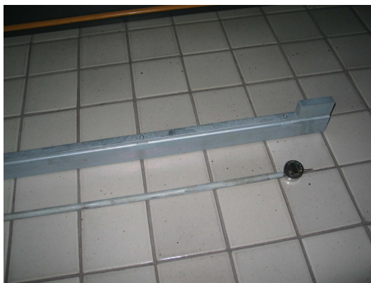
Figura 4.9 – Barra de referência padrão e extensômetro removível
