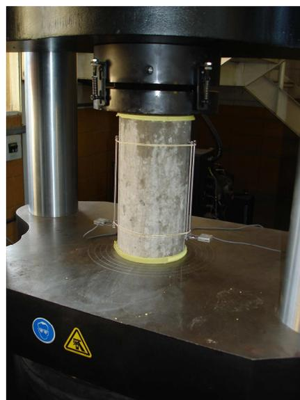
**Figura 3.10** – Corpo-de-prova com *clip-gages* instalados
