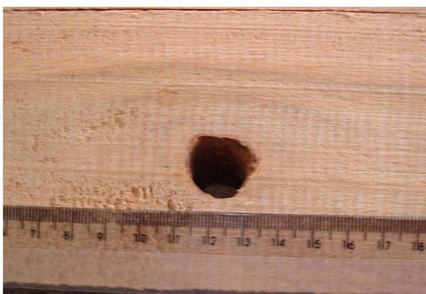
**Figura 3.1** – Configuração típica dos nós
