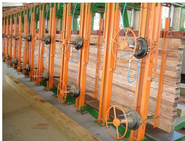
**Figura 5.2** – Prensagem das vigas de MLC
