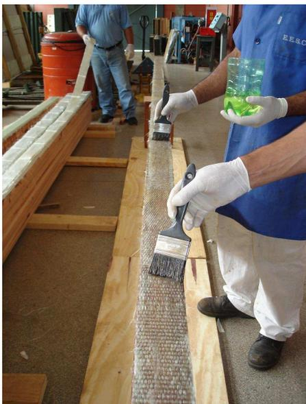
**Figura 5.8** – Aplicação do adesivo epóxi
