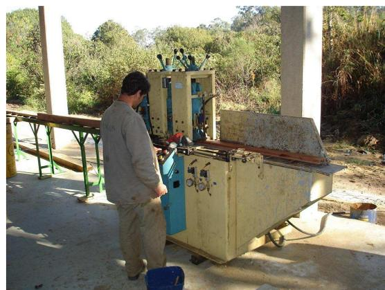
**Figura 3.6** – Colagem das emendas dentadas
