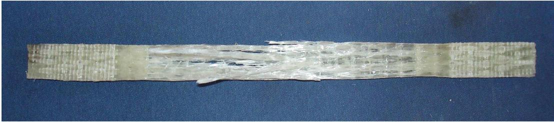
**Figura 3.17** – Detalhe típico de ruptura dos corpos-de-prova
