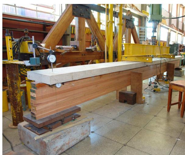
**Figura 5.30** – Relógios comparadores posicionados no eixo do apoio
