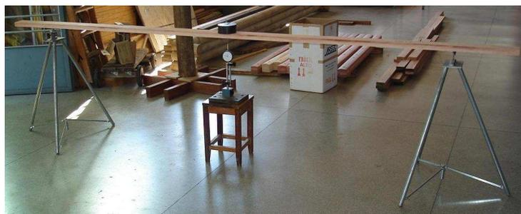
**Figura 3.4** – Ensaio por flexão estática
