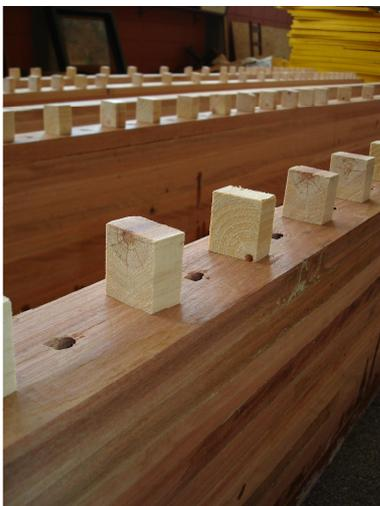
**Figura 5.21** – Suportes auxiliares na fixação dos ganchos metálicos
