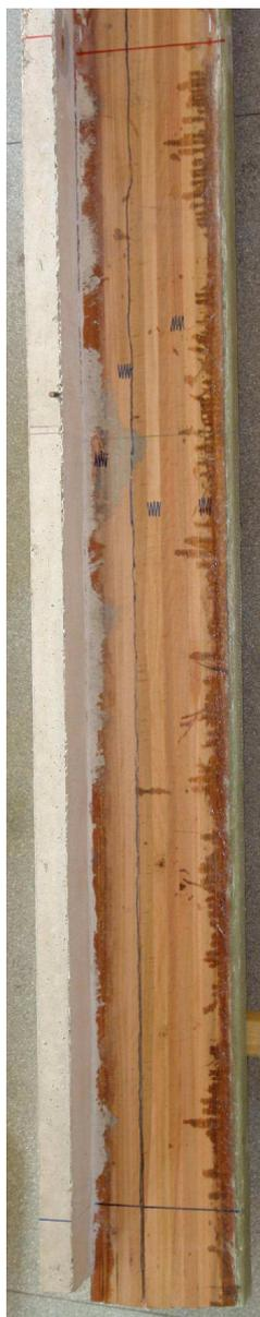
**Figura G.7(a)** – Ruptura da viga V4: lado esquerdo
