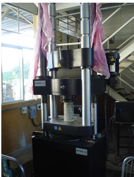
**Figura 3.9** – Máquina de ensaios Instron
