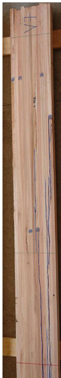
**Figura G.1 (b)** – Ruptura da viga V7: lado direito
