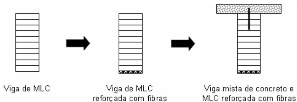
**Figura 2.20** – Evolução dos sistemas estruturais para pontes de vigas de madeira.
