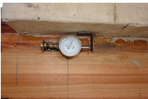
**Figura 5.29** – Relógio comparador na interface MLC-concreto
