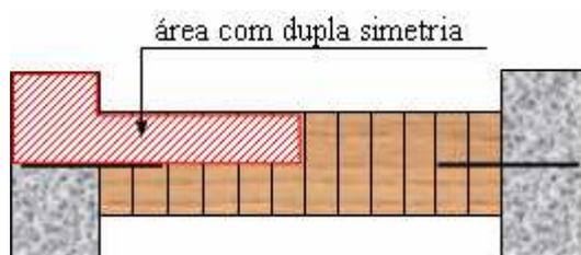
**Figura 4.18** – Esquema de simetria dos MODELOS 1 a 5
