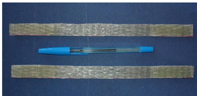
**Figura 3.15** – Corpos-de-prova para caracterização das fibras de vidro
