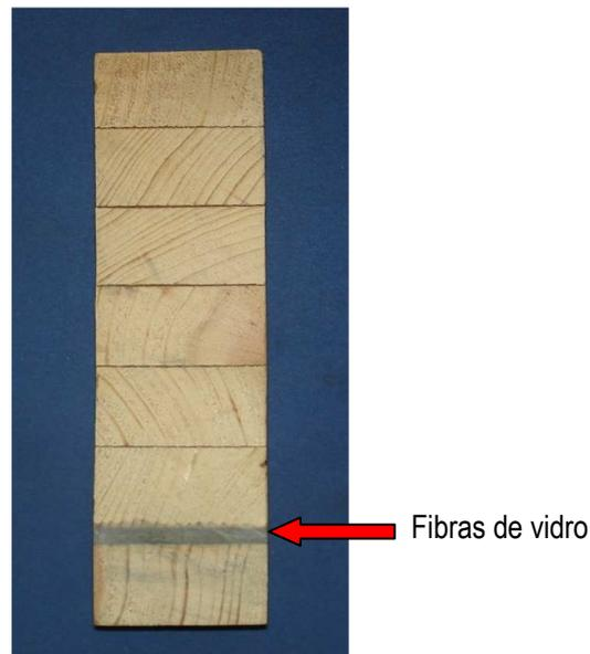
**Figura 2.3** – Seção transversal de viga de MLC reforçada com fibras de vidro
