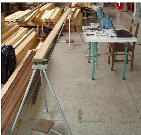
**Figura 3.3** – Ensaio por meio de vibração transversal
