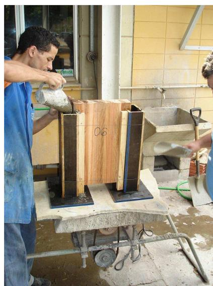
**Figura 3.8** – Concretagem dos corpos-de-prova de cisalhamento
