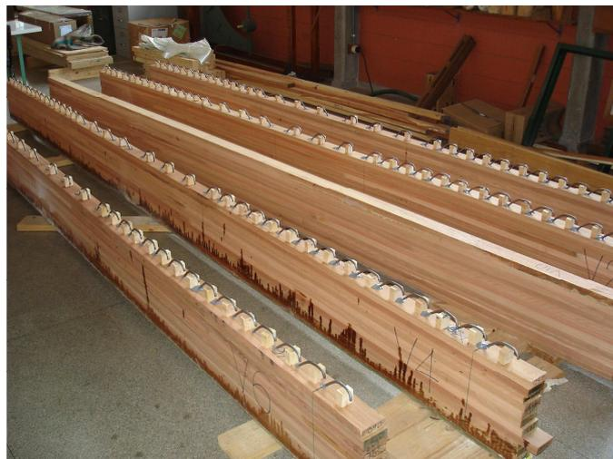
**Figura 5.22** – Vigas com ganchos metálicos colados
