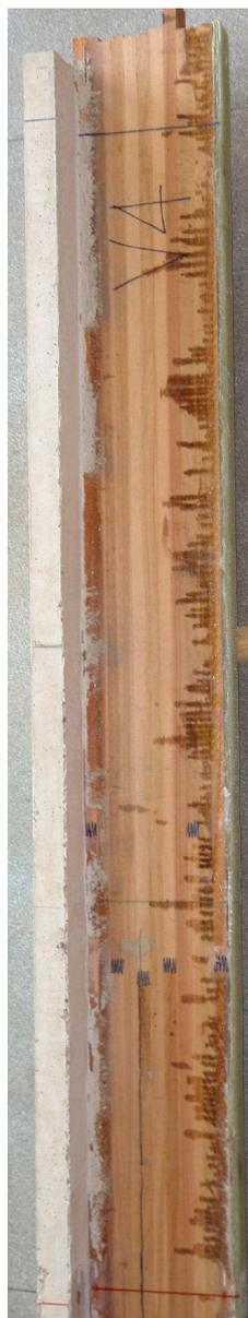
**Figura G.7(b)** – Ruptura da viga V4: lado direito
