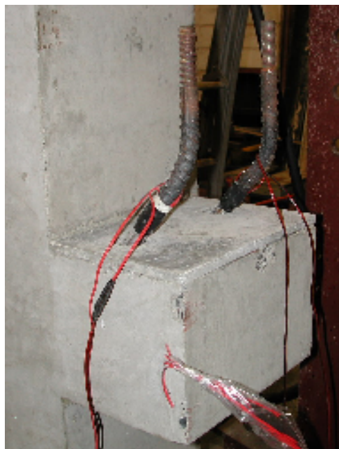
Figura 2.20 - Detalhe do chumbadores inclinados.
