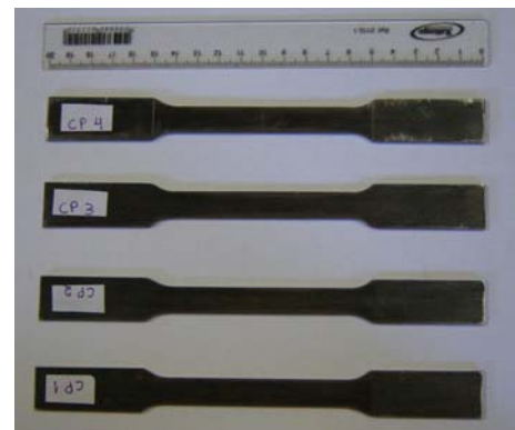
Figura 3.4 – Dimensões dos corpos-de-prova conforme ASTM A370:2007 (dimensões em mm)
