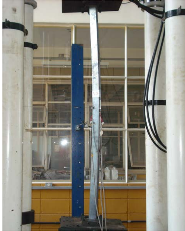
Figura 5.14 – Instabilidade por flexão: perfil Le 60x15x2,00 ( L_r = 1530 mm)
