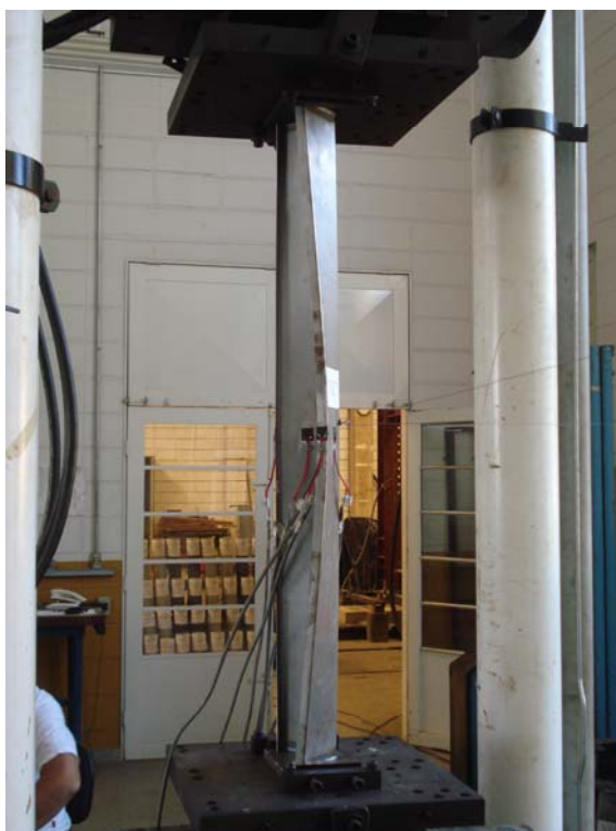
Figura 5.16 – Instabilidade por flexo-torção: perfil Le 100x15x1,50 ( L_r = 1135 mm)
