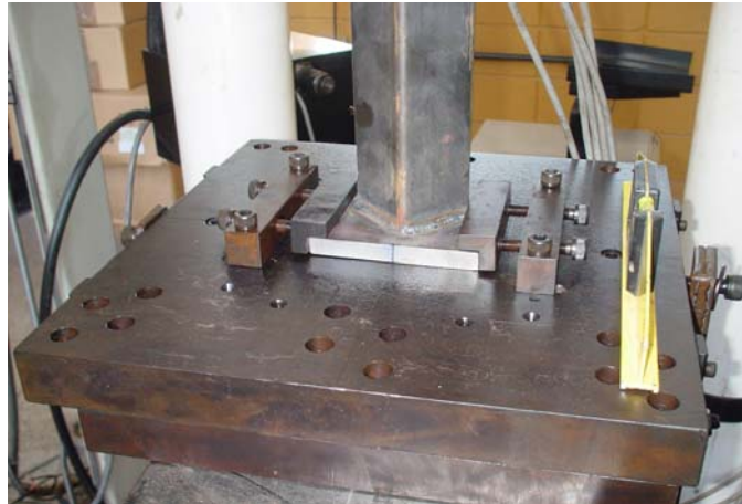
Figura 3.14 – Dispositivo de centragem da barra na máquina de ensaio
