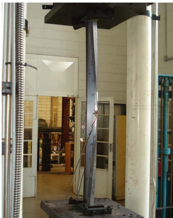
Figura 5.13 – Instabilidade por flexo-torção: perfil Le 60x15x2,00 ( L_r = 1090 mm)
