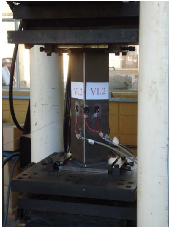
Figura 3.23 – Instrumentação perfil Le 100x15x1,50
