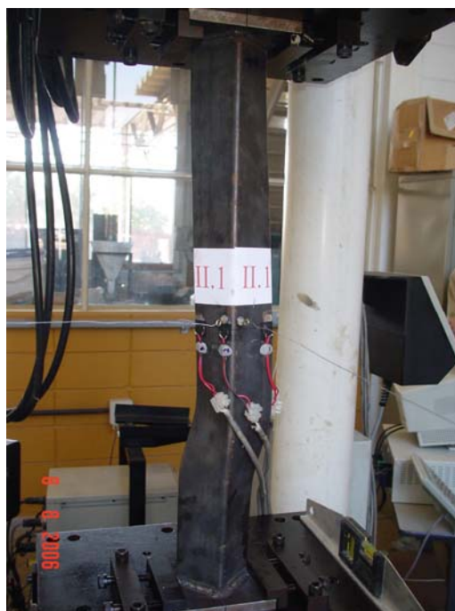
Figura 3.18 – Instrumentação perfil L 60x2,25 (barra tipo II)
