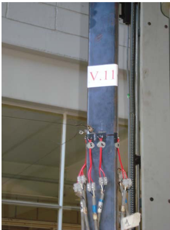
Figura 3.21 – Instrumentação perfil Le 60x15x2,00 (modelo 2)
