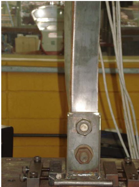
Figura 5.7 – Instabilidade por flexo-torção: perfil L 60x2,25 (tipo IV, L_r = 970 mm)
