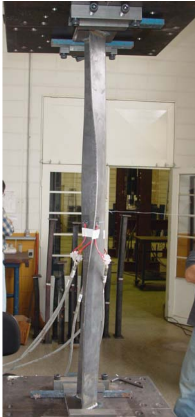
Figura 2.19 – Instabilidade por flexo-torção (Fonte: Chodraui (2006))
