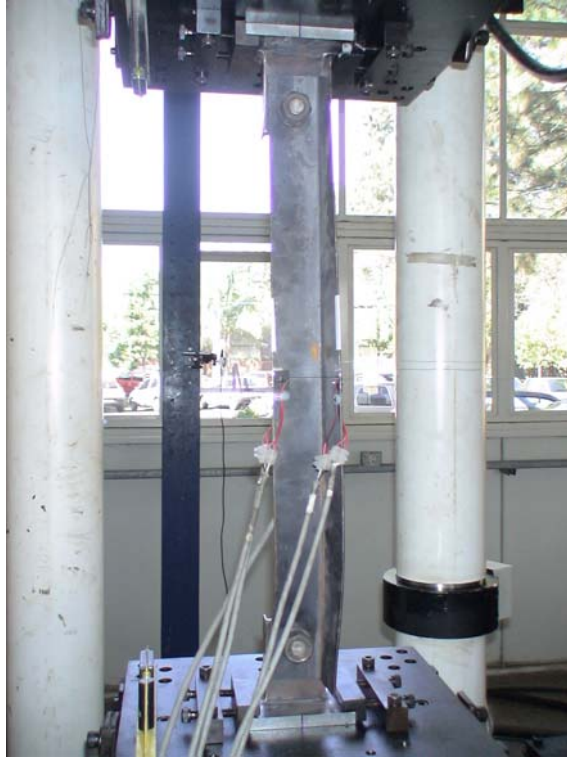
Figura 5.6 – Instabilidade por flexo-torção: perfil L 60x2,25 (tipo III, L_r = 970 mm)
