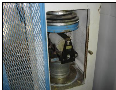
d) Ensaio de tração por compressão diametral
