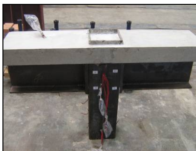
d) Modelo experimental após a cura do concreto
