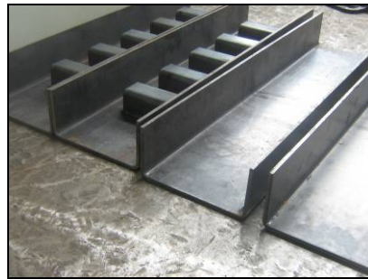
b) Perfis cortados com conectores já soldados nas faces.
