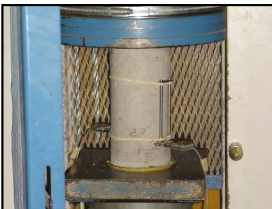
c) Realização do ensaio de resistência à compressão e módulo de elasticidade
