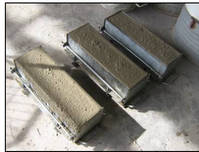
d) Vigas prismáticas para o ensaio de energia de fraturamento
