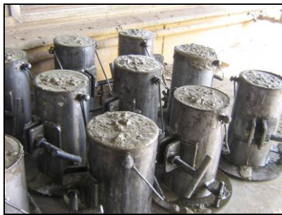
c) Corpos-de-prova cilíndricos para caracterização do concreto
