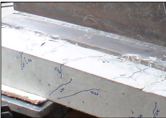
b) Fissuras na parte superior da laje (proximidade com a viga de aço)
