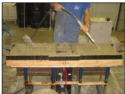
c) Adensamento do concreto da laje
