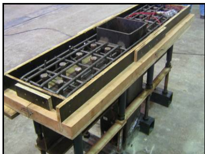
a) Modelo físico antes da moldagem do concreto
