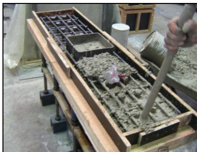
b) Adensamento do concreto da laje e do núcleo de concreto
