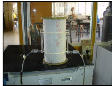
b) Instrumentação para determinação do módulo de elasticidade
