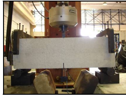
b) Ensaio de energia de fraturamento.
