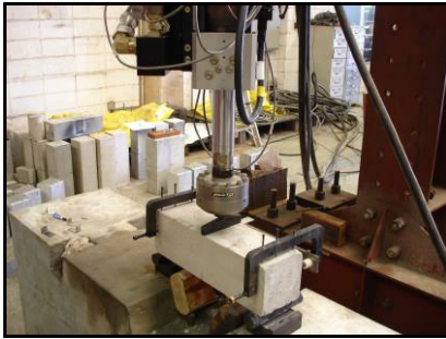
a) Realização do ensaio para determinação da energia de fraturamento.
