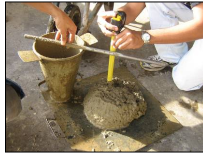
b) Abatimento do tronco de cone
