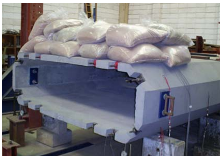
Figura 5.31 – Carga de 1 tonelada na Aduela II em balanço.
