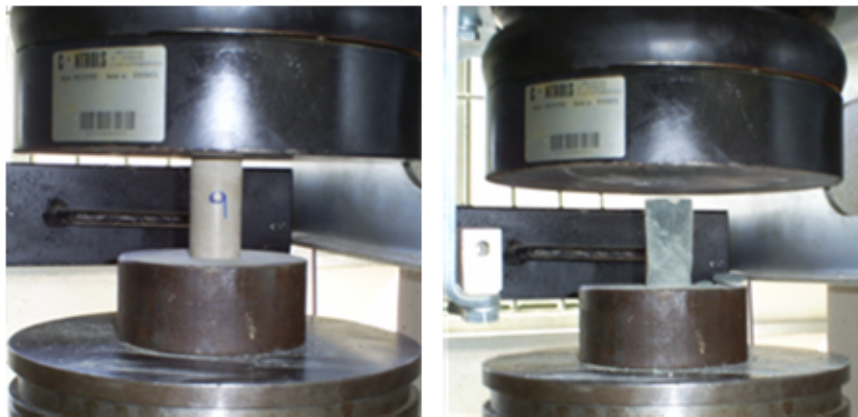
Figura C.5 – Corpo-de-prova da argamassa antes e após a aplicação de carga.
