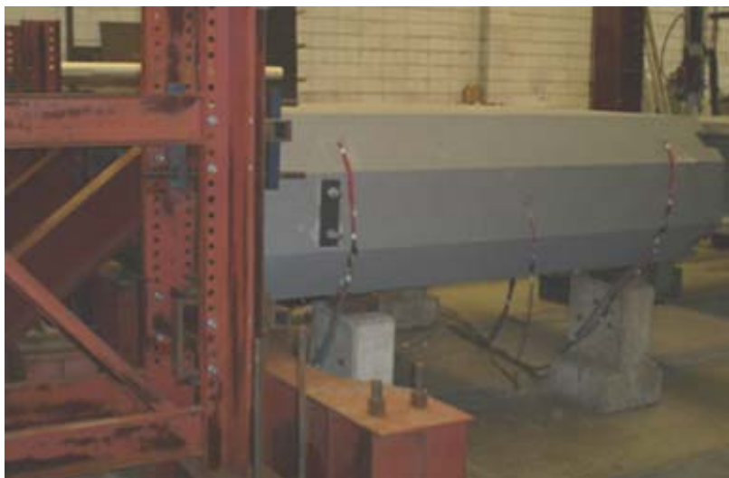
Figura 5.15 – Aduela I apoiada em blocos de concretos.
