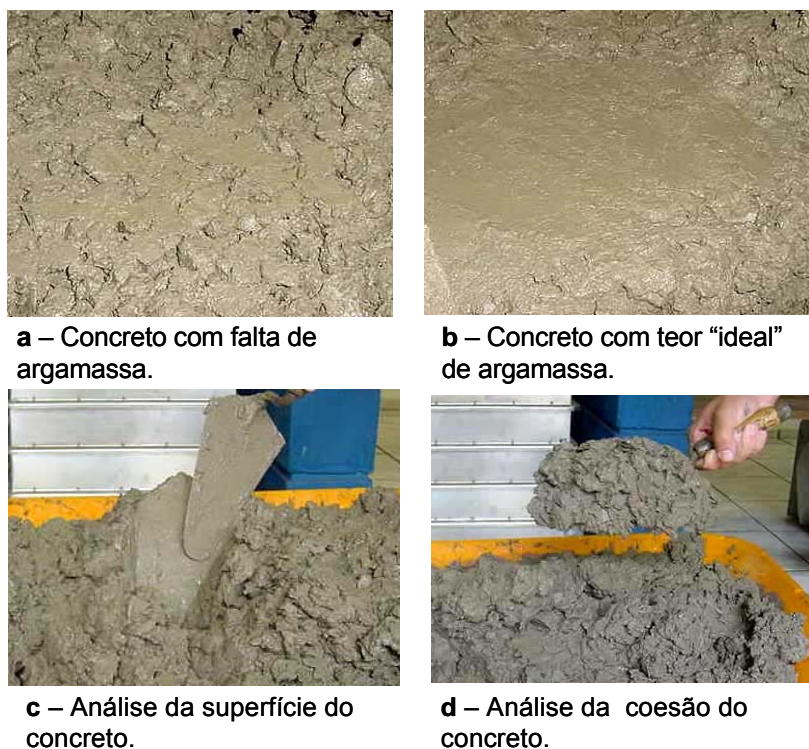
Figura 2.7 - Ensaio de verificação de teor de argamassa, em concretos com adição de sílica ativa.
