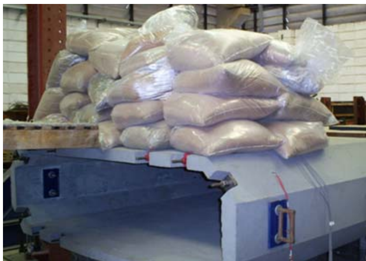
Figura 5.32 – Carga de 2 toneladas na Aduela II em balanço.
