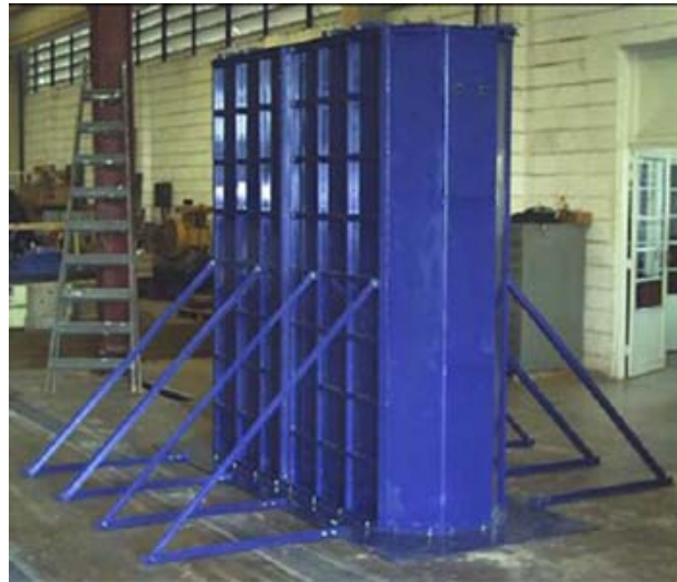
Figura B.2 – Fotografia da forma metálica para a confecção das aduelas prêmoldadas.
