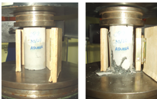
Figura 4.8 – Corpo-de-prova entre os pratos da prensa hidráulica antes e após o ensaio de compressão axial.
