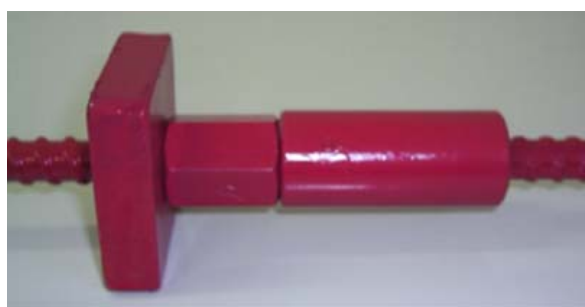
Figura 3.15 – Foto do sistema de protensão.
