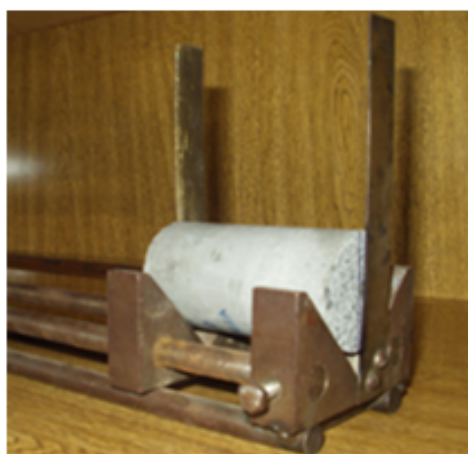
Figura 4.12 – Aparato para marcação e dispositivo para ensaio de tração por compressão diametral respectivamente.
