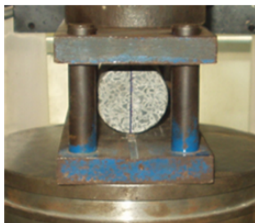
Figura 4.12 – Aparato para marcação e dispositivo para ensaio de tração por compressão diametral respectivamente.
