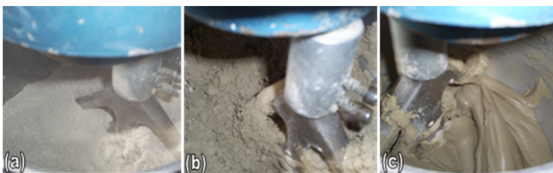
Figura C.2 – Seqüência de mistura da argamassa.
