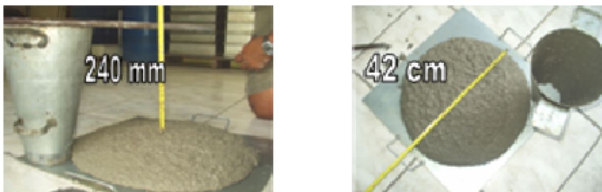
Figura 4.29 – Consistência e espalhamento obtido pelo concreto da Aduela II.
