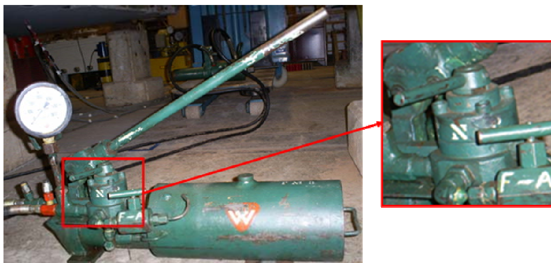
Figura D.3 – Bomba hidráulica manual com alívio e detalhe da chave de protensão.
