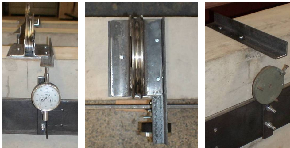
Fig. 7.41: Fixação dos componentes da instrumentação (ensaios de flexão).
