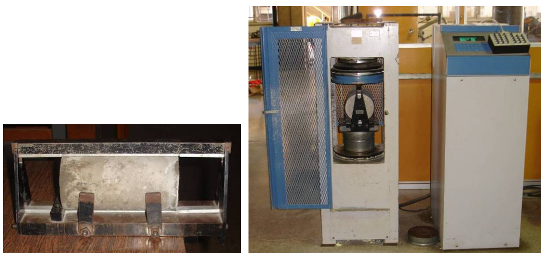
Fig. 7.18: Compressão diametral – máquina de ensaios ELE.
