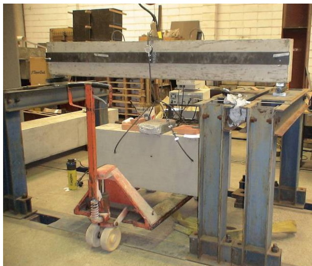
Fig. 7.27: Medição da flecha inicial – Série 2.
