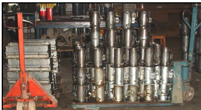
Fig. 7.2: Fotos das fôrmas metálicas: (a) cp(s) cilíndricos, (b) prismas.
