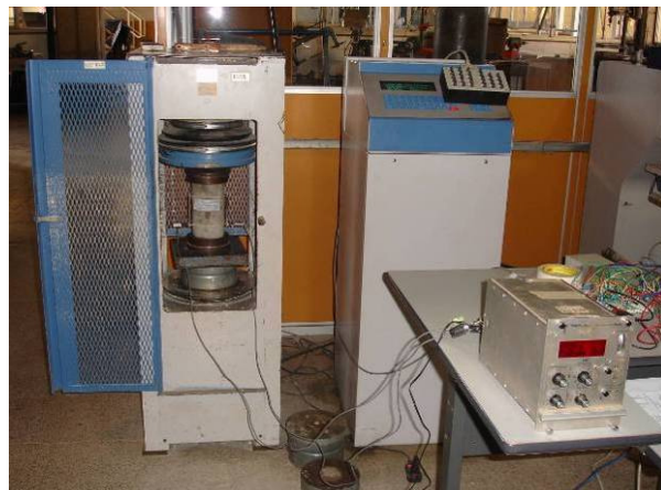
Fig. 7.17: Compressão Axial - Máquina de ensaios ELE.
