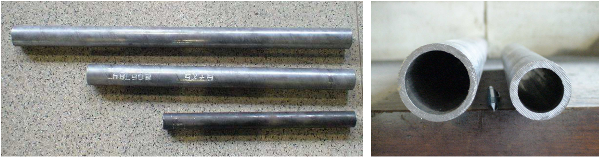
Figura 3.6 – Tubos para o ensaio definitivo com a) comprimento de 300 mm, 500 mm e 700 mm e b) diâmetro externo de 57 mm e 45 mm
