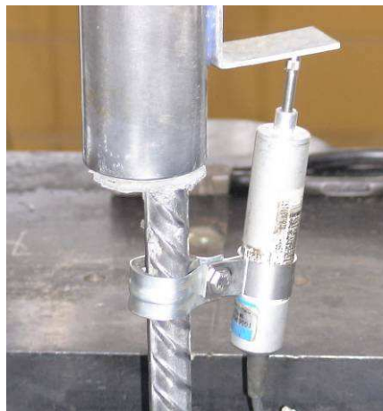
Figura 4.2 – Transdutor inclinado devido a estirção da barra
