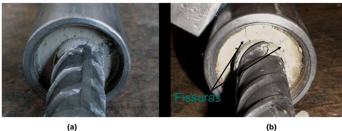
Figura 4.11 – Extremidade do transdutor 2 a) antes do ensaio e b) depois do ensaio com aparecimento de fissuras de fendilhamento
