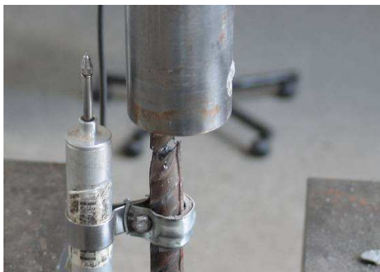
Figura 4.41 – Ruptura da barra de aço da emenda 45T16EE-200C2
