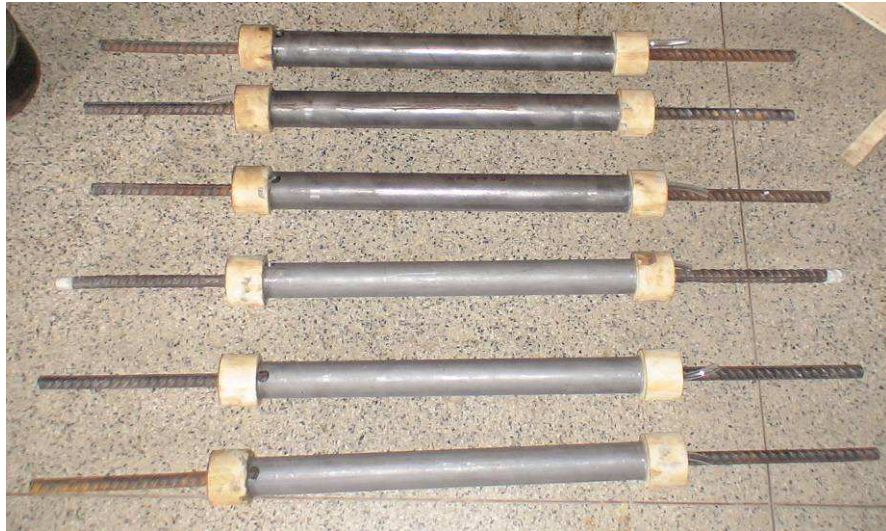
Figura 3.30- Emendas da série 2 preparadas para serem moldadas
