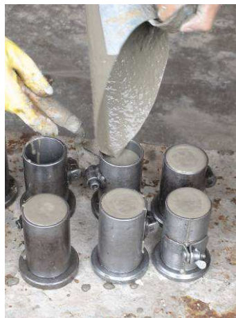
Figura 3.4– Moldagem dos corpos-de-prova
