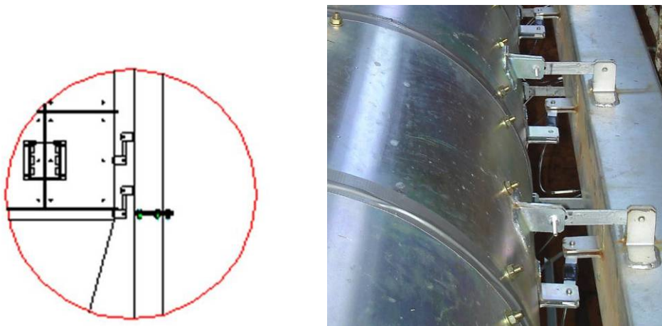
Figura 32 - Sistema de medição da força de atrito nas paredes, célula de carga de 8 kN.
