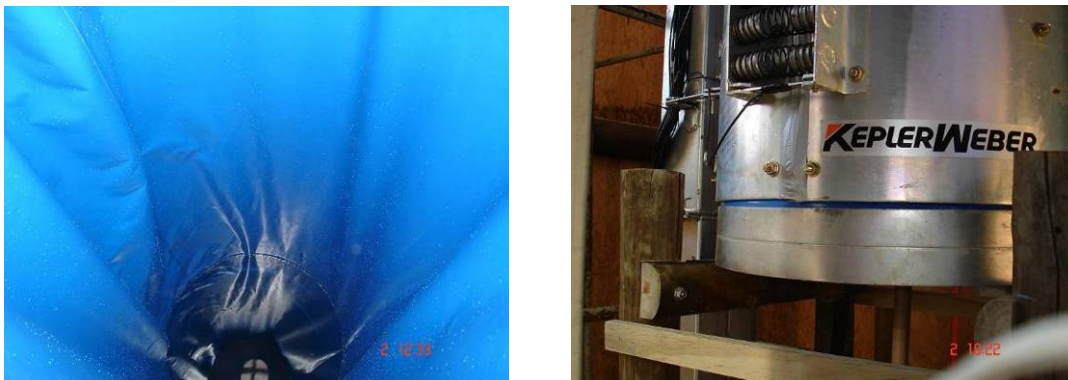
Figura 45 - Detalhes da lona plástica e do fundo plano com o silo piloto cheio d'água.
