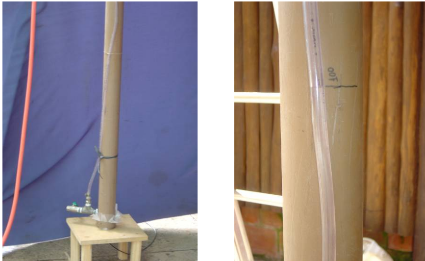
Figura 43 – Sistema de vasos comunicantes para a calibração da célula de pressão.
