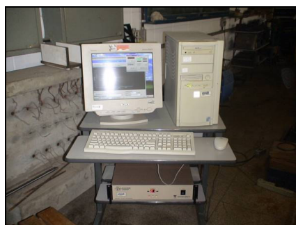
b) Conjunto de equipamentos que contém o sistema de aquisição de dados para determinação da frequência natural dos corpos-de-prova
