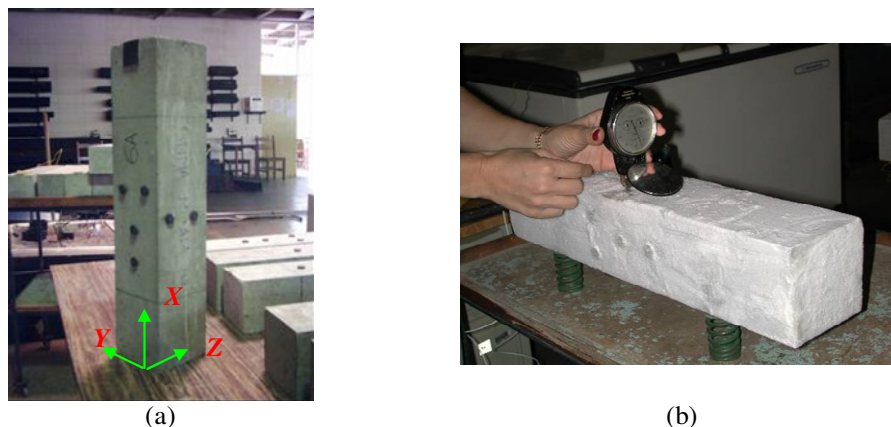
Figura 32. (a) Corpo-de-prova instrumentado com as bases do extensômetro mecânico; (b) Procedimento de leitura. Fonte: Lima (2006).
