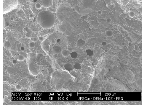
Vazios de ar numa amostra fratura de concreto.
