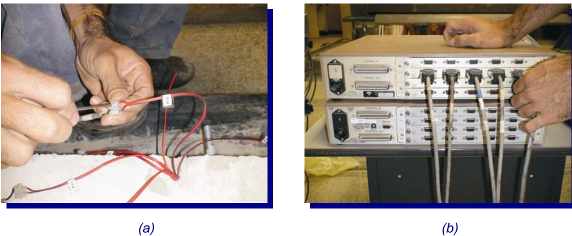
Figura 4.23 - (a) conexão dos fios condutores (b) conexão dos fios condutores ao aparelho de medição eletrônico.
