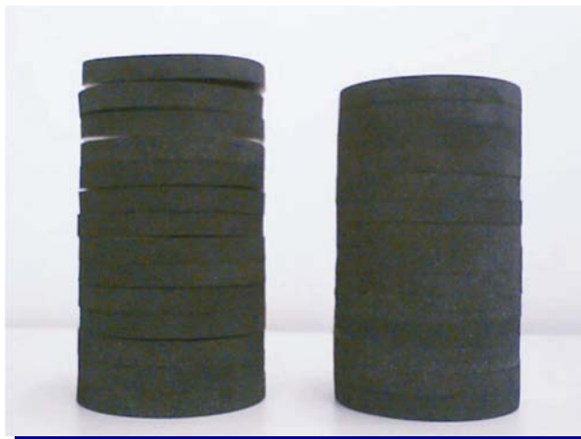
Figura 6.5 – Corpo-de-prova de borracha em estado inicial (esquerda) e depois de comprimido (direita)
