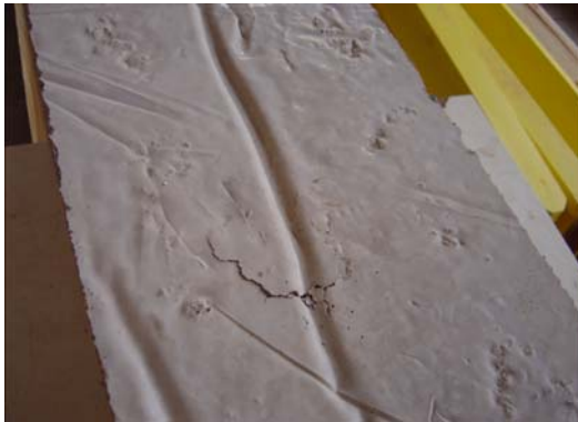
a) Esmagamento da mesa de concreto após 1 \times 10^6 ciclos de carga (viga VR11).
