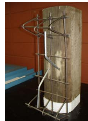
c) Detalhe da armadura utilizada no concreto
