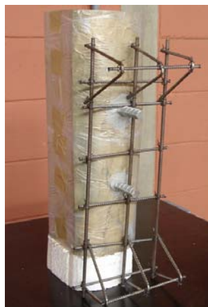
b) Detalhe da armadura utilizada no concreto
