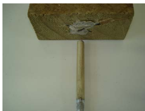
(b) Ruptura da adesão na madeira.
