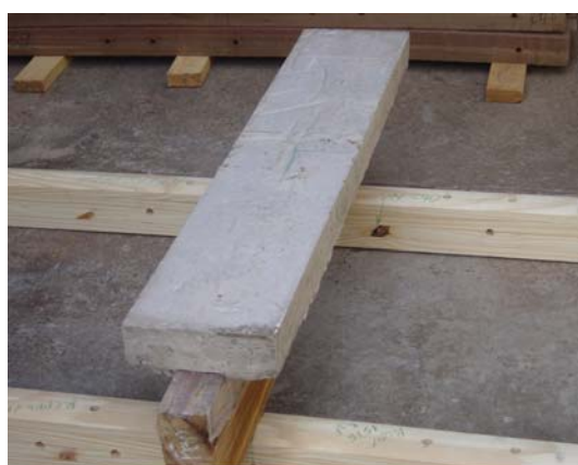
d) Viga pronta para a realização dos ensaios estáticos e dinâmicos de flexão
