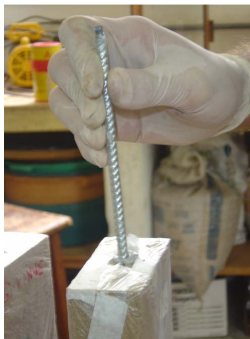
b) Eliminação das bolhas de ar.
