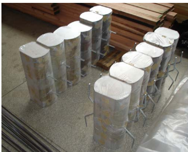
Figura 3.41: Peça roliças de madeira após a colagem das barras de aço, revestidas com sacos plásticos de polietileno.
