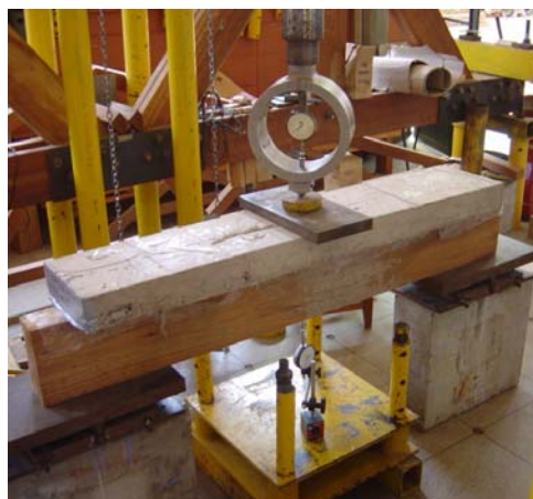
Figura 3.69: Ensaio estático de flexão para determinação da carga última das vigas.
