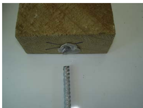
(e) Ruptura da barra de aço.
