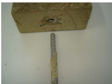
(c) Ruptura mista da adesão na madeira e no aço.
