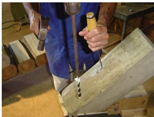
a) Marcação inicial do furo
