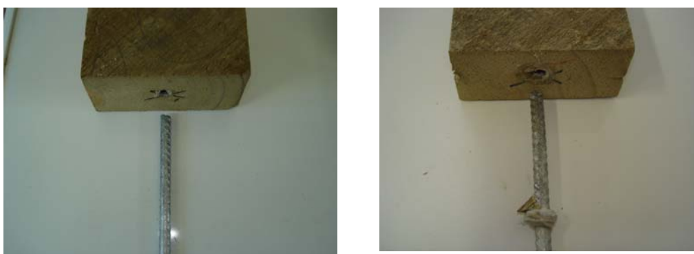
(a) Ruptura da adesão no aço.
