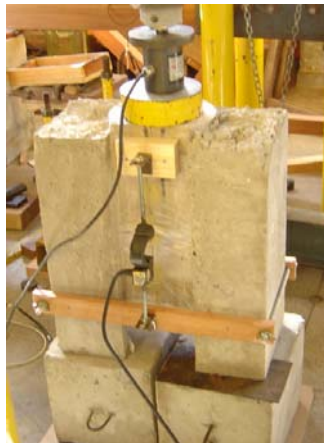
a) Ensaio estático de cisalhamento
