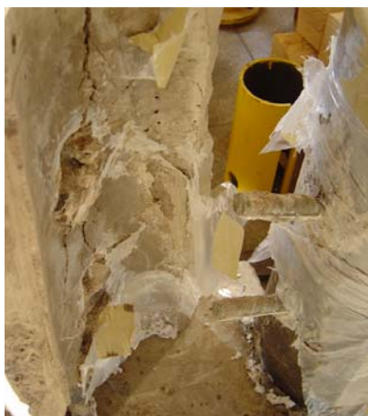
a) Fissuração no concreto e flexão dos conectores com embutimento na madeira – comportamento observado nos ensaios estáticos de cisalhamento conduzidos até a ruptura.
