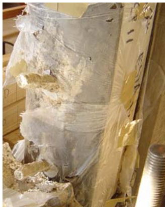
b) Flexão dos conectores após 2 \times 10^6 ciclos de carga aplicados (CP12-VR2)
