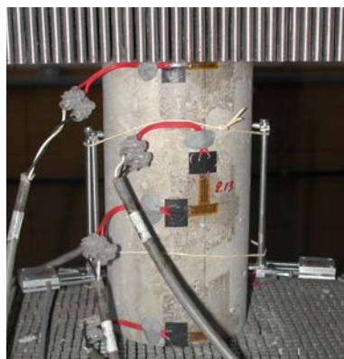
Figura 4.12 – Instrumentação utilizada nos corpos-de-prova cilíndricos de concreto.
