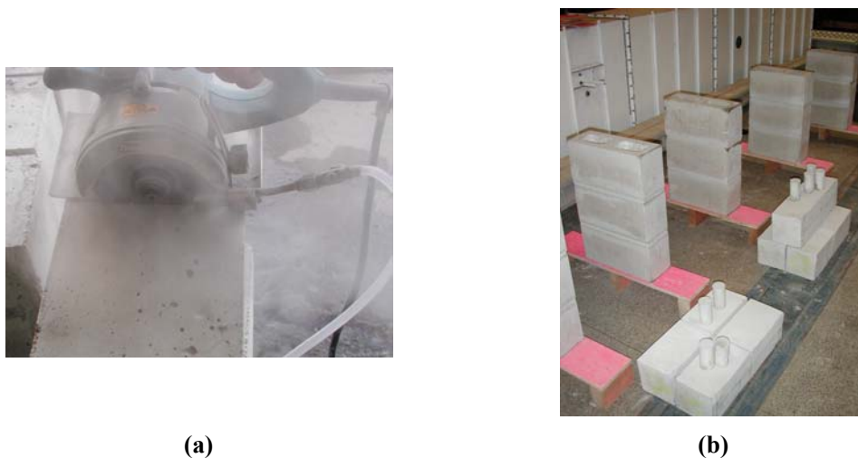
Figura 4.11 – Execução do entalhe nas vigas (a) e posterior armazenagem dos corpos-de-prova de argamassa ao lado dos prismas (b).
