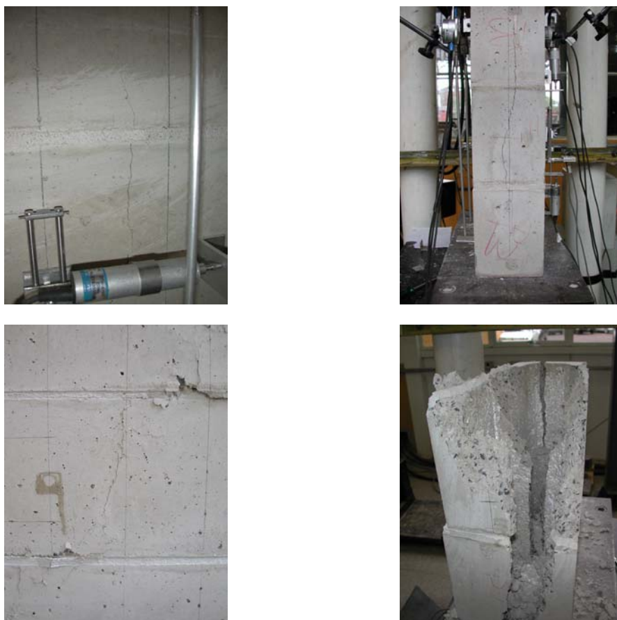
Figura 4.19 – Evolução da fissuração e cenário pós-ruptura nos ensaios de prismas de três blocos.
