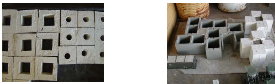
Figura 3.16 – Fôrmas cilíndricas e cúbicas de gesso e concreto utilizadas para a moldagem de corpos-de-prova de argamassa.
