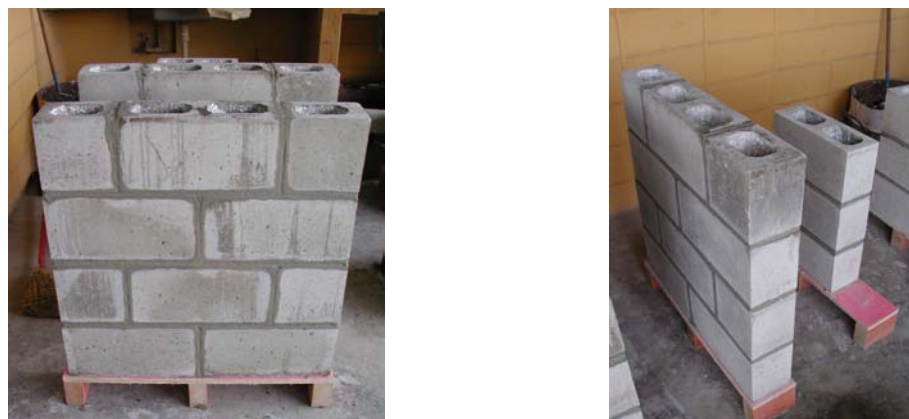
Figura 4.7 – Detalhe da miniparede de blocos de concreto.
