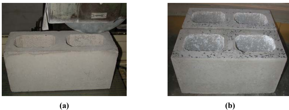
Figura 4.3 – Processo de retífica do bloco (a) e acabamento final de suas superfícies (b).
