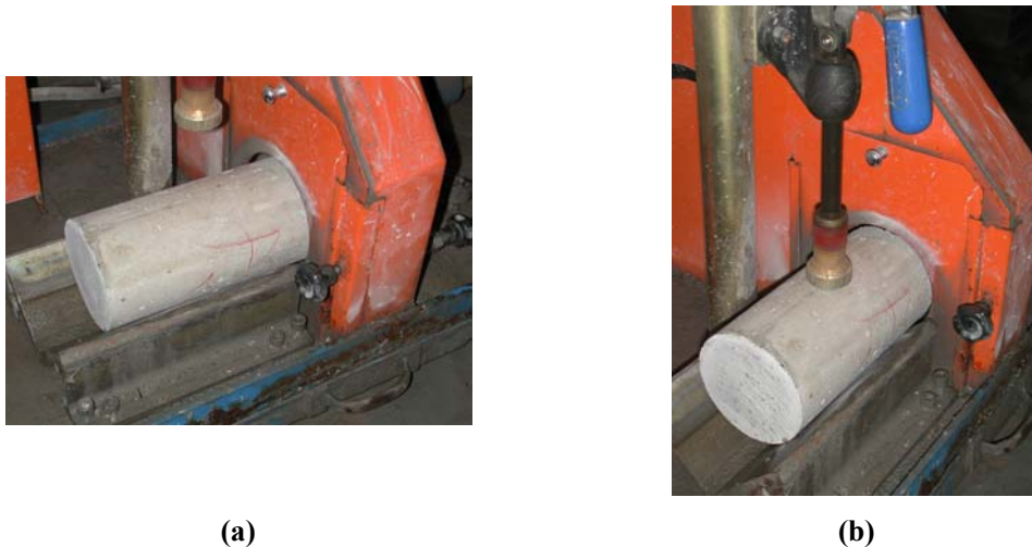
Figura 4.10 – Processo de retífica nos corpos-de-prova (a) e detalhe do acabamento (b).
