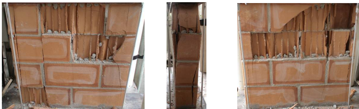
Figura 3.30 - Cenário pós-ruptura da miniparede com blocos CE6 - Série 2.
