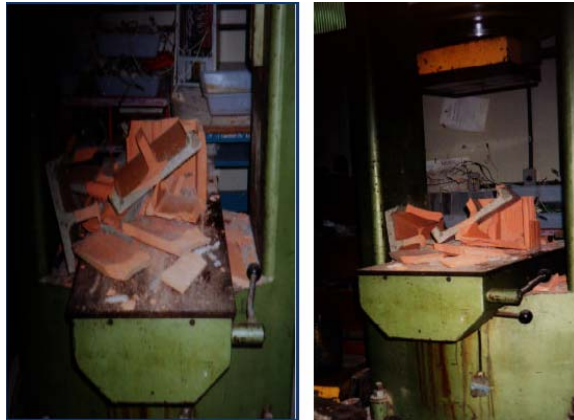
Figura 2.23 - Cenário pós-ruptura de prisma com argamassa 1 : 0,25 : 3, Mendes (1998).
