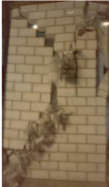
Figura 2.24 - Ruptura frágil do painel de parede com blocos sílico-calcários, Franco (1987).
