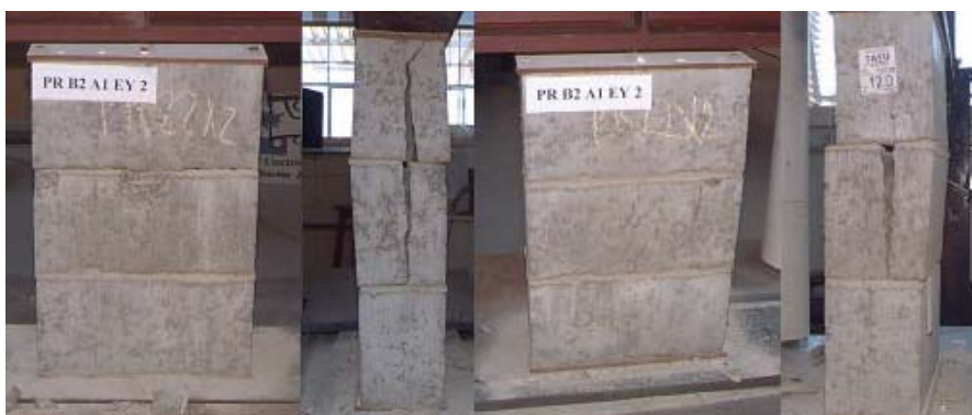
Figura 2.10 - Exemplo do cenário pós-ruptura de prisma da série B2A1, Juste (2001).
