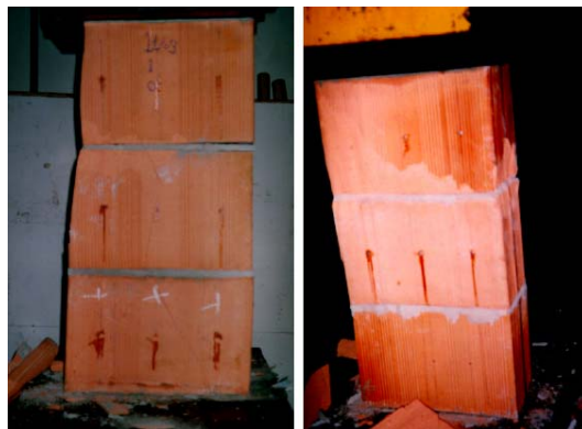
Figura 2.22 - Cenário pós-ruptura do prisma com argamassa 1 : 1 : 6, Mendes (1998).
