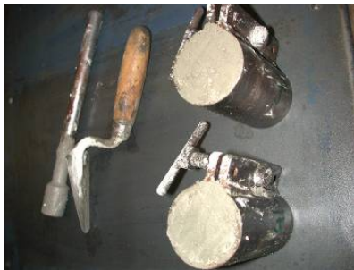
Figura 3.18 - Execução dos CPs de argamassa em fôrmas metálicas (5 x 10 cm).
