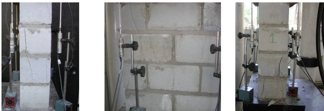
Figura 3.34 - Cenário pós-ruptura da miniparede com blocos S10 - Série 1.
