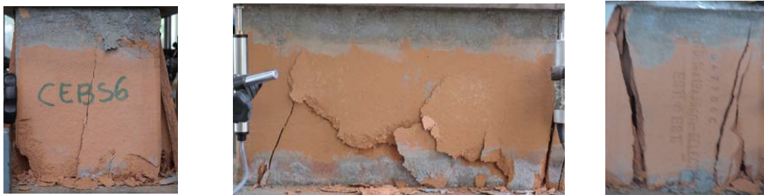
Figura 3.27 - Cenário pós-ruptura observado para o bloco 6 - CE6.
