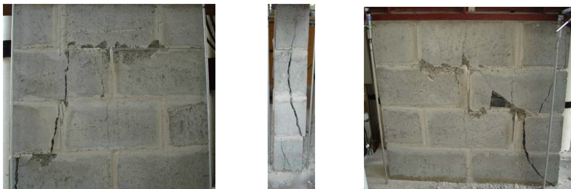
Figura 3.26 - Cenário pós-ruptura da miniparede com blocos C8 - Série 6.
