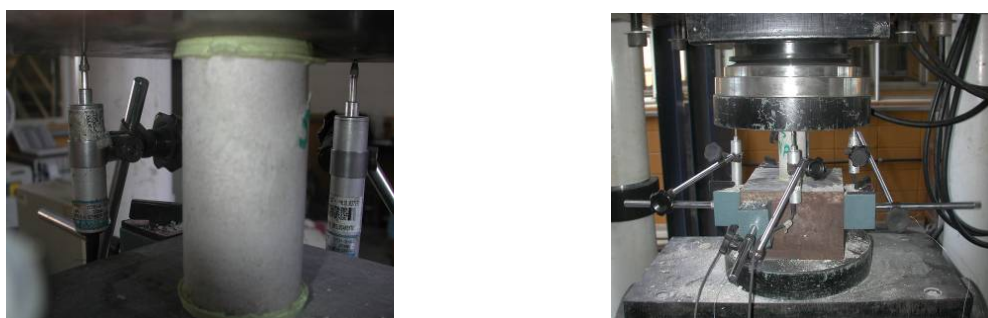
Figura 3.8 - Ensaio de compressão axial em corpos-de-prova de argamassa.
