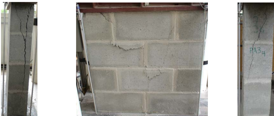
Figura 3.22 - Cenário pós-ruptura da miniparede C4,5 - Série 3.
