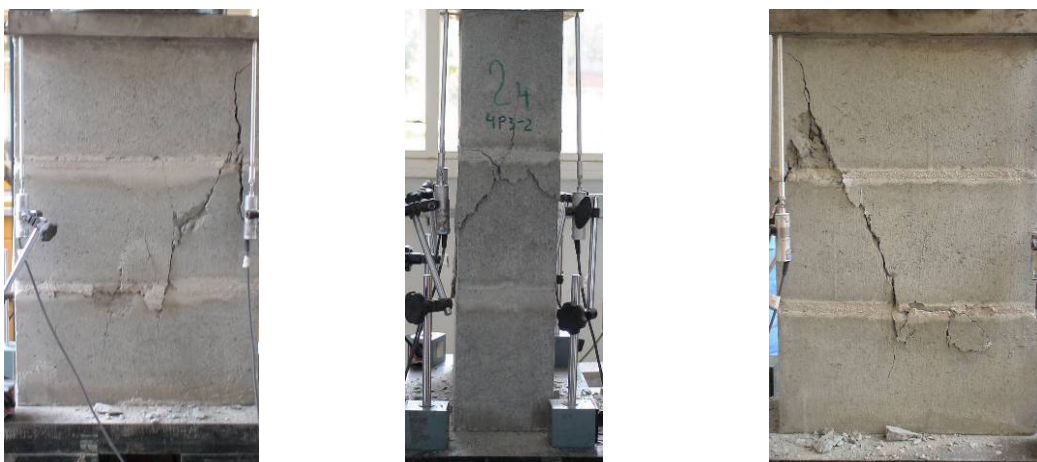
Figura 3.21 - Cenário pós-ruptura do prisma de 3 blocos C4,5 - Série 2.
