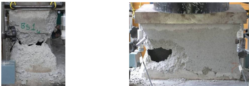
Figura 3.19 - Cenário pós-ruptura do bloco 1 - C4,5.
