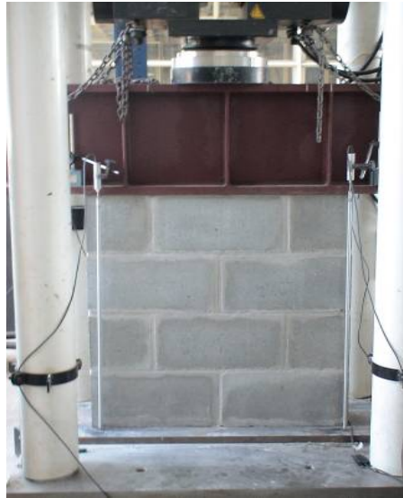
Figura 3.13 - Perfil metálico utilizado nos ensaios de miniparedes.
