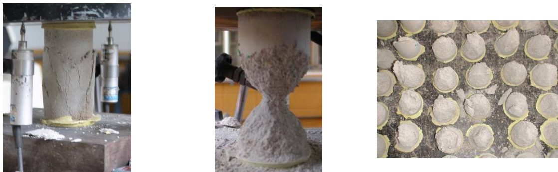
Figura 3.35 - Cenários pós-ruptura de corpos-de-prova de argamassa.
