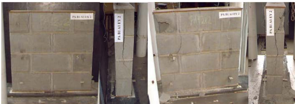
Figura 2.12 - Cenário pós-ruptura para miniparede B1A1, Juste (2001).
