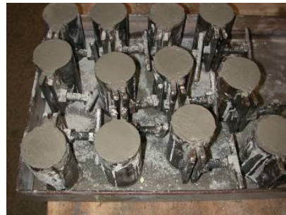
Figura 3.18 - Execução dos CPs de argamassa em fôrmas metálicas (5 x 10 cm).
