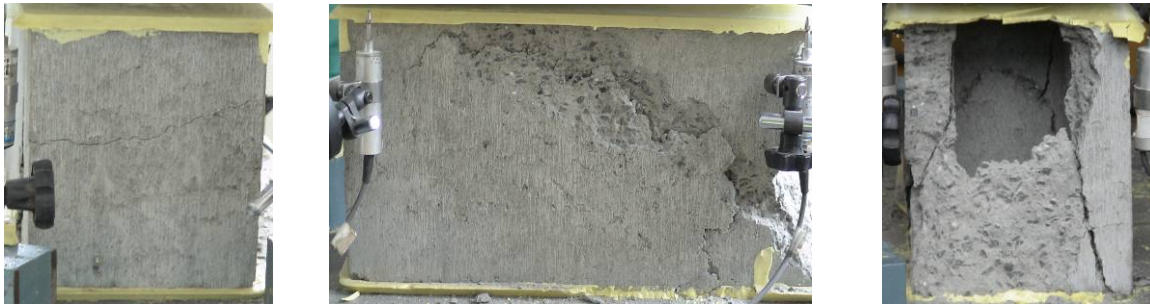
Figura 3.23 - Cenário pós-ruptura observado para o bloco 10 - C8.
