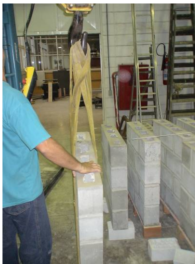
Figura 3.12 - Transporte das miniparedes.
