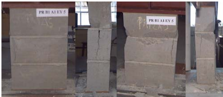
Figura 2.9 - Exemplo do cenário pós-ruptura de prisma da série B1A1, Juste (2001).
