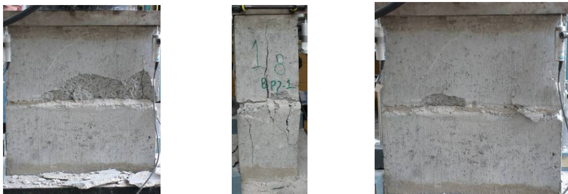
Figura 3.24 - Cenário pós-ruptura do prisma de 2 blocos C8 - Série 1.
