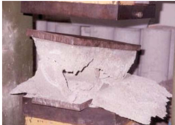
Figura 2.14 - Cenário pós-ruptura no bloco de concreto, Calçada (1998).
