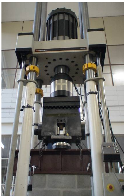
Figura 3.5 - Máquina Universal de Ensaio INSTRON.
