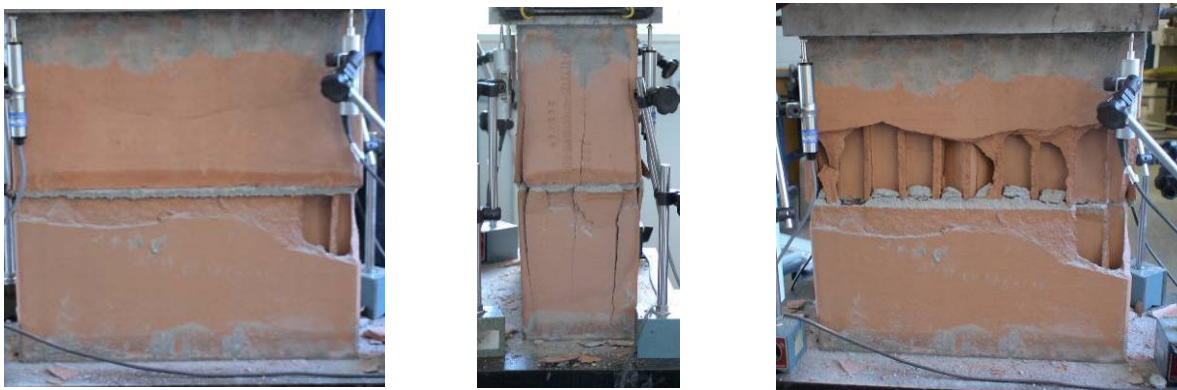
Figura 3.28 - Cenário pós-ruptura do prisma de 2 blocos CE6 - Série 1.
