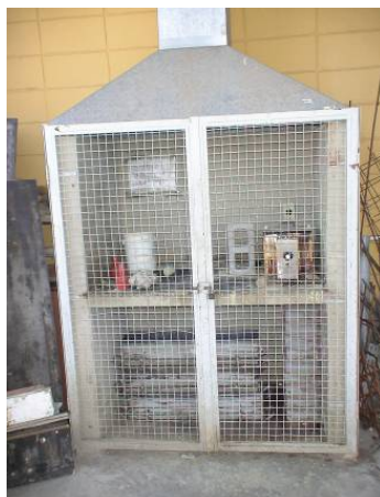
Figura 3.15 - Capela utilizada para o capeamento com enxofre.
