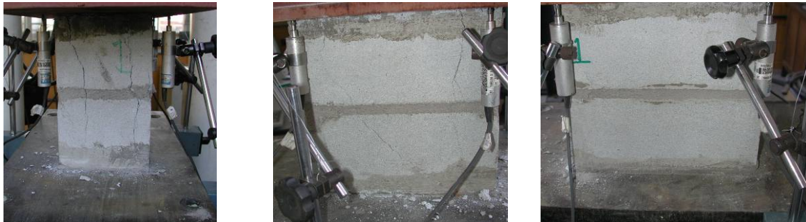
Figura 3.32 - Cenário pós-ruptura do prisma de 2 blocos S10 - Série 1.
