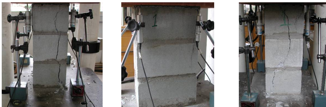
Figura 3.33 Cenário pós-ruptura do prisma de 3 blocos S10 - Série 1.
