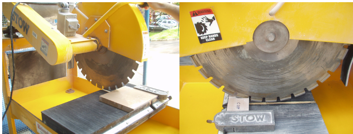
Figura 3.18 – Corte de peça com serra policorte e disco rotativo diamantado ( \varnothing 500 mm)
