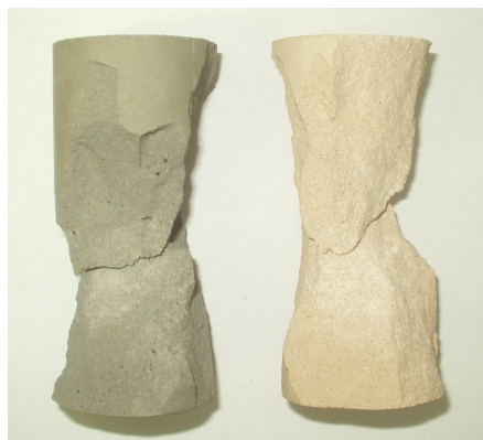
Figura 3.6 – Ruptura cônica de corpos-de-prova comprimidos axialmente
