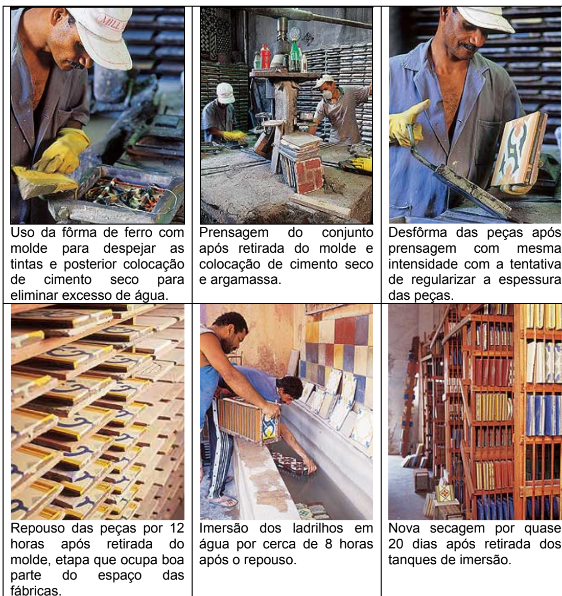
Figura 2.18 – Etapas do processo de fabricação dos ladrilhos hidráulicos
