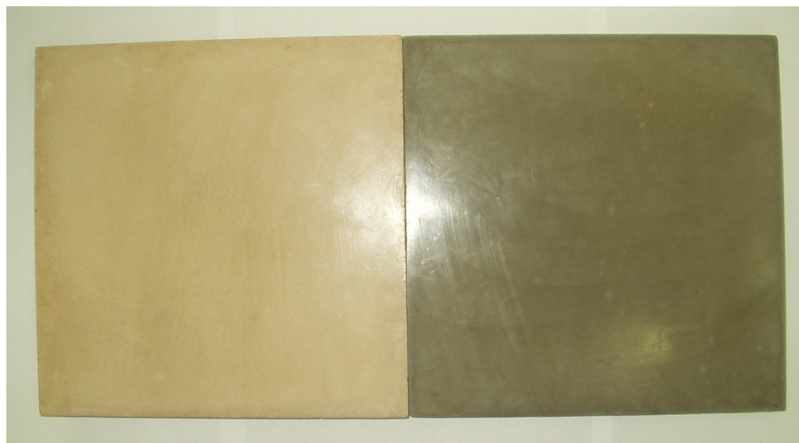
Figura 4.13 – Ladrilhos hidráulicos após restauração de superfície
