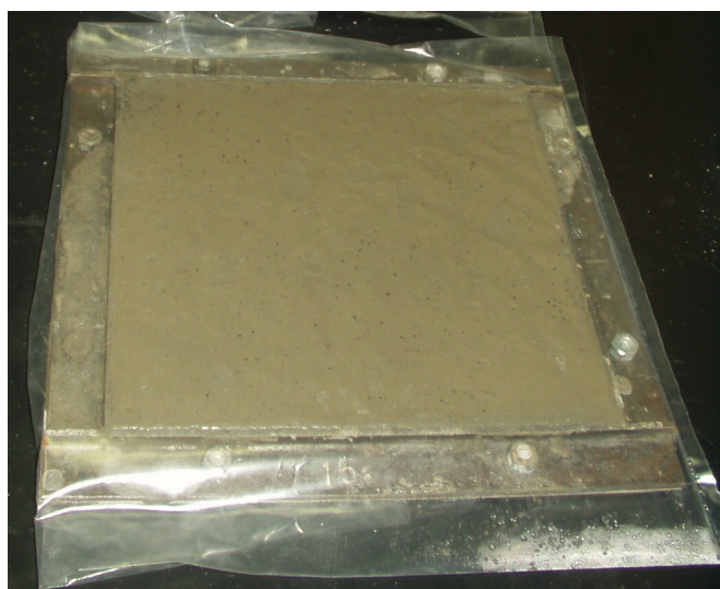
Figura 3.13 – Cura dos ladrilhos hidráulicos antes da desfôrma
