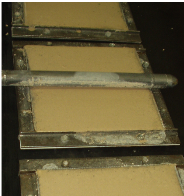
Figura 3.12 – Moldagem de ladrilhos hidráulicos com auxílio de vibrador
