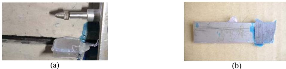
Figura 6.22 - Desprendimento do dispositivo de referência para obtenção do deslizamento: (a) desprendimento entre a cantoneira e a chapa; (b) desprendimento entre a chapa e o laminado.
