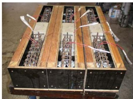
Figura 7.12 - Fôrmas para segunda etapa de concretagem dos modelos P1 SJ e N1 SJ com o trecho de pilar e com as armaduras dos trechos de viga posicionados em seu interior.
