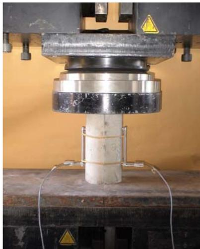
Figura 6.4 - Ensaio para a determinação da resistência à compressão e do módulo de elasticidade.
