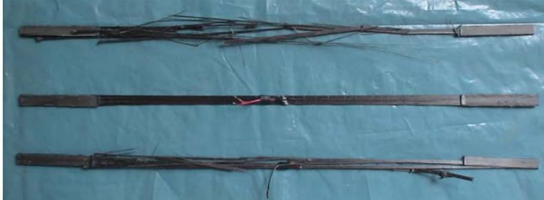
Figura 6.7 - Corpos-de-prova após ensaio de tração.
