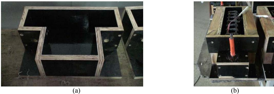
Figura 7.10 - Fôrmas para concretagem dos elementos do modelo de ligação: (a) fôrma do trecho de pilar; (b) fôrma do trecho de viga.
