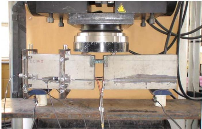
Figura 6.14 - Ensaio de aderência.
