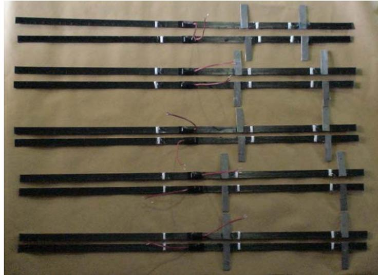
Figura 6.11 - Laminados utilizados nos modelos da série R2.
