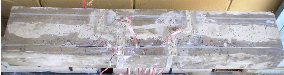
Figura 7.23 - Configuração das fissuras após a ruptura do modelo-piloto de ligação.
