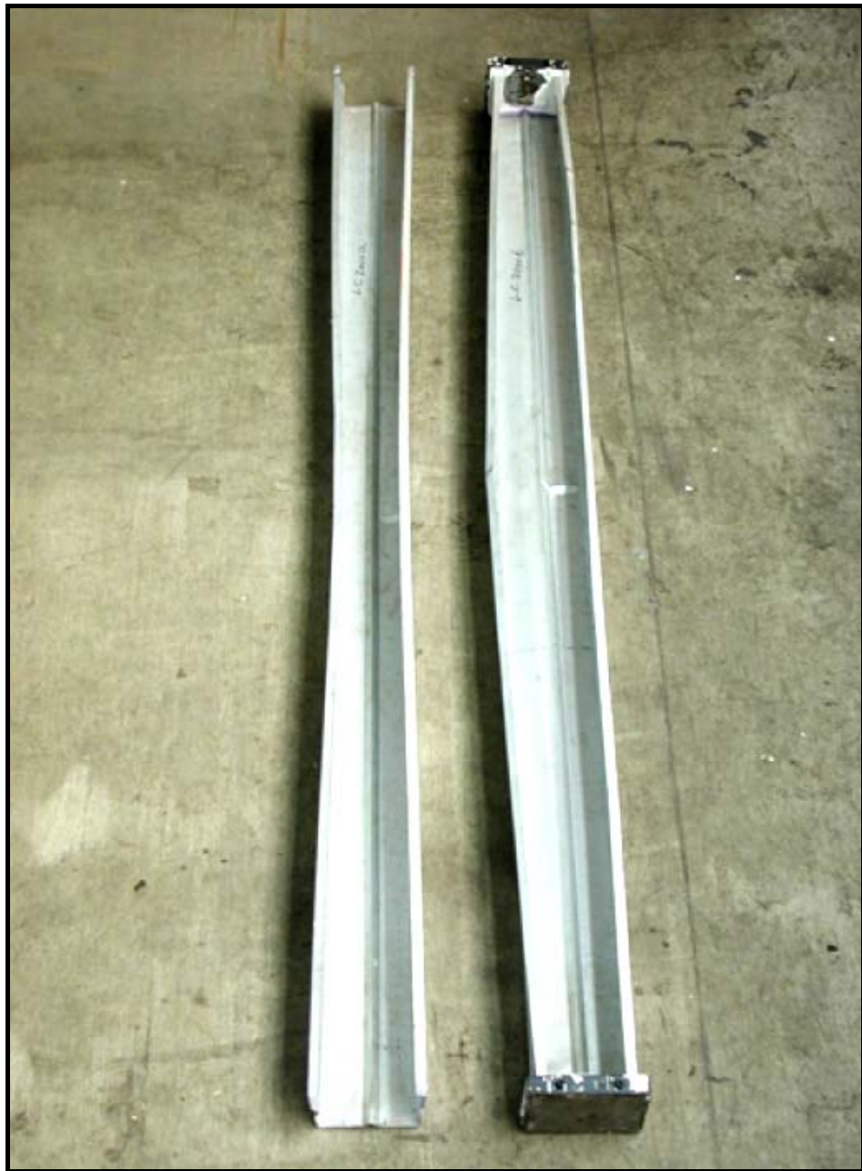
Figura 3.12 – Modos de falha de barras longas, L = 2000\text{mm} . Fonte: YANG e HANCOCK (2003)
