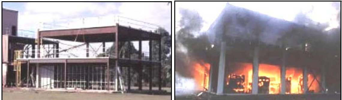
Figura 2.3 – Teste de resistência ao fogo executado pela BHP na Austrália.
