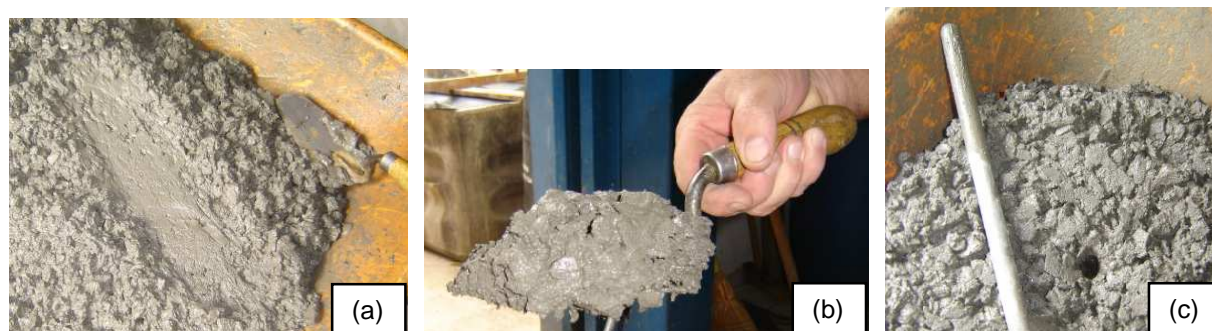
Figura 61: Testes para a determinação do teor de argamassa ótimo. (a) Acabamento liso; (b) Teste de coesão com a colher; (c) Teste de coesão com o furo.
