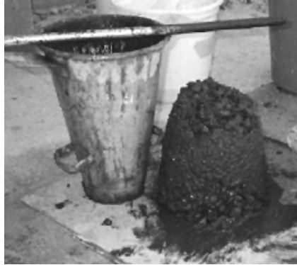
Figura 35: Aspecto do concreto fresco confeccionado com cinza da casca de arroz. Fonte: Prudêncio, Santos e Dafico (2003).
