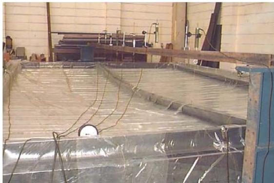
Figura 3.22 – Ensaio do sistema terça-telha em caixa de sucção. (Fonte: Javaroni(1999))
