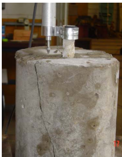
Figura 4.13 – Fendilhamento do cilindro de concreto
