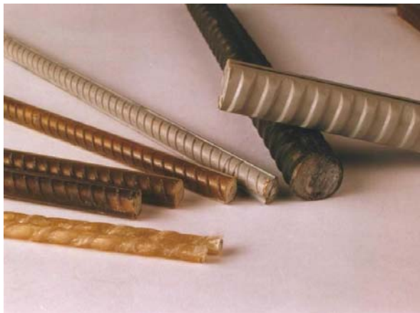
Figura 2.5 – Diferentes conformações superficiais das barras de FRP (RE-BARS CHILE, s.d.)
