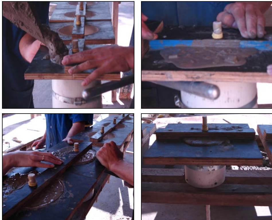
Figura 4.9 – Moldagem e adensamento dos modelos de arrancamento.
