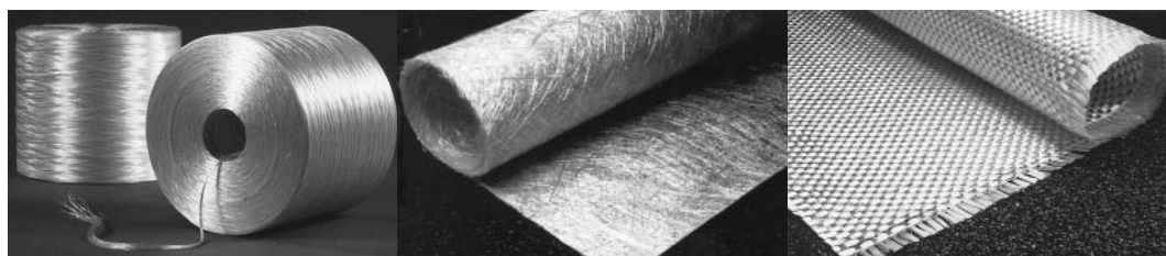
Figura 2.3 – Formas de comercialização da fibra de vidro: a) Fibra de vidro em forma de fio; b) Manta de fibra de vidro distribuída aleatoriamente; c) Tecido de fibra de vidro (ACI 440 R, 1996)
