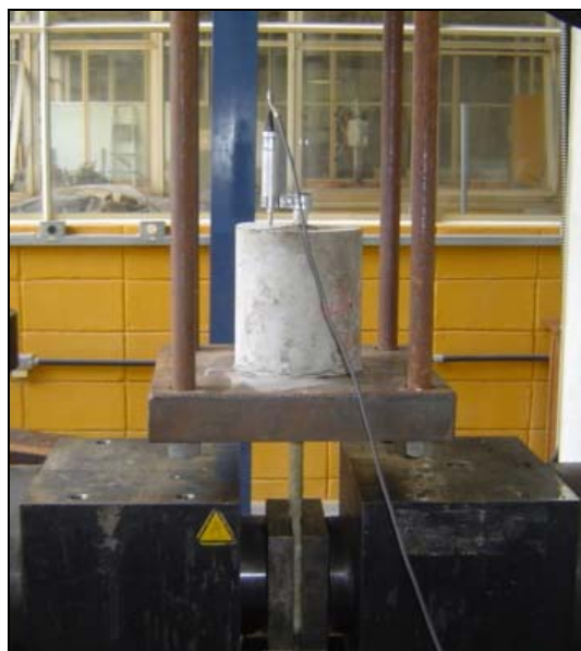
Figura 4.11 – Ensaio de arrancamento.
