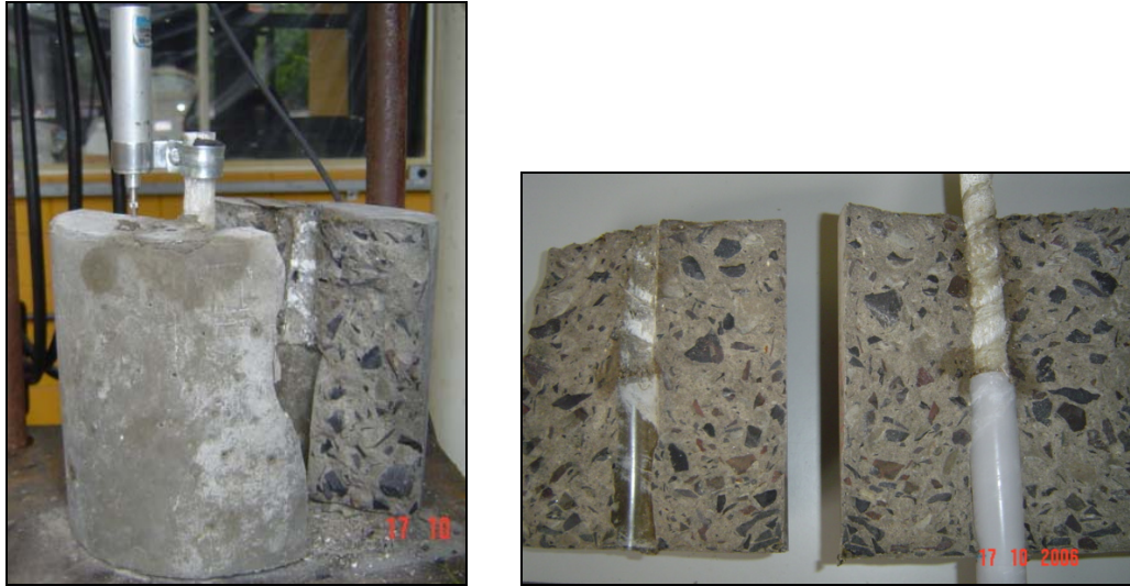
Figura 4.16 – Ruptura combinada durante ensaio de arrancamento
