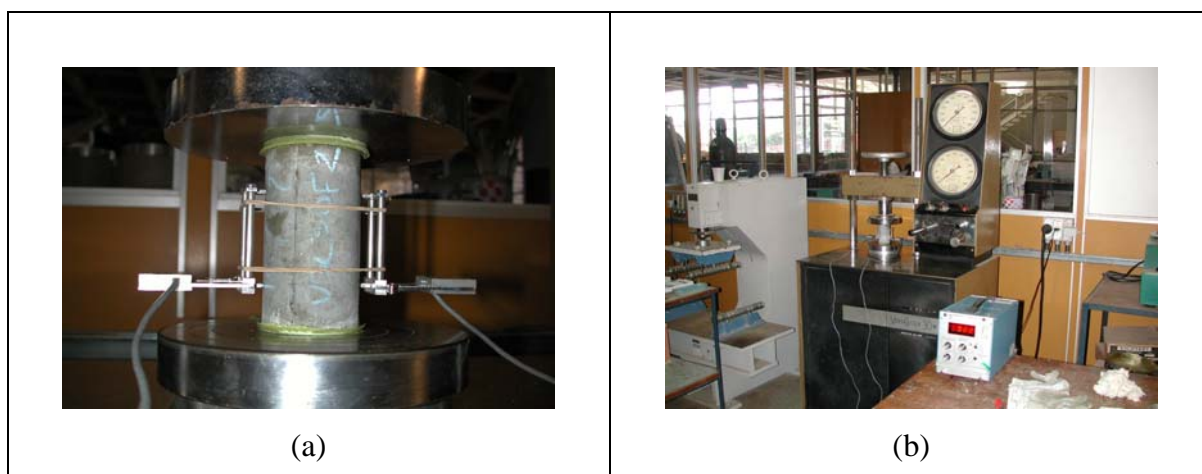
Figura 3.11: (a) Corpo-de-prova com transdutor de deslocamento; (b) esquema completo do ensaio de módulo de elasticidade.
