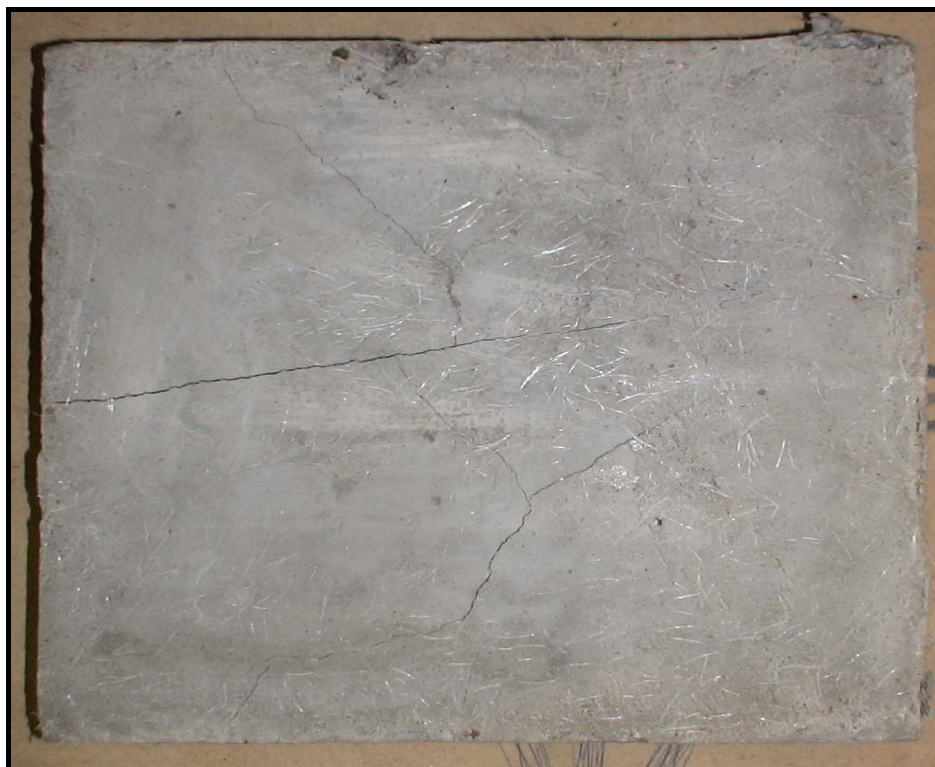
Figura 5.51: Fissuras após ensaio de rotação em almofada de 20mm.
