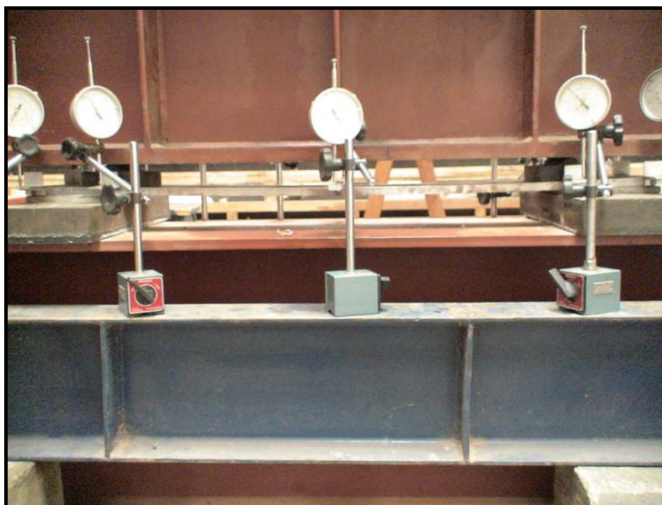
Figura 4.24: Relógios com bases magnéticas posicionados sobre base metálica.
