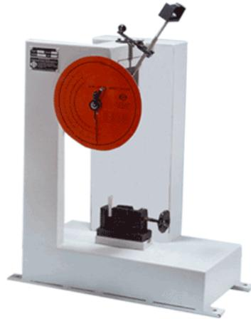
**Figura 3.7** - Equipamento utilizado para ensaio de impacto.
