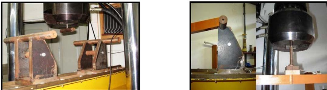
**Figura 8.5** – Dispositivo utilizado no ensaio de flexão de cruzetas poliméricas.
