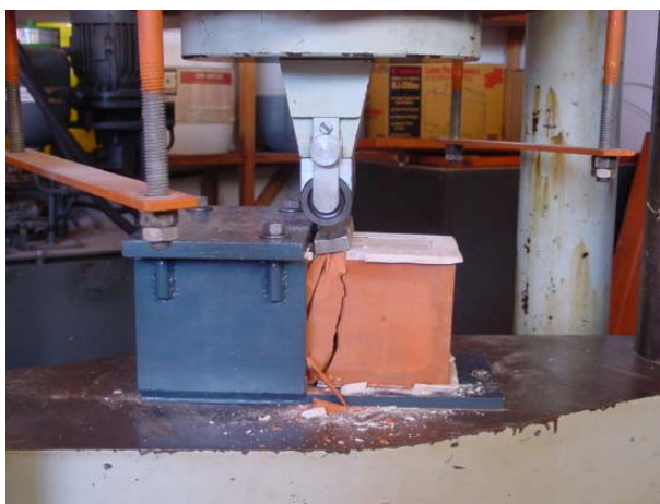
b) Aplicação do sistema rotulado
