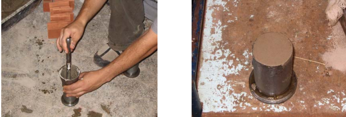
Figura 4.4 – Corpo-de-prova da argamassa de assentamento
