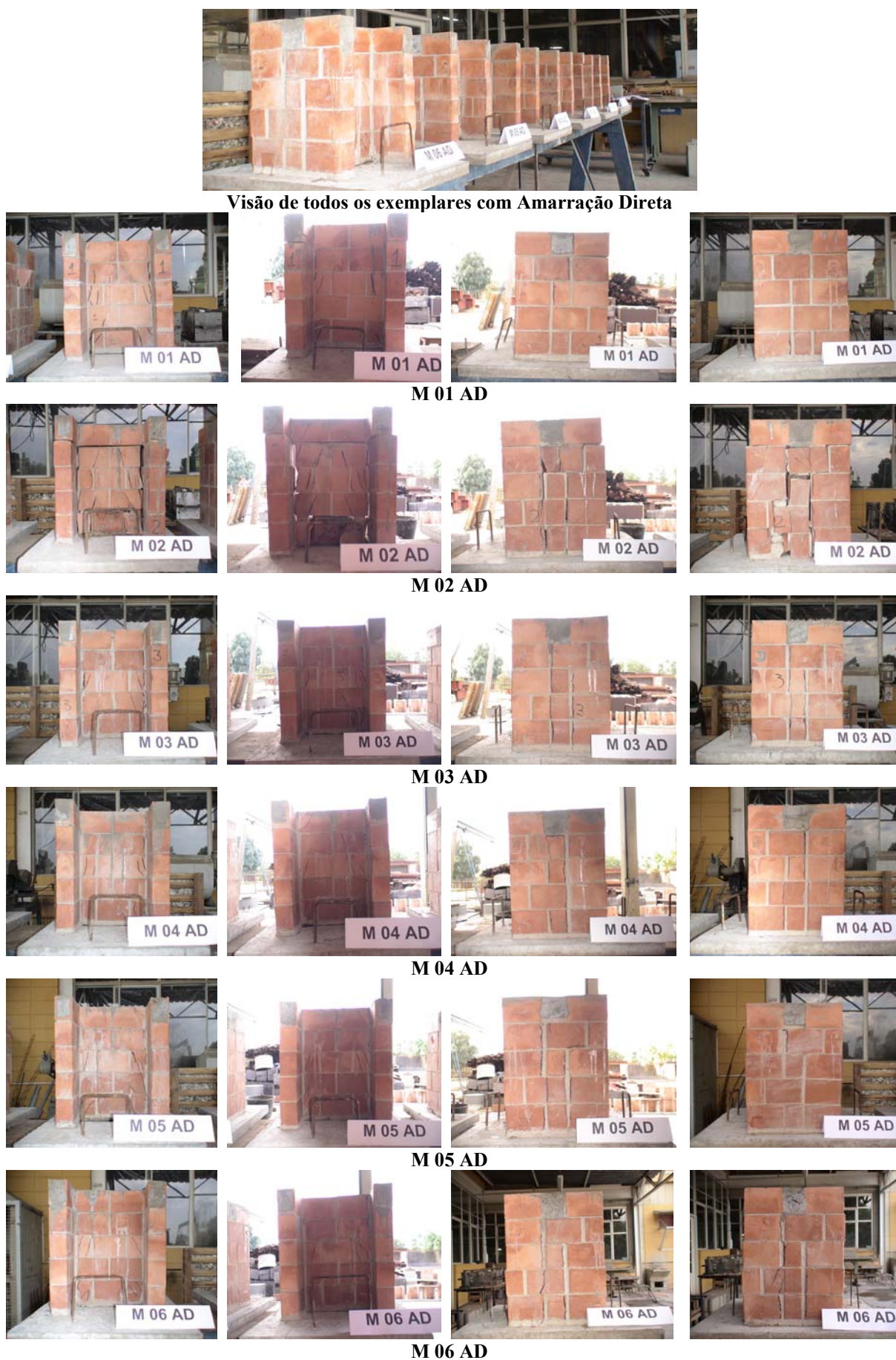
Figura 5.1 – Fotos dos modelos com amarração direta após a ruptura
