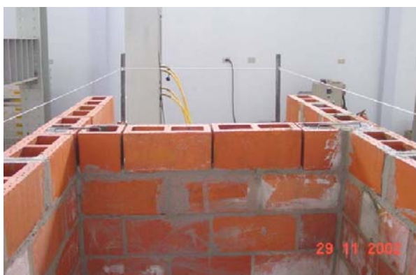
a) Modelo de parede em formato “H”
