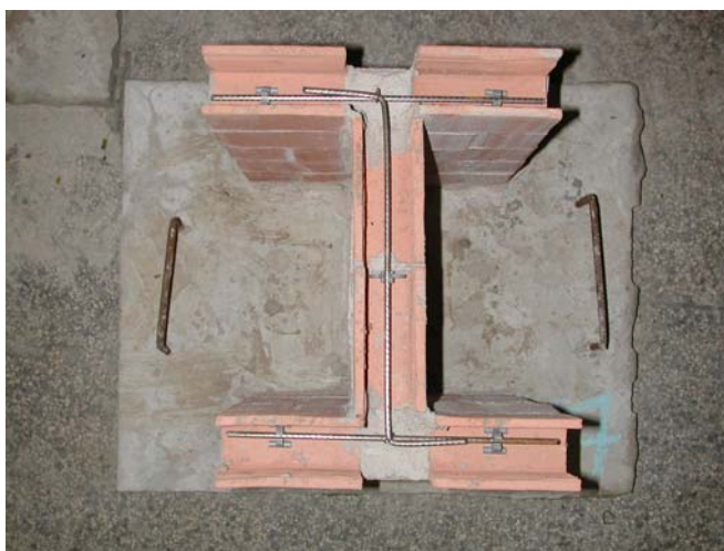
Figura 4.12 – Armação das cintas
