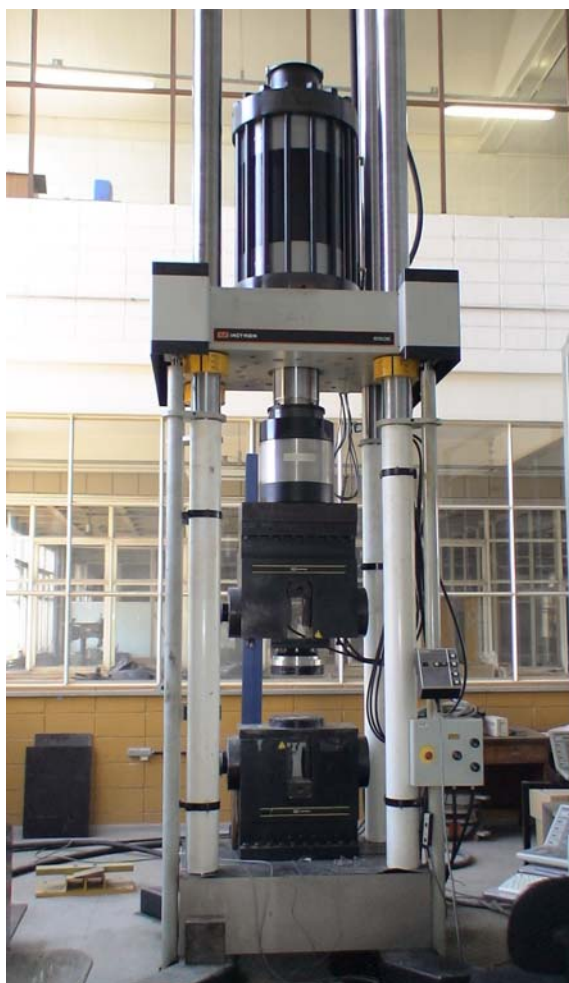
Figura 4.17 – Pórtico de reação e atuador hidráulico servo controlado da marca INSTRON
