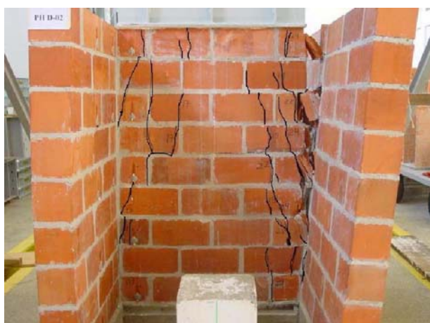
a) Detalhe das fissuras no modelo após a ruptura
