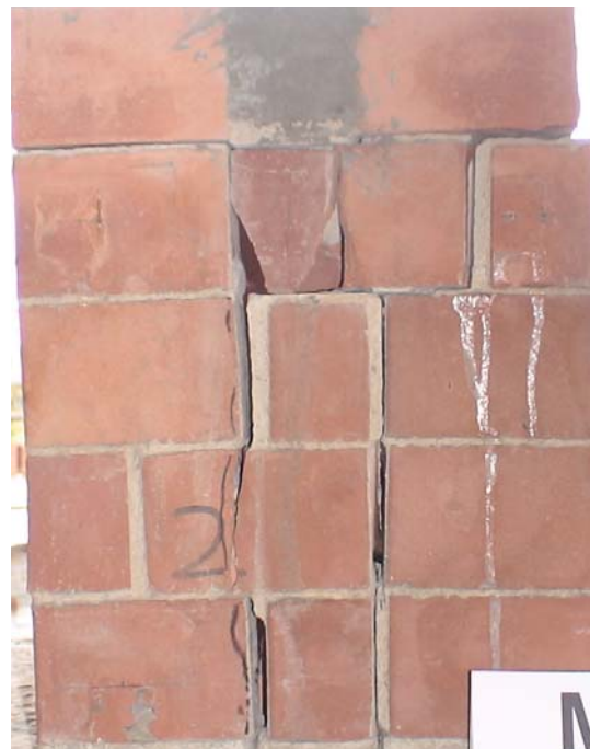
b) Modelo após ruína no modelo M 02 AD
