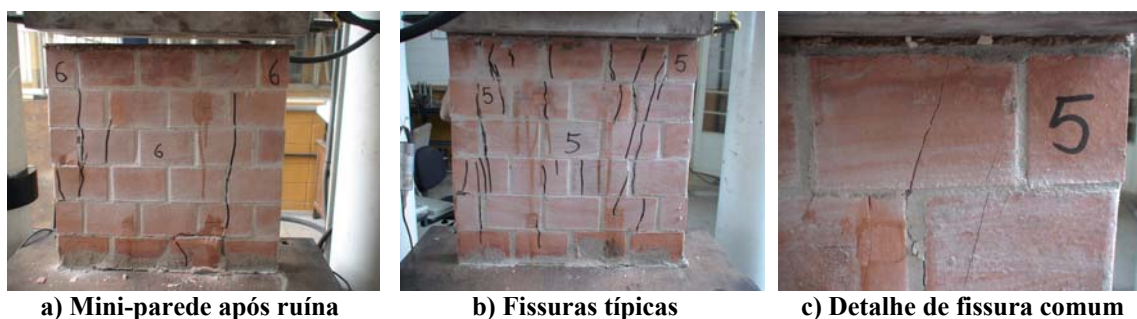
Figura 3.8 – Mini-paredes após a ruína
