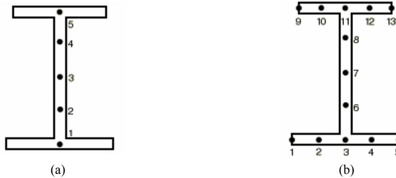
Figura 3.3 – Pontos de integração da seção transversal: (a) elemento plano e (b) tridimensional.
