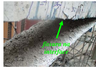
a) fissuração na região central e no vão de cisalhamento na ruína da viga V2C
