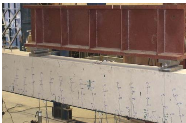
a) aspecto da viga na ruína
