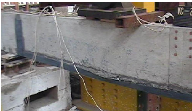
Figura 3.27 – Aspecto geral da lateral da viga e detalhe do descolamento do reforço
