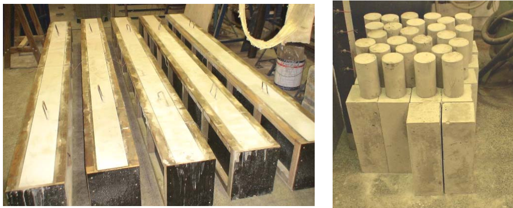
Figura 7.5 – Vigas e prismas armazenados
