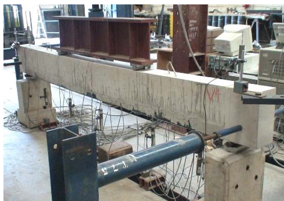
a) aspecto da viga na ruína
