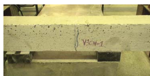
Figura 6.20 – Modo de ruína das vigas com a_v/h = 4,2
