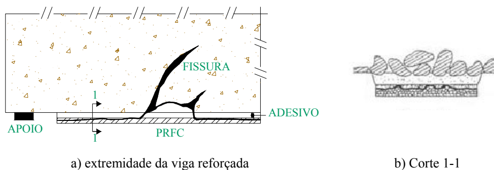
Figura 3.24 – Ilustração da ruptura interlaminar do reforço (adaptado de NEUBAUER & ROSTÁSY, 1997)
