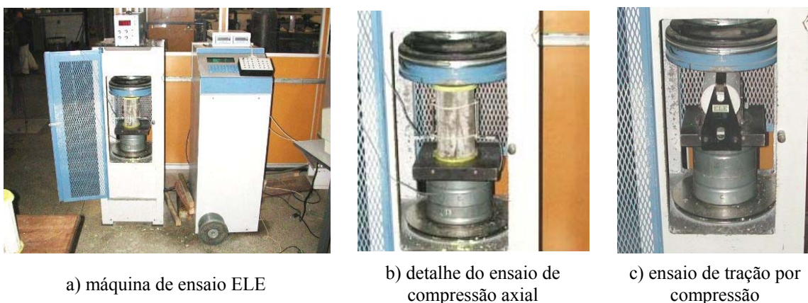
Figura 5.9 – Ensaio de caracterização dos compósitos à compressão
