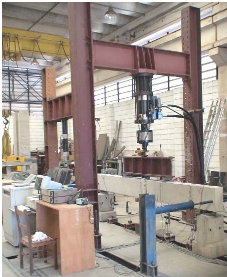
Figura 7.21 – Esquema geral do ensaio de flexão nas vigas
