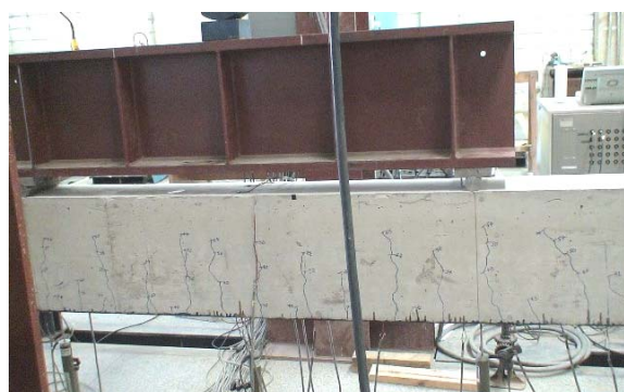
a) aspecto da viga próximo da ruína
