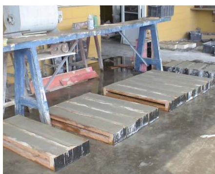
f) vigas após moldagem
