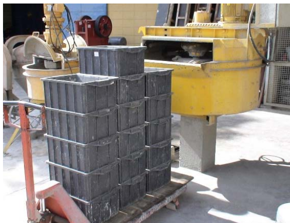
a) materiais devidamente dosados
