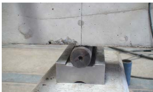
a) dispositivo de apoio
