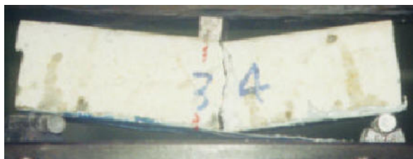
a) manta colada na superfície de concreto
