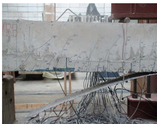
f) ruína da viga
