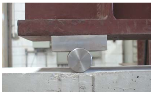
b) dispositivo de aplicação de força
