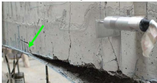
b) fissuração de ruína no substrato de transição
