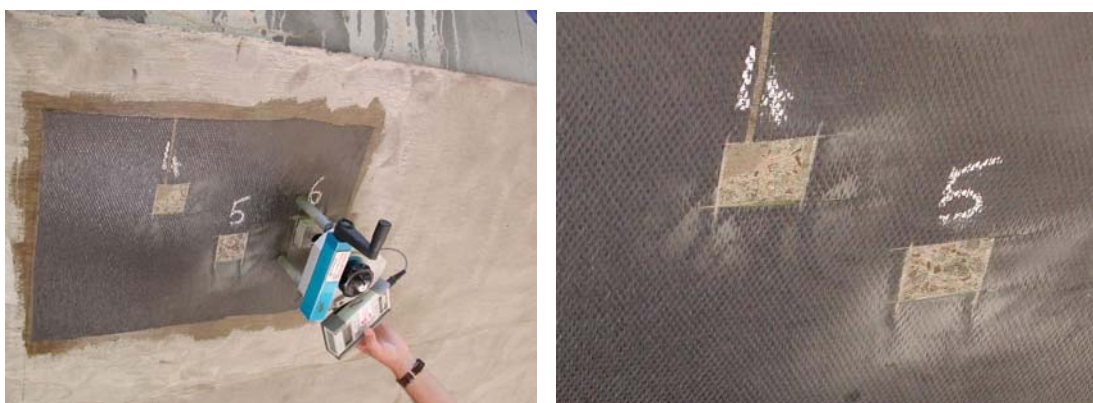
a) teste de resistência da ligação
