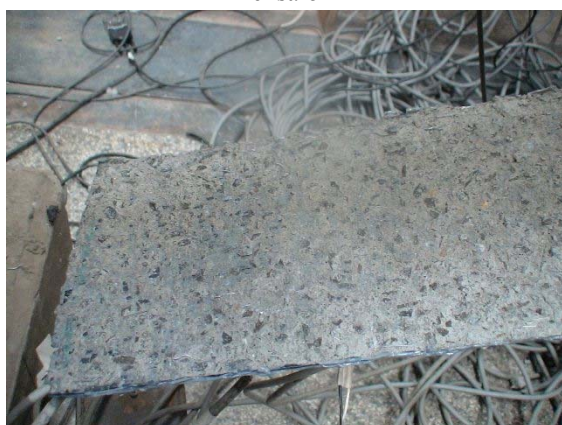
e) microconcreto aderido à manta
