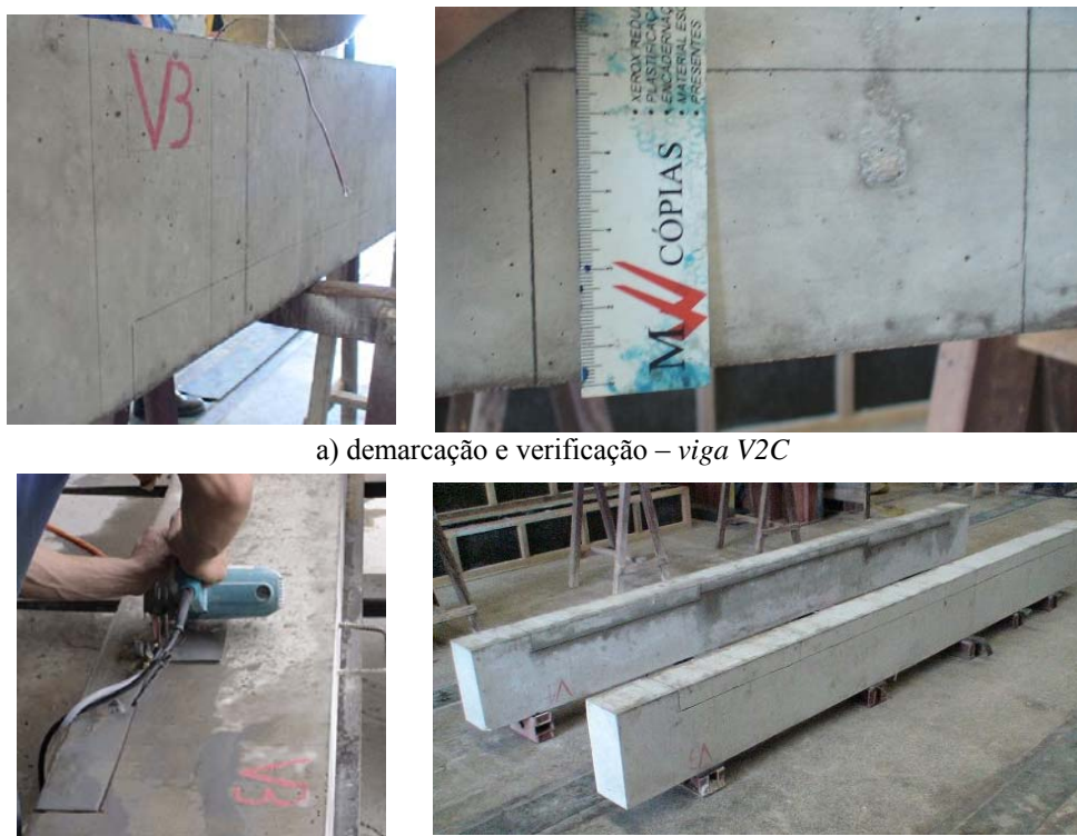
b) delimitação da região com disco de corte
