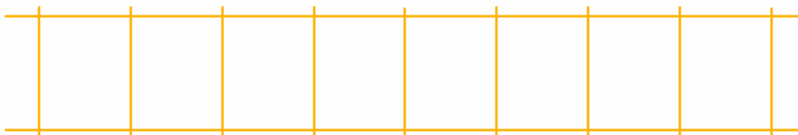
b) armadura inferior, superior e estribos
