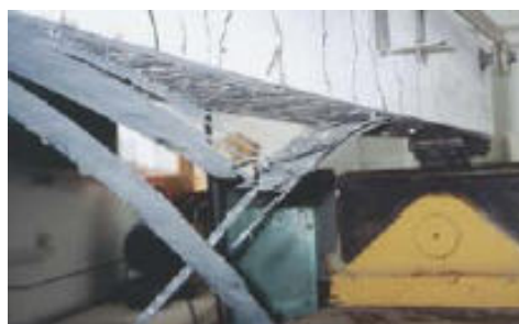
b) ruptura do reforço por tração
