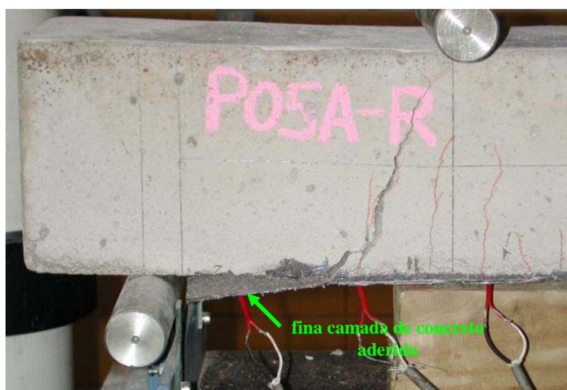
Figura 3.21 – Ruína de viga reforçada por descolamento
