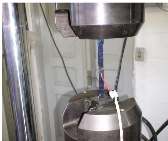
a) detalhe do ensaio de tração uniaxial
