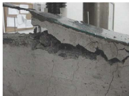
b) arrancamento do concreto (BEBER, 2003)
