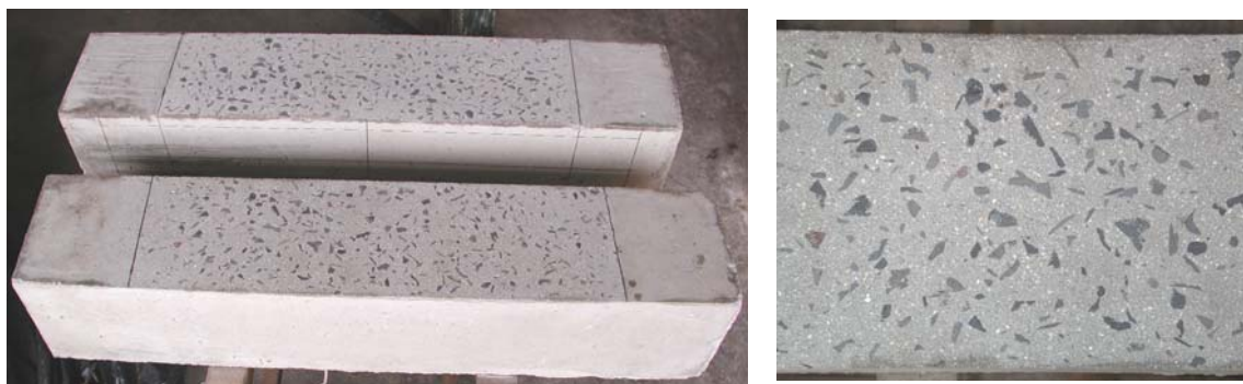
Figura 4.3 – Aspecto do substrato após a retirada da camada de nata de cimento
