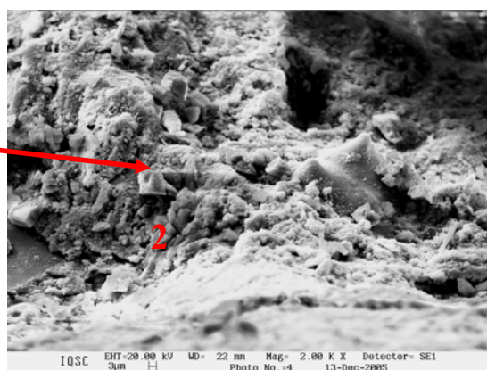
Figura 6.94 – Frente de carbonatação em fissura, viga 2.
