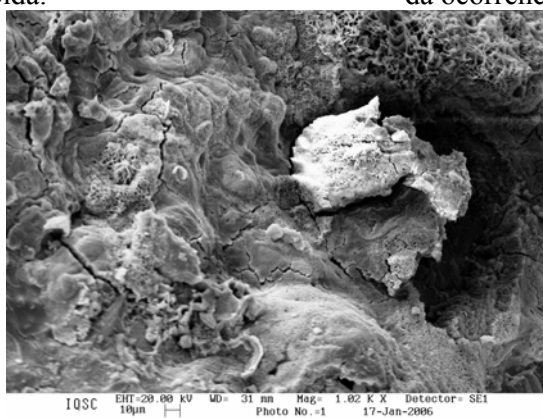
Figura 6.122 – Imagem da barra de aço corroída.
