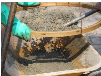
Figura 5.1 – Separação da argamassa (por peneiramento) do concreto utilizado na moldagem das vigas em escala reduzida.
