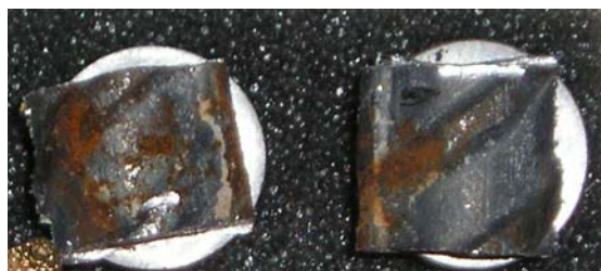
Figura 6.116 – Amostra da barra de aço que foi despassivada devido à carbonatação e sua corrosão.
