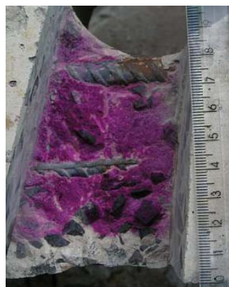
Figura 6.50 – Profundidade da frente de carbonatação medida ao longo de todo o comprimento da fissura e na espessura de 3,0 cm de cobertura, para as vigas 1, 2 e 3.
