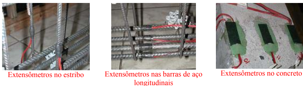
Figura 5.7 – Detalhamento da instrumentação do concreto e da armadura referentes às vigas em escala natural.
