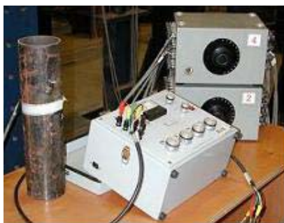
Figura 5.13 – Sistema utilizado para realizar as leituras de carga e deformação.
