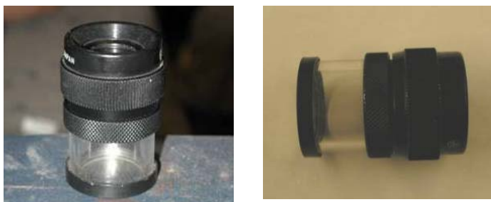
Figura C.2 – Lupa graduada Mitutoyo para a determinação da abertura das fissuras.
