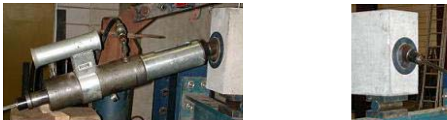
Figura 5.11 – Detalhe do encunhamento da cordoalha de aço de protensão e macaco de aplicação de carregamento.
