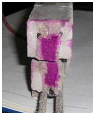
Figura 5.20 – Verificação da profundidade de carbonatação nas vigas em escala reduzida.
