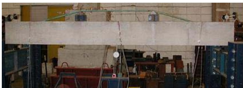
Figura 5.9 – Aplicação do carregamento em uma viga de concreto armado em escala natural.
