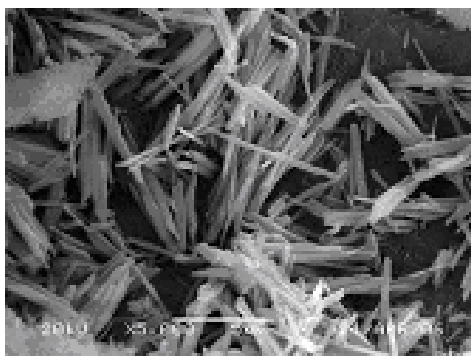
Figura 2.11 – Microestrutura da aragonita.
