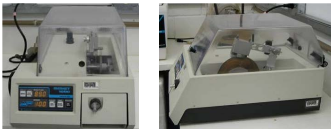
Figura C.8 – Corte de amostra para análise microestrutural.
