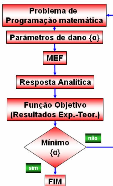
Figura 1. Solução do problema de detecção de dano com insuficiente informação mediante formulação de um problema de otimização.
