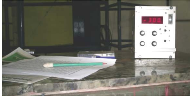
Figura 5.14. Carga máxima aplicada à parede.
