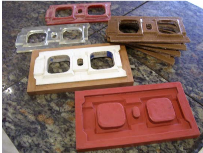
Figura C.11. Molde de silicone para reprodução dos paletes e paletes produzidos com compósito areia – resina acrílica.
