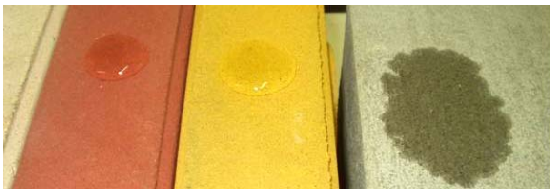
Figura 5.17. Eficiência do aditivo hidrofugante - traço C3.
