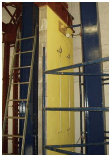
Figura 5.13. Painel de alvenaria preparado para prova de carga.
