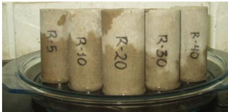
Figura 5.20. Ascensão capilar em corpos-de-prova moldados com diferentes energias de compactação.
