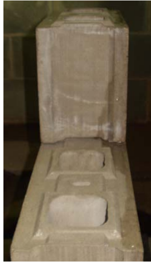
Figura 5.25. Passagem de água pela junta horizontal dos blocos das 2ª e 3ª fiada do corpo-de-prova.
