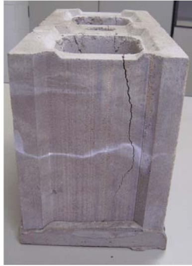
Figura 5.8. Modo de ruptura do prisma assentado a seco.
