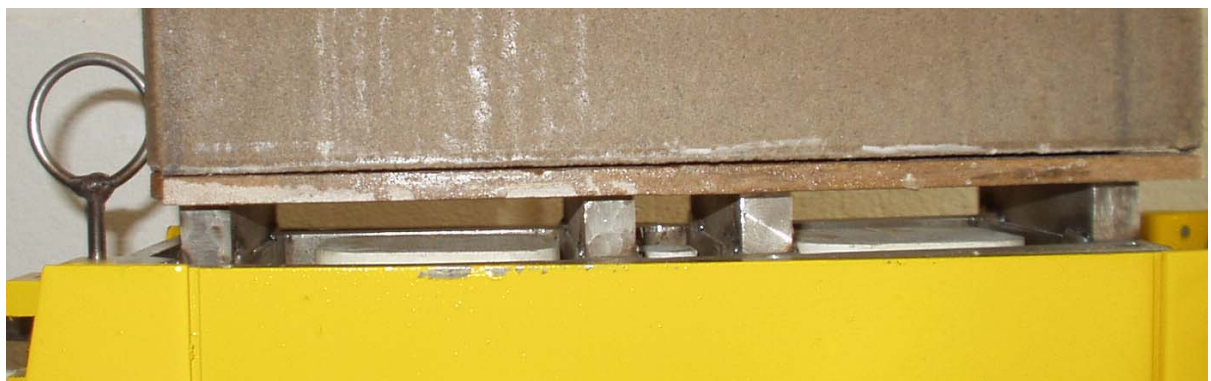
Figura C.12. Saliências no topo do martelo para possibilitar retirada do bloco.
