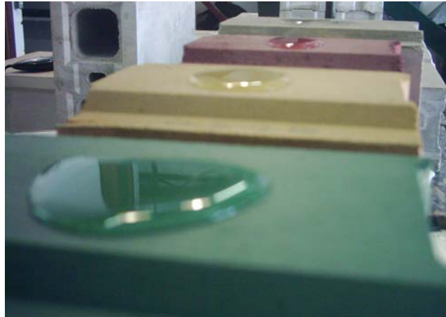
Figura 5.18. Protótipos protegidos por impregnação de resina impermeabilizante.
