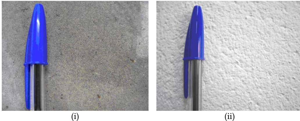
Figura 4.13. Comparação entre a textura ideal obtida (i) e de um bloco de concreto usual (ii).
