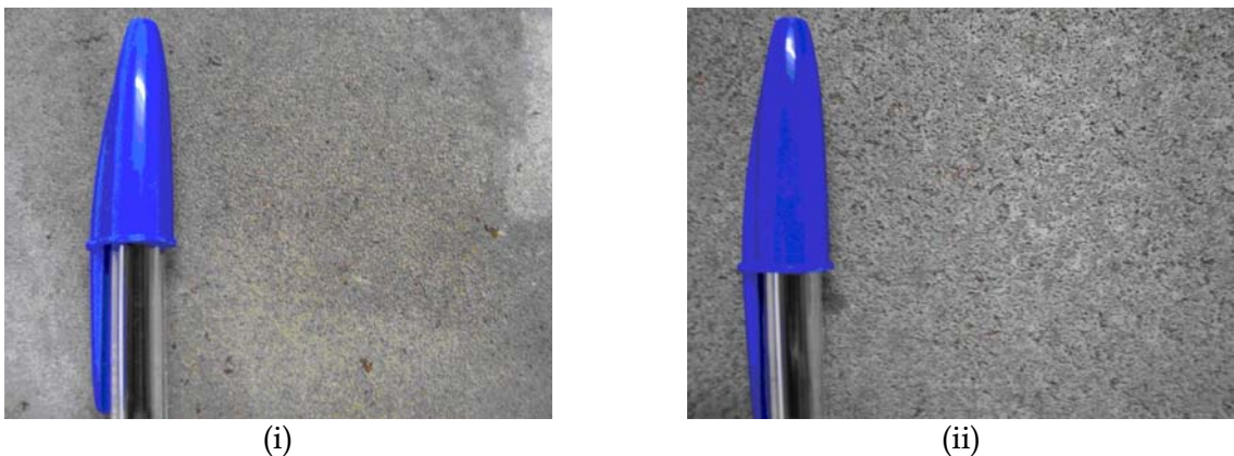
Figura 4.12. Textura ideal para fabricação dos blocos (i) e textura com excesso de partículas grossas.
