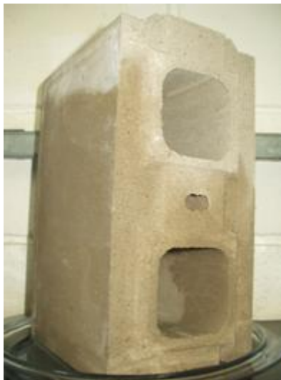
Figura 5.19. Penetração de água por ascensão capilar no protótipo.
