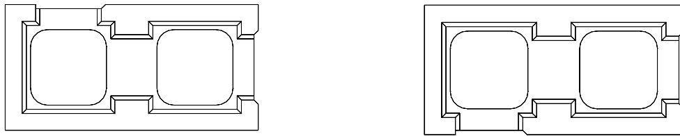
Figura 6.3. Unidades especiais para encontros de parede em "L", em planta. "L1" e "L2", respectivamente.
