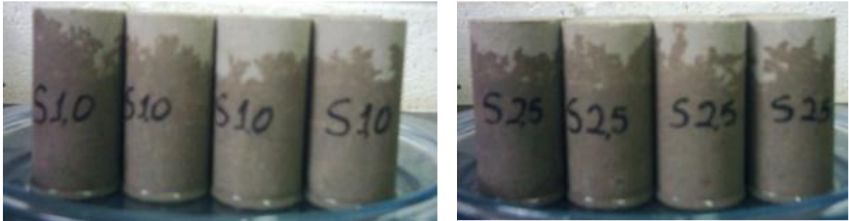
Figura 5.23. Ascensão capilar em corpos-de-prova com adições de 1% (i) e 2,5% (ii) de aditivo à base de sais de sódio.
