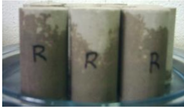
Figura 5.21. Ascensão capilar em corpos-de-prova de referência após 24 horas.
