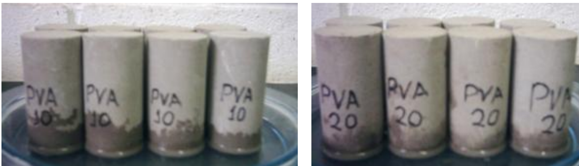
Figura 5.22. Ascensão capilar em corpos-de-prova com adições de 10% (i) e 20% (ii) de PVA.
