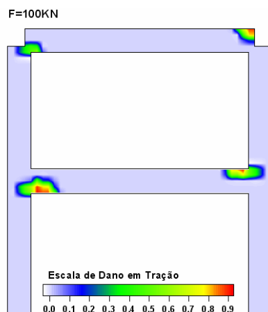
Figura 6.55 – Pórtico de Vecchio & Emara, engatado F=100kN, dano em tração
