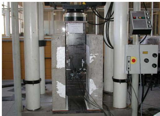
FIGURA 3.10 – Ensaio de cisalhamento direto
