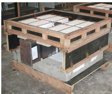
FIGURA 3.7 - Sequência da concretagem dos corpos-de-prova de cisalhamento direto
