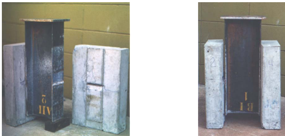
FIGURA 2.24 - Falha no conector e falha no concreto. Fonte: MALITE (1993)
