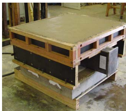
FIGURA 3.7 - Sequência da concretagem dos corpos-de-prova de cisalhamento direto
