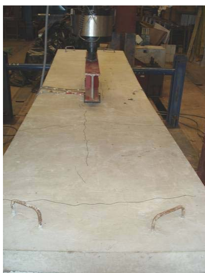
FIGURA 5.14 - Aspecto final da laje sem armadura transversal adicional - VM1
