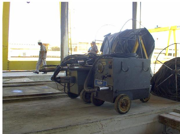
Figura AP-D-14 – Macaco hidráulico
