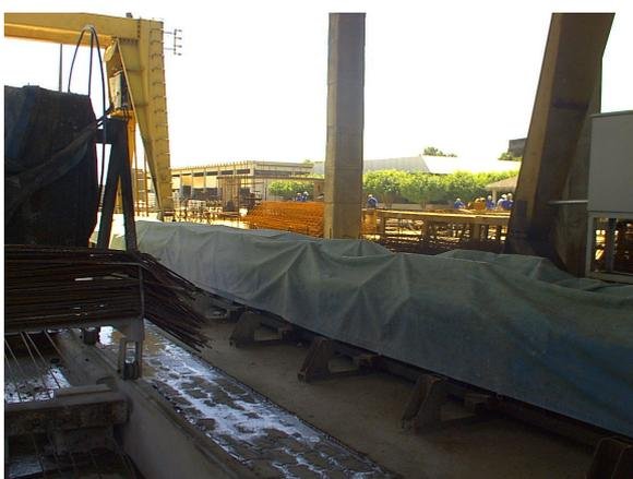
Figura AP-D-5 – Peça sendo curada
