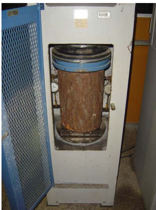
Figura 11 – Ensaio de compressão paralela às fibras em elemento estrutural de Pinus
