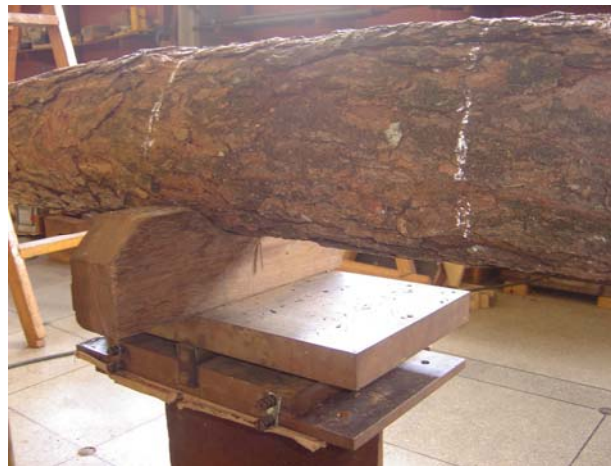
Figura 16 – Detalhe de suporte de elemento estrutural em ensaio de flexão
