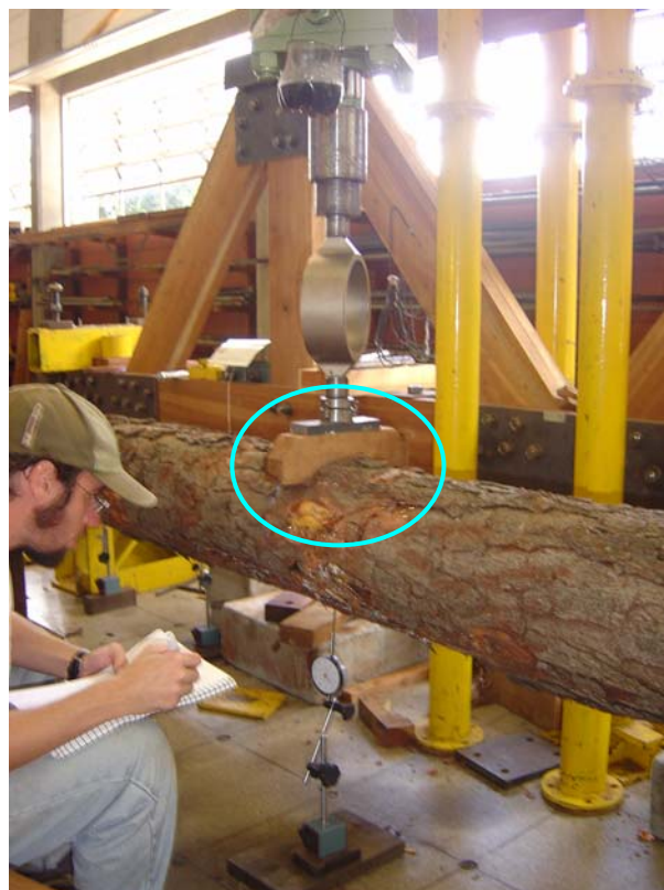
Figura 9 – Ensaio de flexão estática em viga de Pinus
