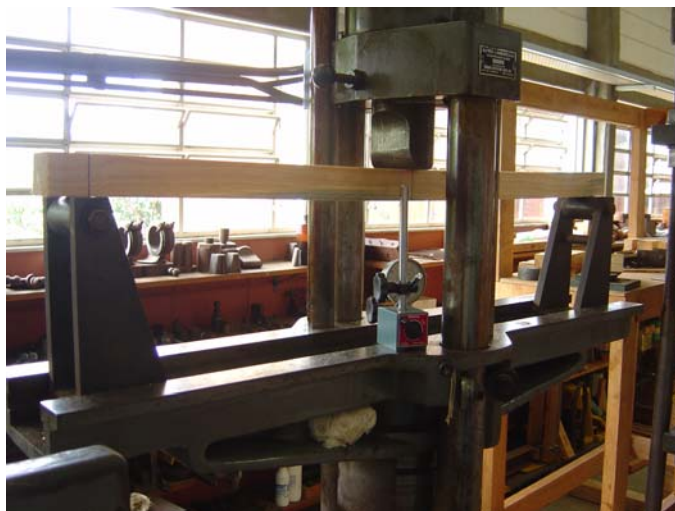
Figura 14 – Ensaio de flexão estática em corpo-de-prova de dimensões reduzidas
