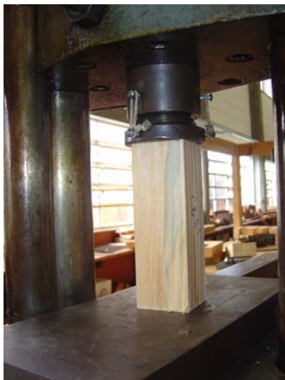
Figura 15 – Ensaio de resistência à compressão paralela às fibras
