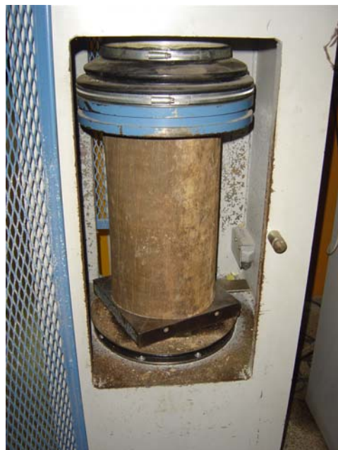
Figura 12 – Peça de eucalipto submetida à compressão
