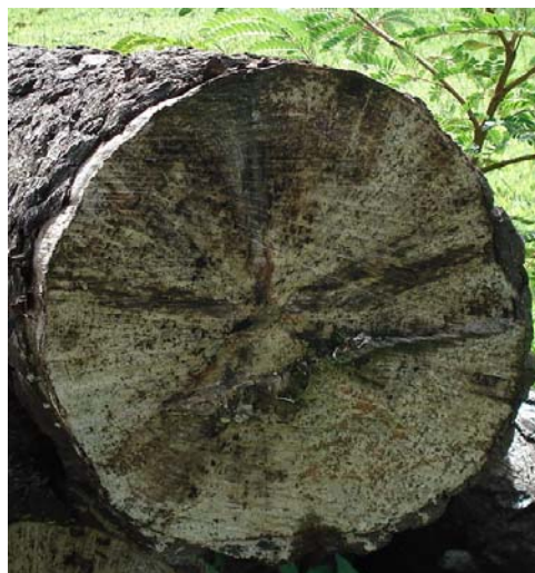
Figura 18 – Peça roliça estrutural de madeira do gênero Pinus .
