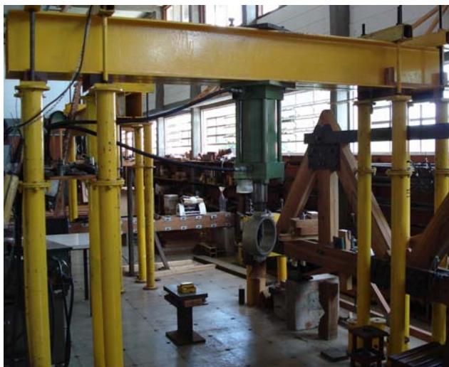
Figura 24 – Pórtico utilizado para a realização dos ensaios de flexão.
