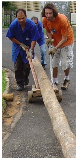
Figura 22 – Condução da peça roliça de madeira ao trilho de suspensão.
