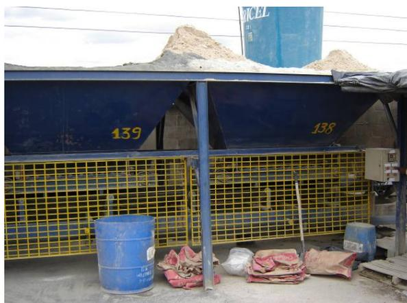
Figura 7.31 – Silos para estoque dos agregados.
