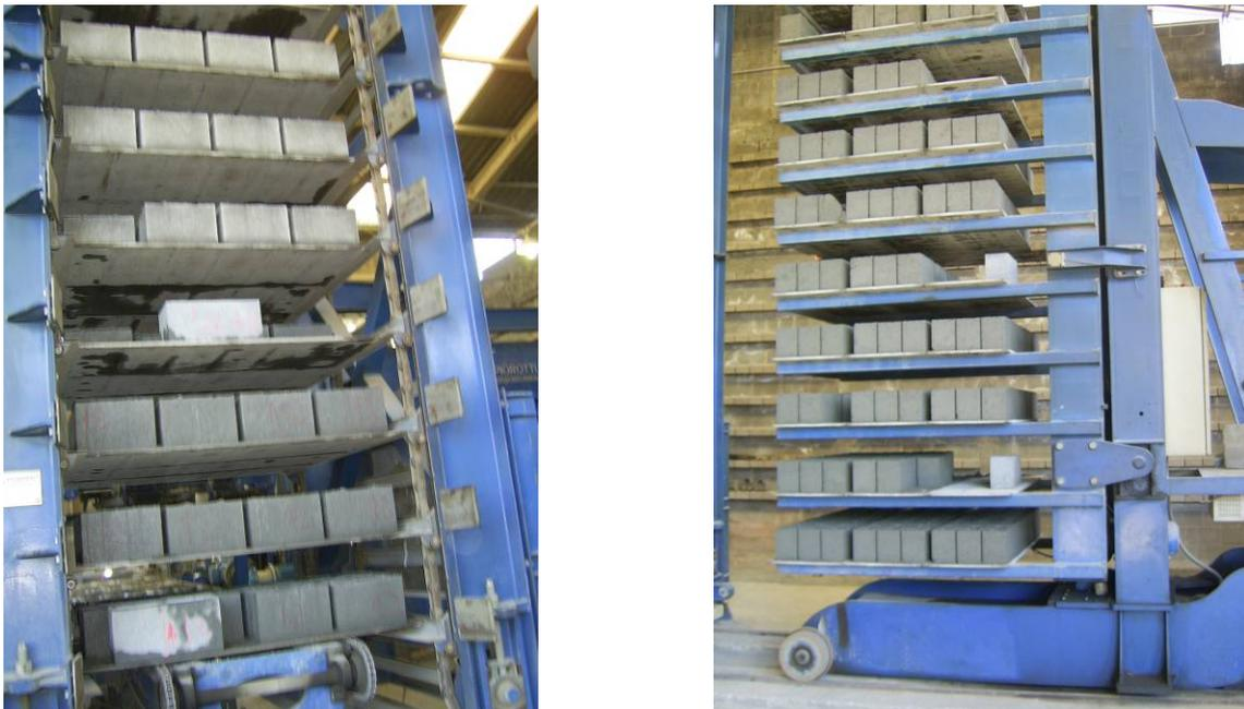
Figura 7.10 – Carro de transporte dos blocos.
