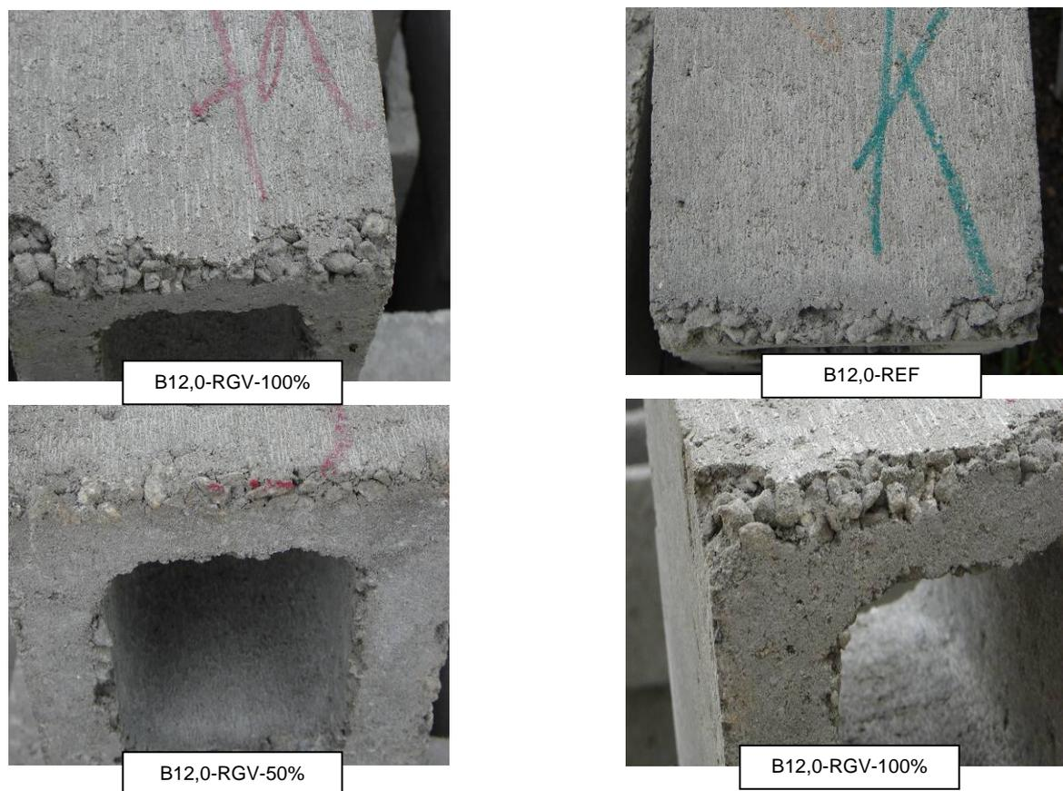
Figura 7.18 – Defeitos na face inferior de algumas unidades dos traços B12,0-REF, B12,0-RGV-100% e B12,0-RGV-50%.
