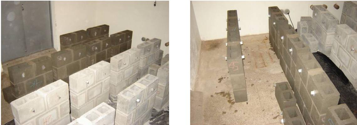
Figura 9.17 – Miniparedes do Grupo 8,0 dispostas na câmara climatizada.
