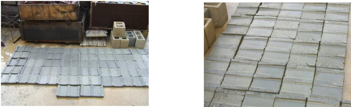
Figura 9.4 – Corpos-de-prova de blocos (prismas).
