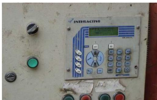
Figura 7.36 – Painel de ajuste dos tempos de produção.
