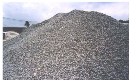
Figura 2.15 – Estoque de agregados reciclados (brita 1 e brita 2) (foto do autor).
