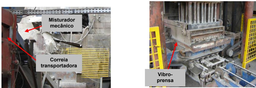
Figura 7.35 – Equipamentos utilizados na produção dos blocos.
