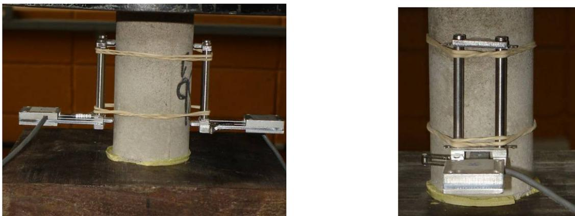
Figura 26 – Instrumentação dos CPs para a realização do ensaio de módulo de deformação.
