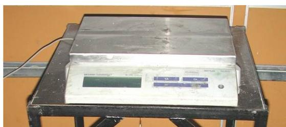
Figura 9.2 – Balança com precisão de 0,1 g.
