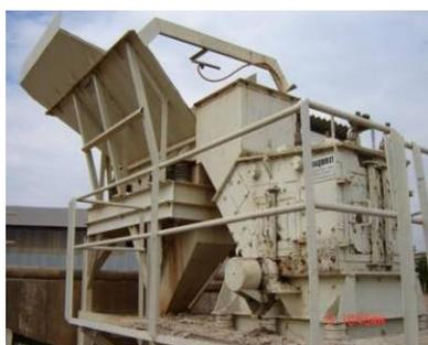
b) alimentador vibratório e britador de martelos
