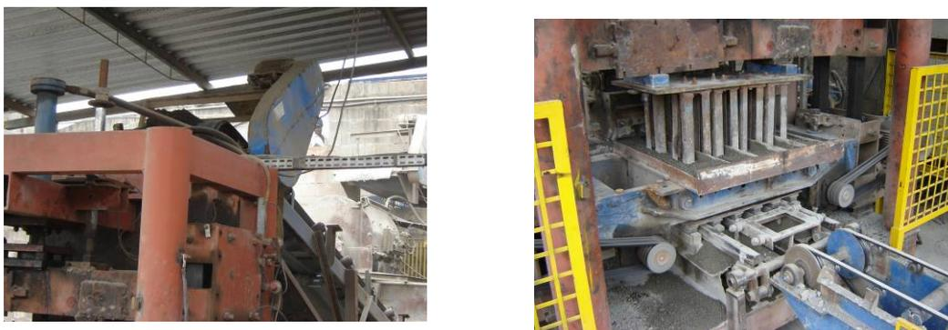
Figura 7.32 – Vibro-prensa utilizada para a produção dos meios-blocos.
