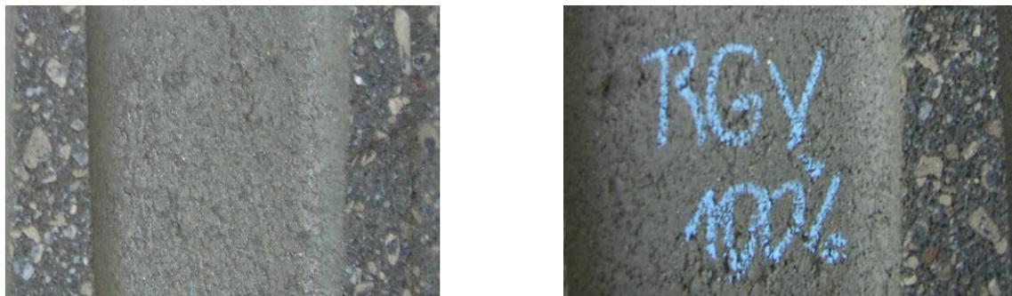
Figura 7.16 – Presença dos agregados reciclados no traço B4,5-RGV-100%.
