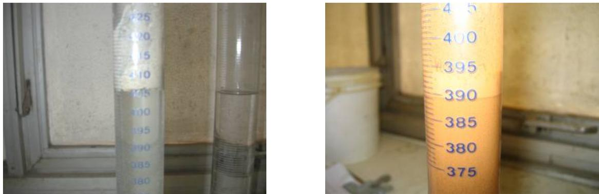
Figura 5.10 – Ensaio de massa específica pelo Frasco de Chapman.
