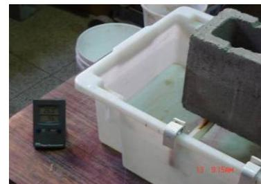
i) registro da temperatura e umidade durante o ensaio
