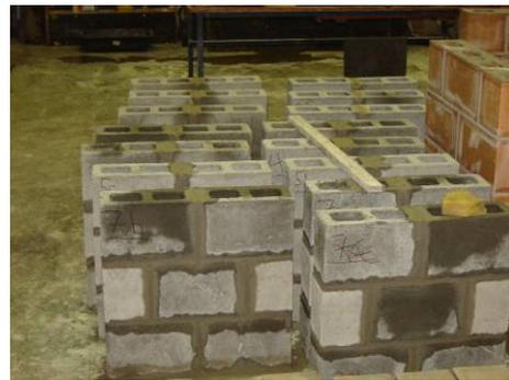
Figura 40 – Vista geral das 27 miniparedes produzidas.
