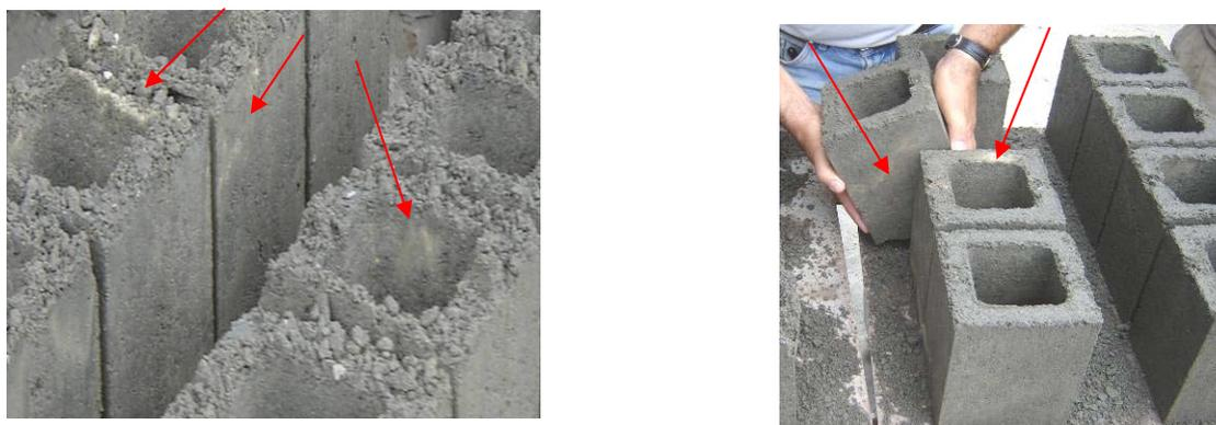
Figura 7.40 – Mistura deficiente dos materiais (MB4,5-REF).
