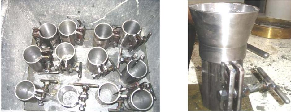
Figura 5 – Fôrmas metálicas para a produção dos CPs.
