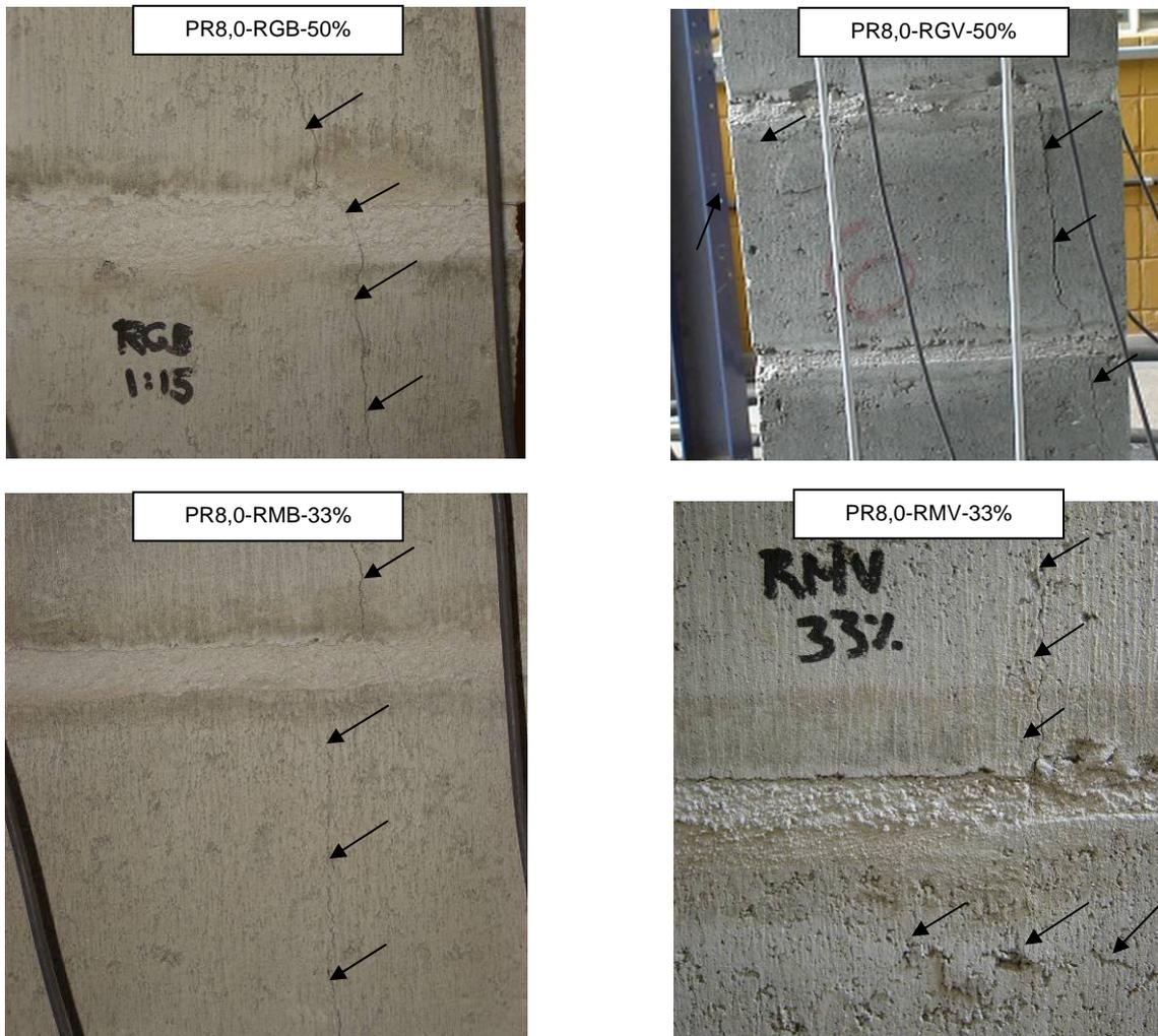
Figura 8.7 – Ruptura típica dos prismas do grupo 8,0.
