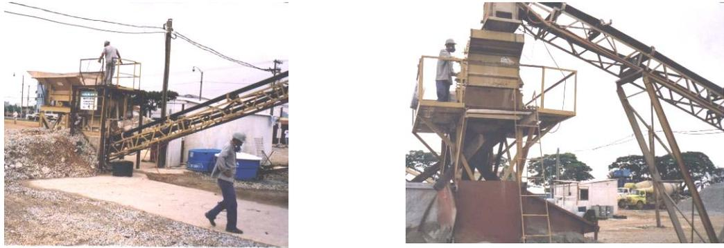
Figura 2.14 – Processamento dos resíduos de concreto no canteiro de obras (foto do autor).
