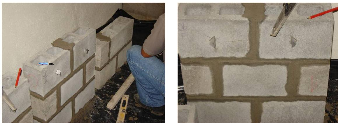
Figura 9.13 – Execução das miniparedes de retração.
