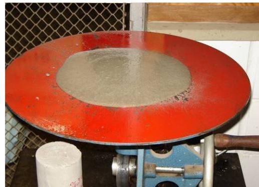
Figura 28 – Ensaio de índice de consistência.
