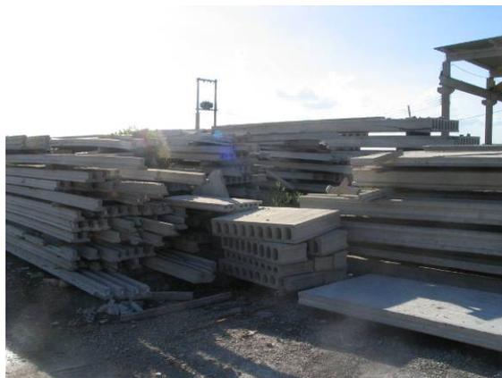
c) resíduos de painéis de lajes pré-moldadas
