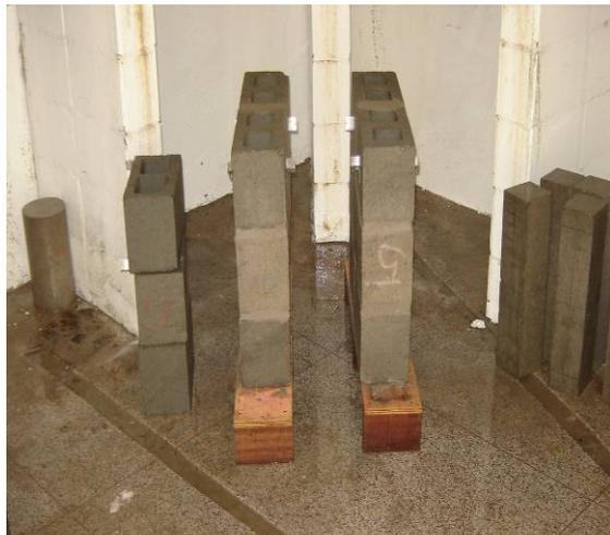
Figura 9.16 – Miniparedes do Grupo 8,0 dispostas na câmara úmida.
