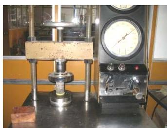
a) Ensaio de compressão na máquina Soiltest
