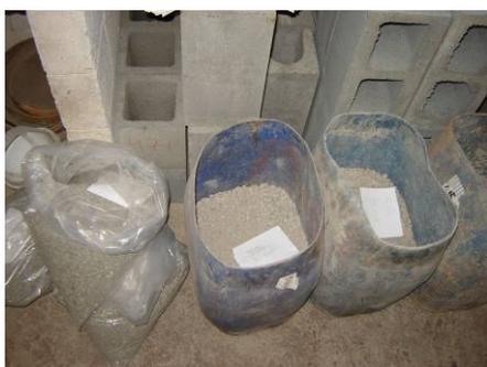
a) separação dos agregados reciclados para produção dos seis traços
