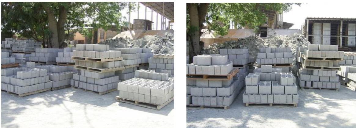
Figura 7.12 – Estocagem dos blocos no pátio da fábrica.
