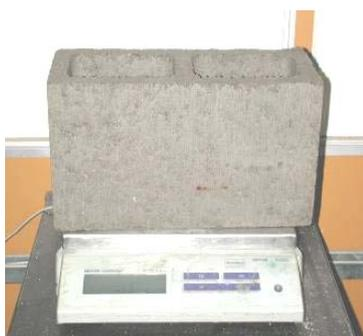
b) Pesagem dos blocos na balança
