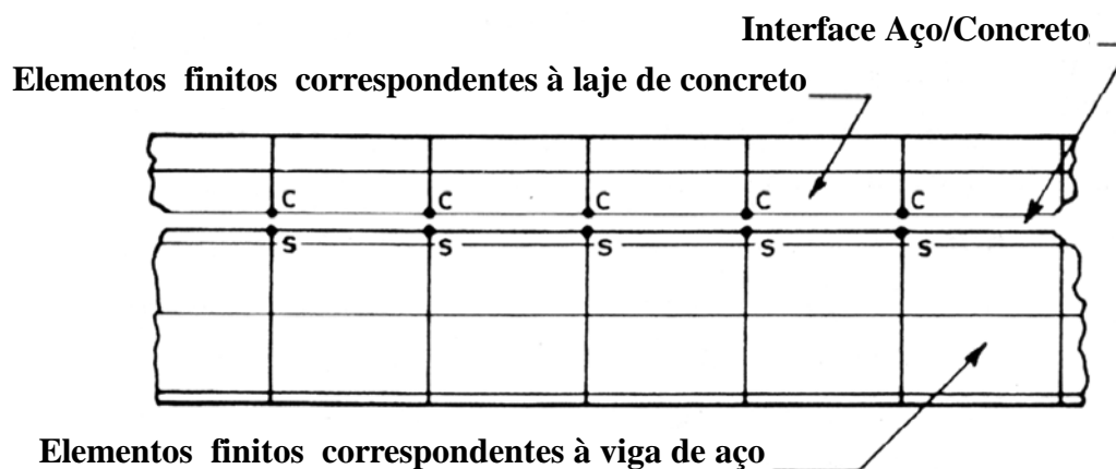
Figura 2.8 – Modelo em Elementos Finitos proposto em Hirst e Yeo (1979).
